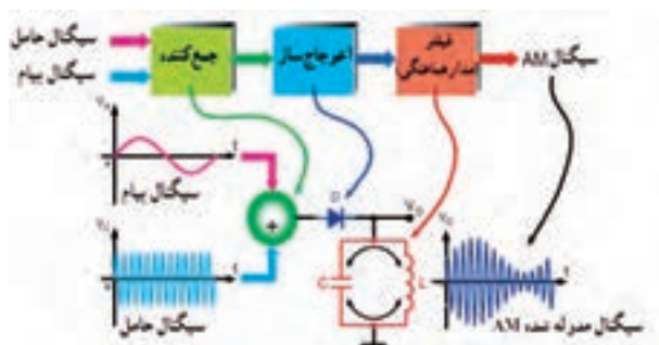
شکل ۵-۱-۱ بلوک دیاگرام مدولاتور دیودی AM
