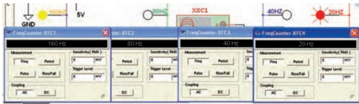
شکل ۲۰-۴ اندازه گیری فرکانس پالس ساعت ورودی و فرکانس های خروجی فلیپ فلاپ های مدار شکل ۱۸-۴ با استفاده از فرکانس متر
