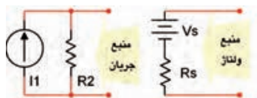
شکل ۱-۱۷ تبدیل منبع ولتاژ به منبع جریان
