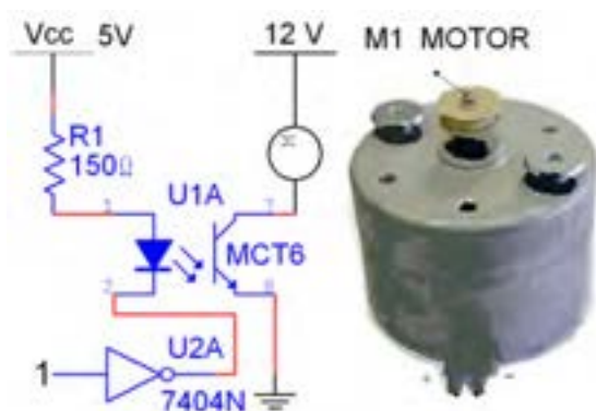
شکل ۷-۲۰ کاربرد جدا ساز نوری برای راه اندازی یک مصرف کننده پرمات
