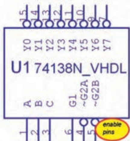
شکل ۳-۲۴ آی سی ۷۴۱۳۸ یک رمزگشای ۳ به ۸
