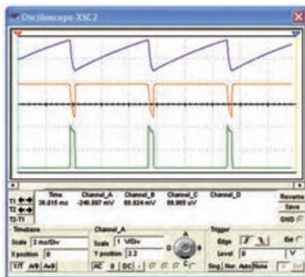
شکل ۲۳-۸ شکل موج‌های تولید شده مدار نوسان‌ساز PUT
