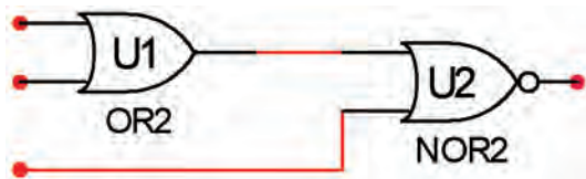
شکل ۲-۴۷ گیت NOR با سه ورودی
