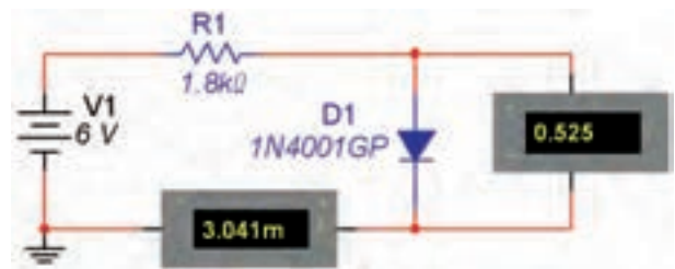
شکل ۱-۳ بایاس مستقیم دیود برای محاسبه‌ی مقاومت استاتیکی و دینامیکی دیود
