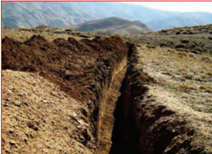
شکل ۱۴-۴ الف) نمایی از ترانشه‌های حفر شده در جهت عمود بر امتداد گسترش ماده معدنی ب) نمایی از داخل یکی از ترانشه‌های حفر شده [۳۳]
