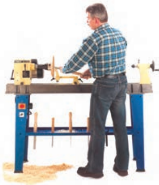
شکل ۵-۱۴- کار با ماشین خراطی پایه‌دار
