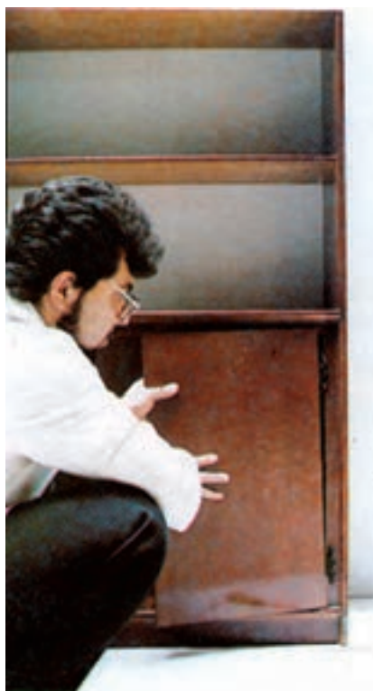
شکل ۸-۱۳- جاسازی و علامت‌گذاری برگه لولای روی کار
