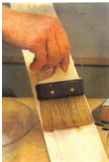
شکل ۱۱-۱۲- نحوه استفاده از قلم‌موی پهن
