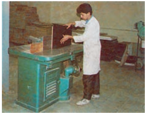
شکل ۴-۲- هنرجوی هنرستان پارس الکترونیک تهران در حال رندیدن قطعه نئوپان برای ساخت کابینت.
