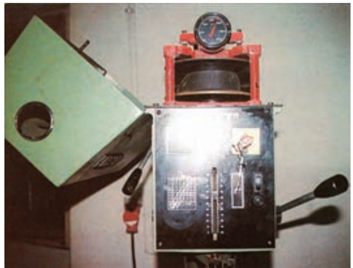
شکل ۹-۲۱- صفحه ساعتی نشان دهنده تعداد دوران محور و جدول دیاگرام
