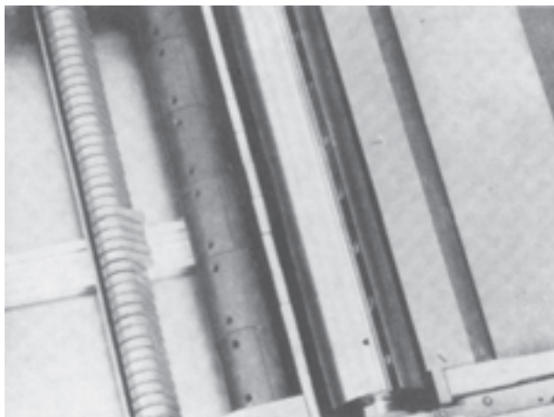
شکل ۸۴-۴ گندگی کردن زوهارهای باریک با ماشین گندگی مجهز به غلتک لاستیکی چندتکه
