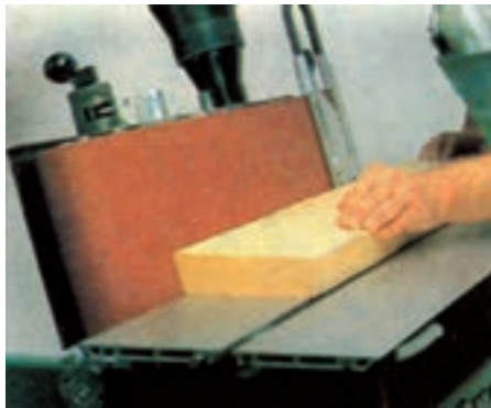
شکل ۵-۱۲- سنبناده زدن نر صفحه با زاویه ۳۰ درجه
