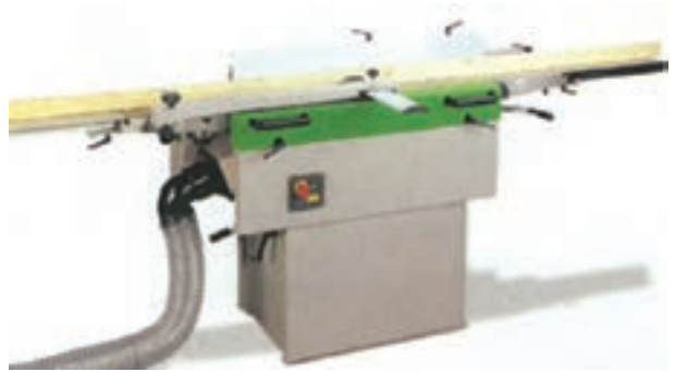
شکل ۴۰-۱- ماشین رنده مجهز به لوله مکنده است.
