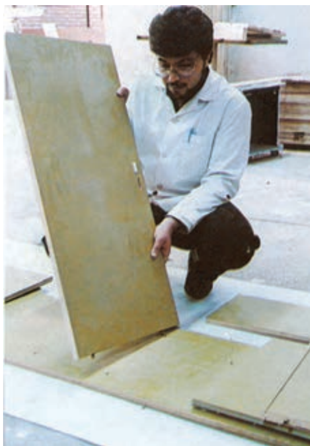
شکل ۴-۱۱- استقرار طبقه روی بدنه کتابخانه
