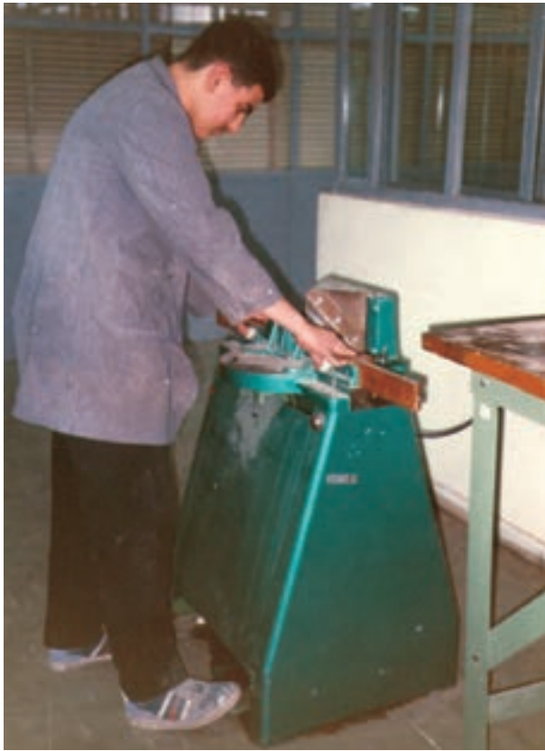
شکل ۴۷-۱- فرمان حرکت اتوماتیک تیغه‌اره (پنوماتیک)
