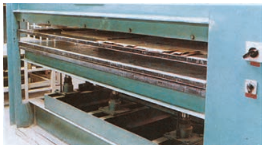
شکل ۲۵-۷- پر کردن یک صفحه پرس با صفحات روکش شده با یک ضخامت
