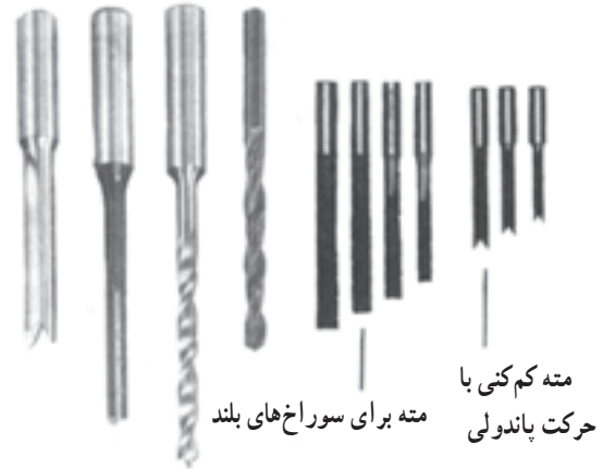
شکل ۹-۱۳- مته های مخصوص چوب با فولاد WS
