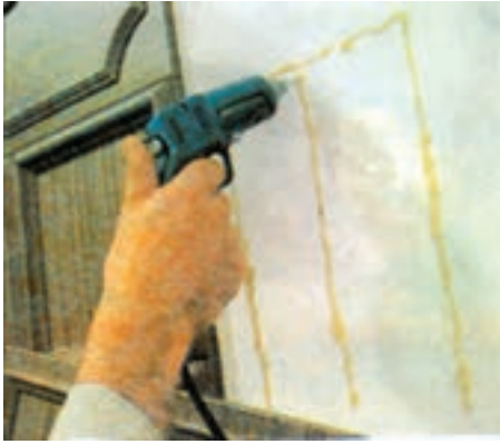
شکل ۱۵-۱۱- نحوه کاربرد پیستوله و چسب گرم در عملیات مونتاژ کاری
