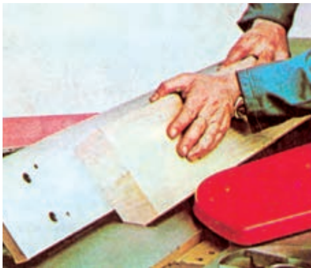
شکل ۴۳-۴- نحوه استقرار دستها در موقع پخ زدن به چوب با ماشین رنده
