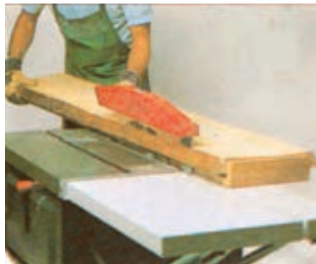
شکل ۳-۴۹- ایجاد برش طولی در لبه صفحات بلند با کمک شابلون مخصوص
