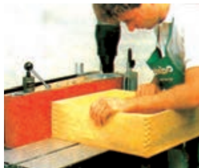
شکل ۶-۱۲- سنباده زدن و پرداخت کردن بدنه جعبه
