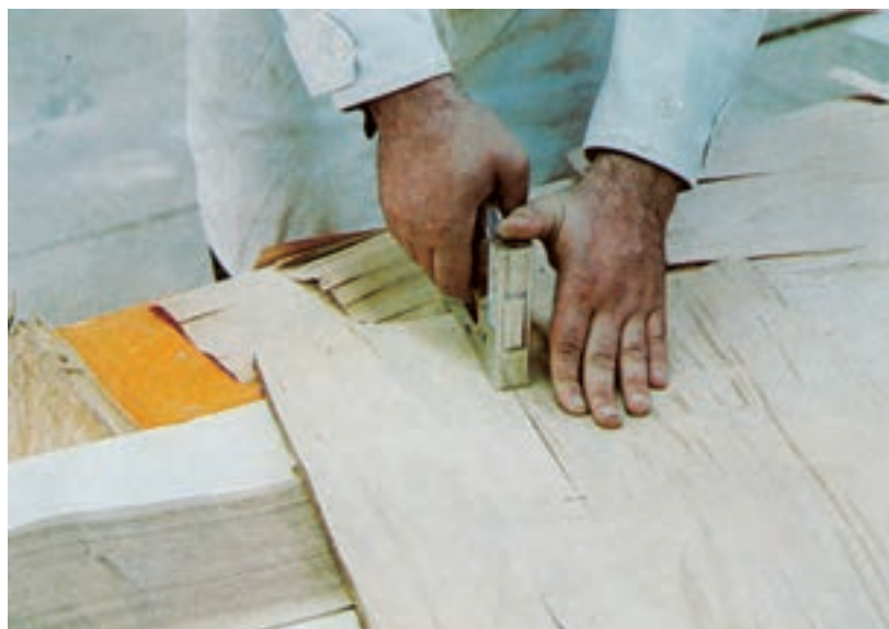
شکل ۱۲-۵- نحوه‌ی استفاده از دستگاه دوخت دستی در به هم دوختن روکش‌های درز شده
