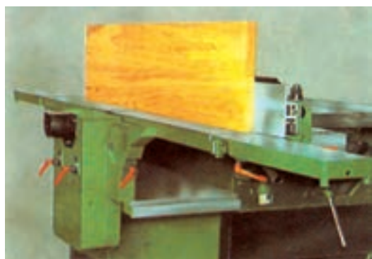
شکل ۲۶-۴- وضعیت چوب پس از تنظیم گونیای ۹۰ درجه.
