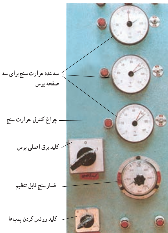
شکل ۷-۲۰- اجزای کنترل و تنظیم پرس
