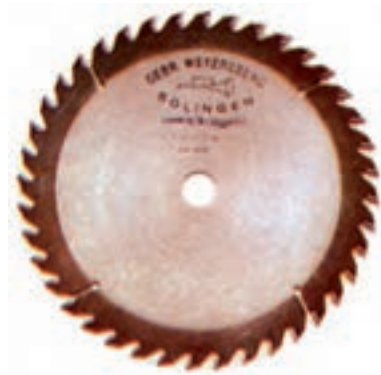
شکل ۱۱-۳- از گرد با دندانه به فرم گرگی
