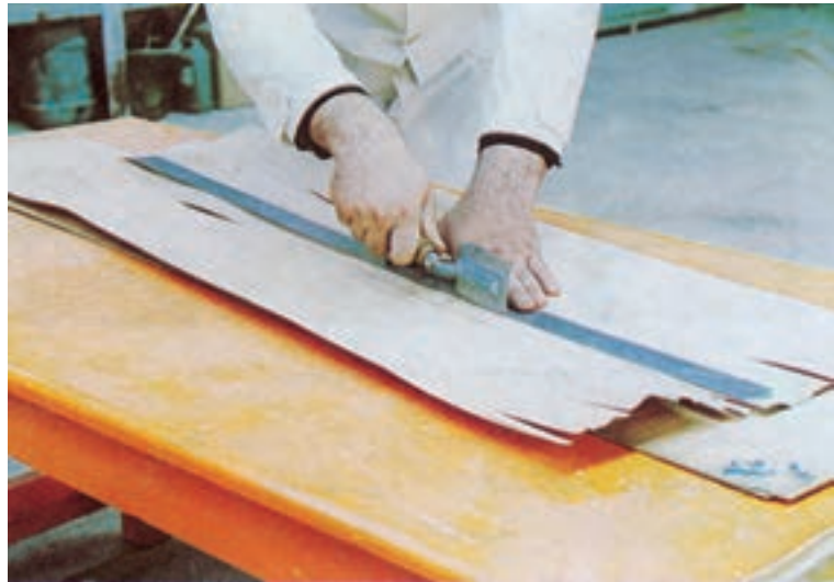
شکل ۵-۶- نحوه‌ی اندازه‌بری طولی روکش‌ها با کمک ستاره و اره روکش‌بری
