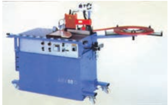
شکل ۳۲-۶ با این ماشین صفحات ساده و قوسدار را لبه‌چسبانی کنید.
