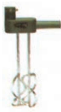
شکل ۹-۷- محور و پروانه مخلوط کردن چسب
