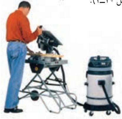
شکل ۲۰-۱- مکنده خاک‌اره موضعی برای هر ماشین
