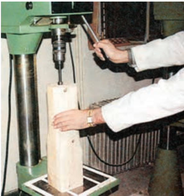
شکل ۹-۵۶- سوراخکاری قطعه بلند عمودی
