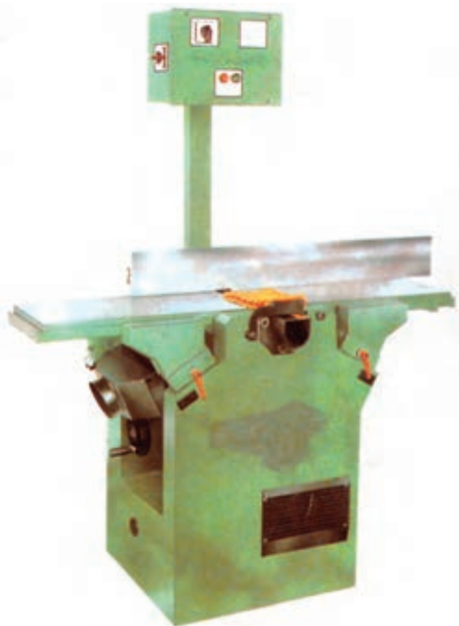
شکل ۴-۳۵- صحت ظاهری ماشین رنده را کنترل کنید.
