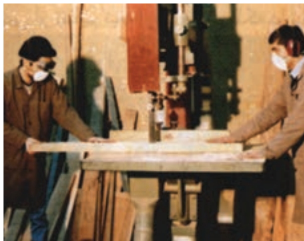
شکل ۶۱-۲- نحوه استقرار جلوی اره در موقع برشکاری با استفاده از گونیا
