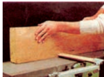
شکل ۴۰-۴- نحوه رندیدن نر صفحات ضخیم با ماشین رنده کوچک
