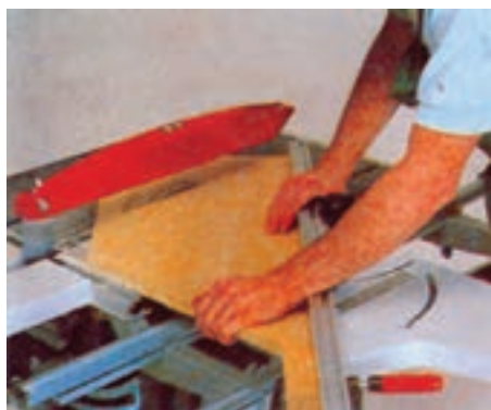
شکل ۴۰-۳- نحوه‌ی زاویه بری صفحات با استفاده از میز کشویی متحرک (ب) کنترل الکتروموتور و نحوه انتقال و محاسبه تعداد دوران تیغه ارّه؛
