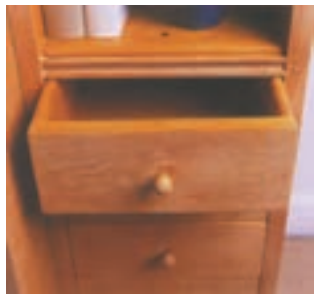
شکل ۹۷-۹ کاربرد دم چلچله یک رو مخفی در ساخت کشو
