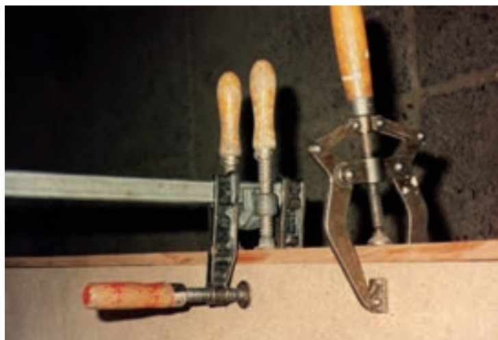
شکل ۱۰-۶- انواع گیره یا پیچ دستی و تنگ
