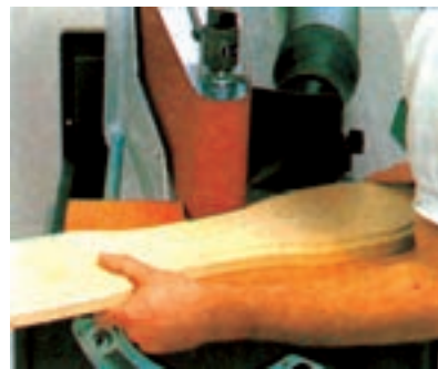
شکل ۷-۱۲- نحوه سنباده زدن قوس‌های مقعر
