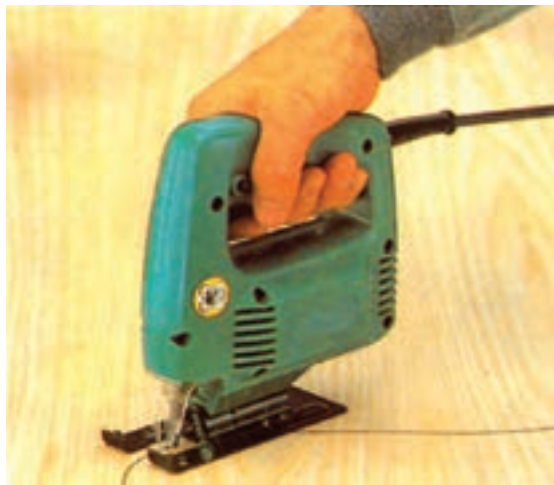
شکل ۲-۱۵- برش صفحات چوبی بدون استفاده از گونیا
