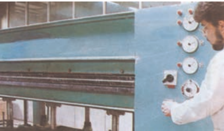
شکل ۲۷-۷- نحوه روشن کردن و تنظیم درجات پرس برای عملیات پرسکاری
