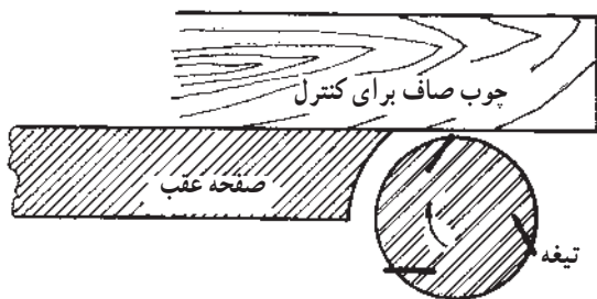
شکل ۷-۴- سطح صفحه کارگیر با لبه تیغه رنده مماس باشد.
