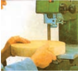
شکل ۲-۶۴- برش دایره با استفاده از اره نواری کوچک
