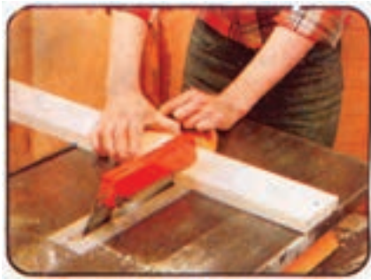
شکل ۳-۶۳- برش عرضی چوب با اژه گرد
