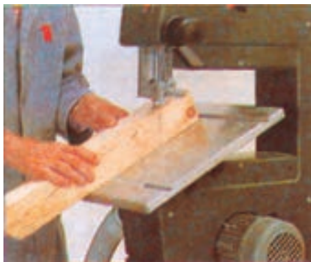
شکل ۲-۷۳- نحوه‌ی برش عرضی و زاویه‌دار چوب
