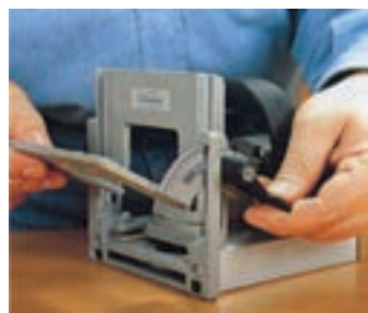
شکل ۹-۱۱۰- نحوه تنظیم زاویه گونیا
