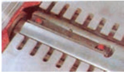
شکل ۴-۳- لبه‌شانه‌ای صفحات ماشین رنده برای تقلیل صدا.
