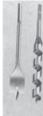
شکل ۹-۱۰ - اندازه مته برگی روی سر آن حک شده
