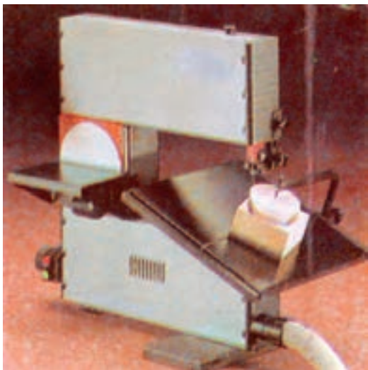
شکل ۲-۶۹ - عمل مخروط‌بری با کمک شابلون پایه‌دار و کج کردن صفحه ماشین اره
