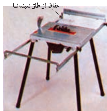
شکل ۳-۳۴ - استفاده از حفاظ پلاستیکی روی تیغه
