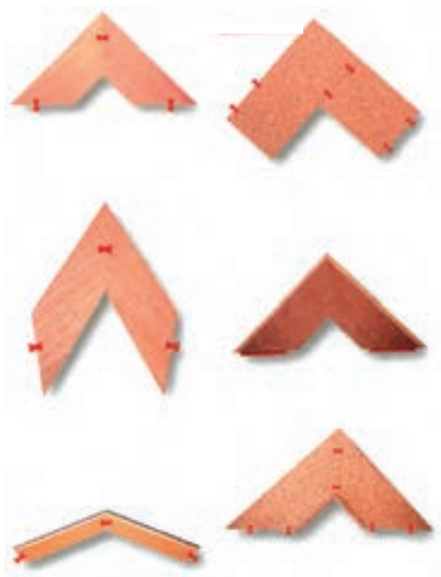
شکل ۹-۹۳- اتصال دم چلچله در قطعات با زوایای مختلف
