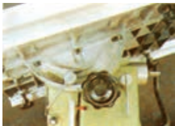
شکل ۳-۲۱- تنظیم صفحه کج شونده ماشین اژه گرد
