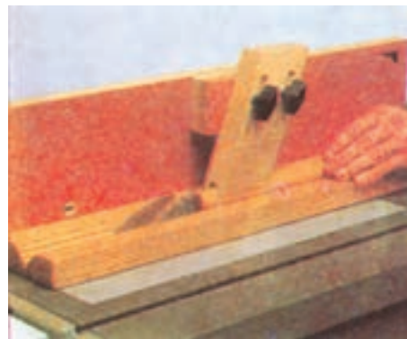
شکل ۳-۶۱- برش زهوار گرد به وسیله اژه گرد با کمک شابلون یا فیکسچر مخصوص شانه‌ای
