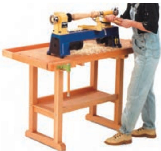
شکل ۱۴-۳- نحوه کار کردن با ماشین خراطی رومیزی
