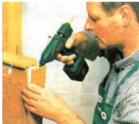
شکل ۱۴-۱۱- نحوه استفاده از چسب مخصوص گرم میله‌ای
