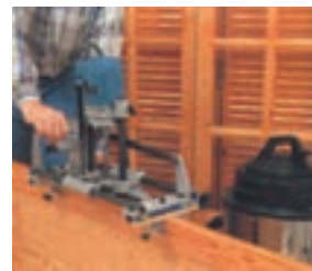
شکل ۷۹-۹- ایجاد شیار افقی برای قفل مغزی
