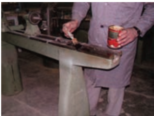
شکل ۱۴-۴۹- آغشته به نفت کردن بستر ماشین خراطی
