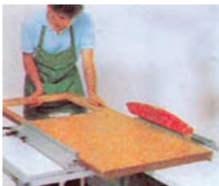
شکل ۳-۴۳- نحوه‌ی برش لبه صفحات عریض
