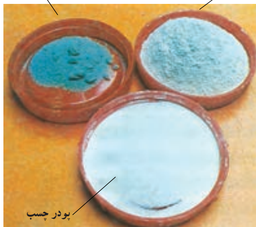
شکل ۷-۲- پودر چسب - پودر سخت کننده و آرد
