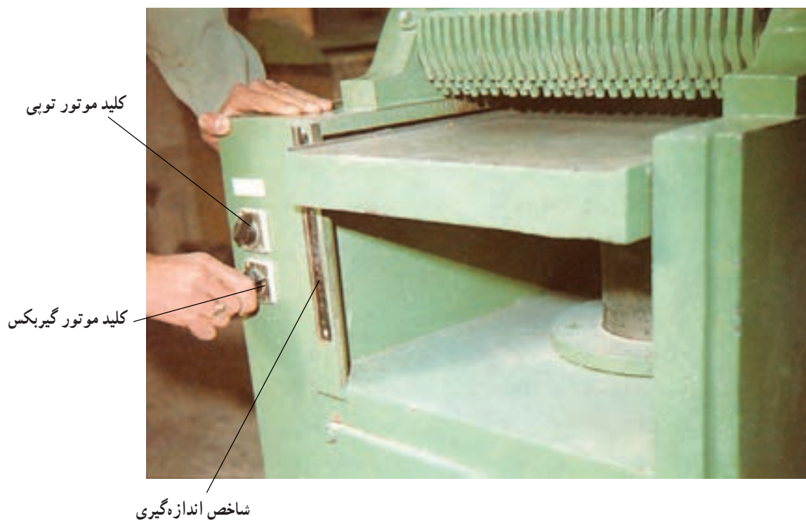
شکل ۴-۷۵- نحوه روشن کردن از کنار ماشین گندگی
