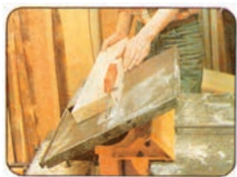
شکل ۳-۲۲- برش با صفحه کج شده اژه
