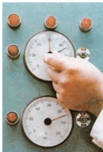
شکل ۷-۲۱- نحوه تنظیم حرارت سنج پرس
