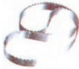
شکل ۲-۳۴ و ۲-۳۵- تیغه اره جوش داده شده و ساده
