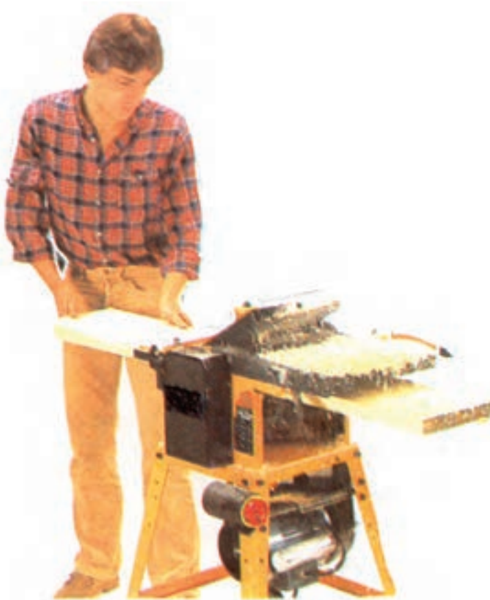
شکل ۸۱-۴-۱ - طریقه گندگی کردن صفحات بلند
