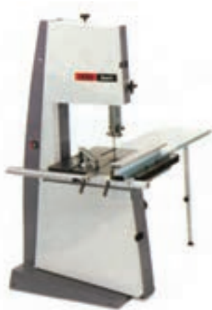
شکل ۳۱-۱- ماشین اره نواری با حفاظ کامل
