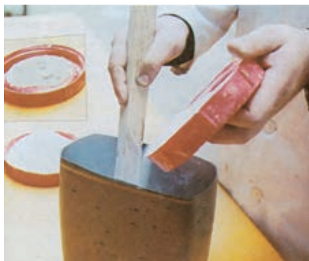
شکل ۴-۷- محلول کردن پودر چسب با آب
