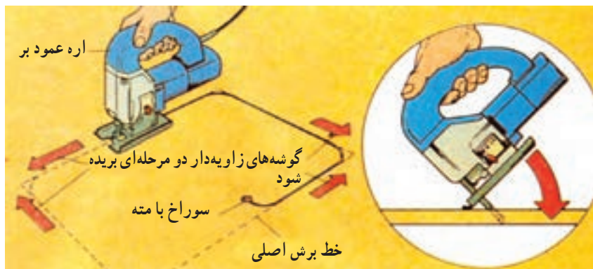
شکل ۱۶-۲- نحوه برشکاری وسط صفحات و برشکاری گوشه‌های کار با اره عمودبر
