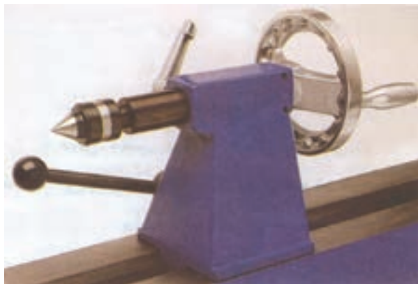
شکل ۲۱-۱۴- مرگک متحرک را در سر دیگر چوب محکم کنید.
