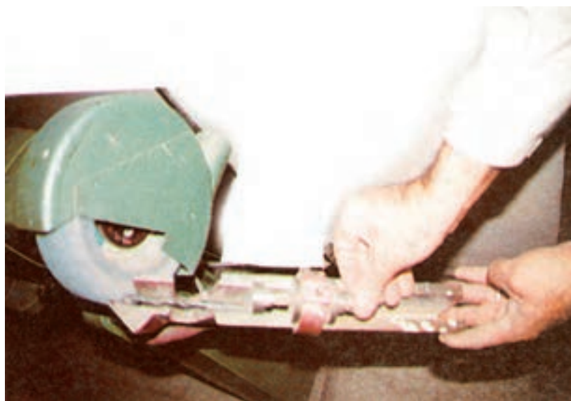
شکل ۹-۵۱- نحوه تیز کردن مته ماریج با ماشین سنگ سنباده با کمک مقر مته
