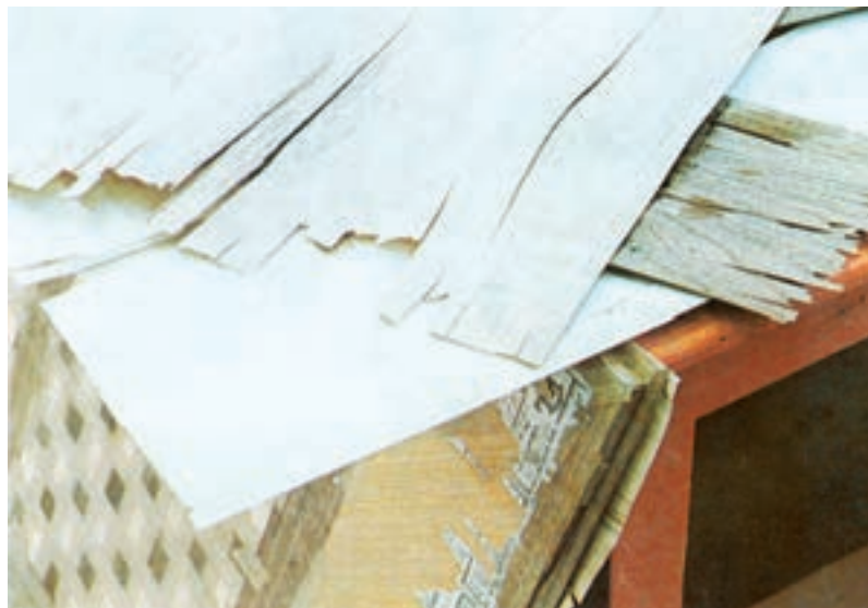
شکل ۴-۵- روکش‌های ترک دار مناسب برای پشت کار
