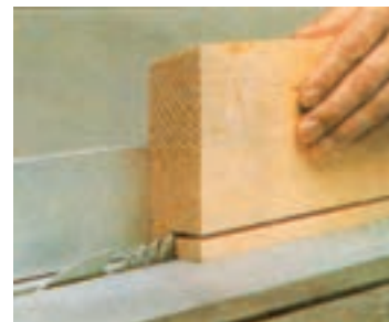
شکل ۳-۵۲- روش دو راهه زدن با ماشین ارّه گرد
