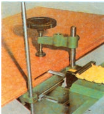
شکل ۹-۴۵- تنظیم عمق و عرض سوراخ کام در ماشین مته افقی
