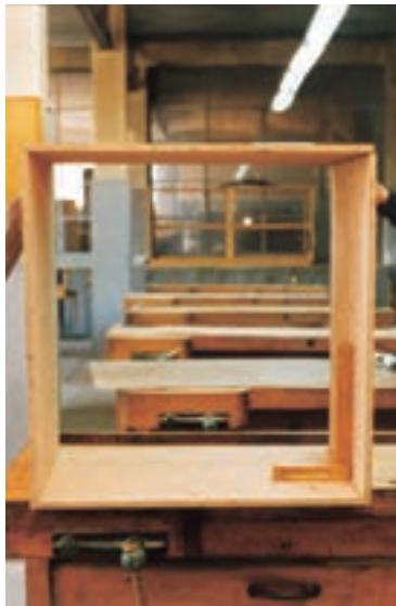
شکل ۱۱-۲۶- کنترل زوایای کار مونتاژ شده
