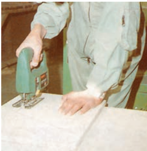
شکل ۱۰-۲- نحوه برش قطعات کوچک تخته خرده چوب
