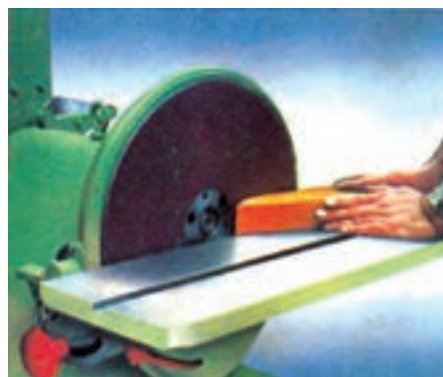
شکل ۸-۱۲- نحوه سنباده زدن قوس‌های محدب
