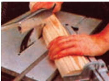
شکل ۳-۶۴- برش عرضی زاویه دار چوب پروفیل خورده
