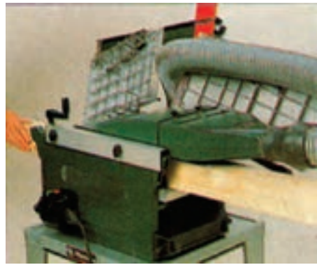
شکل ۸۲-۴ گندگی کردن چوب بلند با ماشین گندگی مجهز به مکنده
