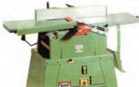
شکل ۴-۱۴- پیچ‌های زیر صفحه برای اصلاح کجی صفحه ماشین رنده می‌باشد.
