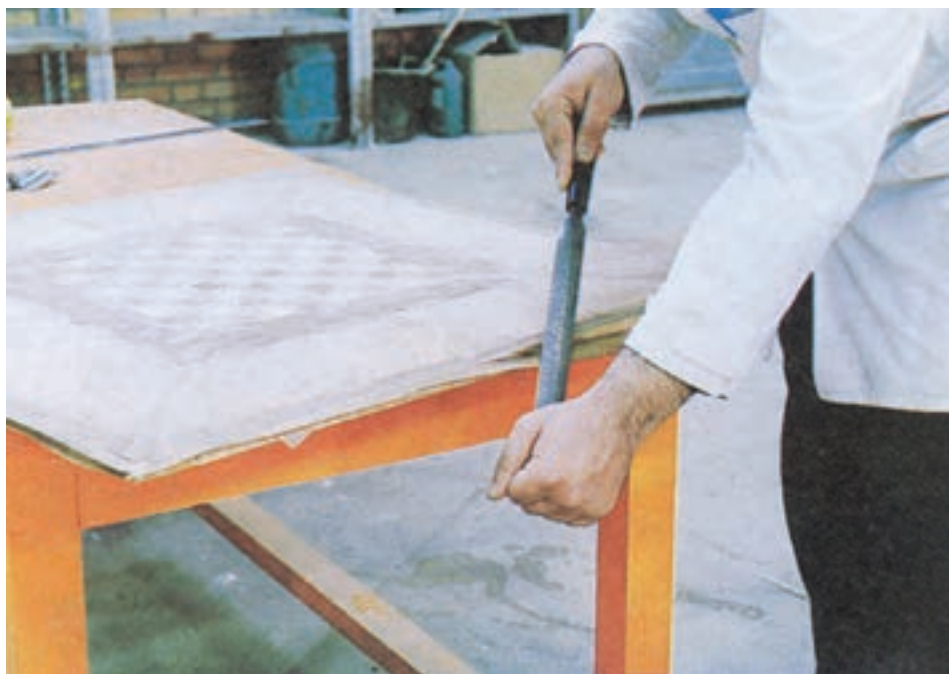
شکل ۳۳-۷- نحوه برطرف کردن اضافات لبه روکش‌ها به وسیله سوهان
