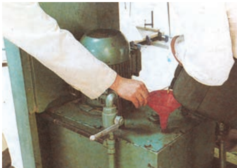
شکل ۱۷-۷- ریختن روغن هیدرولیک داخل کارتر
