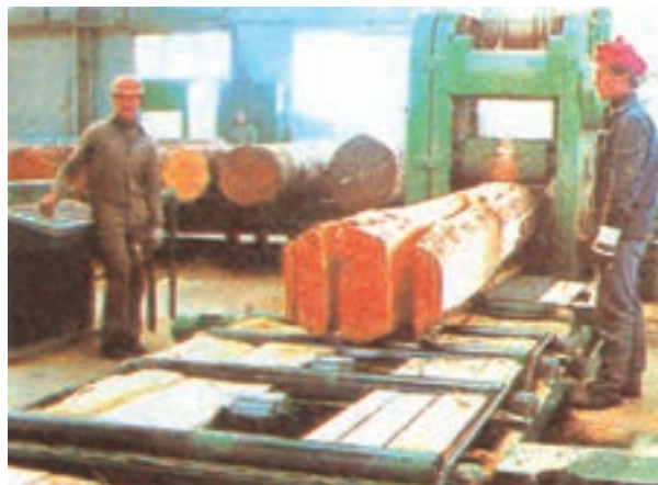
شکل ۲-۱- تبدیل گرده بینه به تخته و الوار با ماشین اره متناوب (گاتر).
