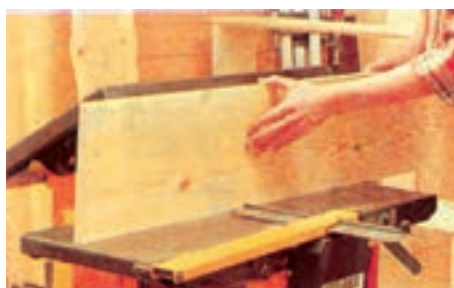
شکل ۴-۳۹- طریقه رندیدن ضخامت صفحات نازک
