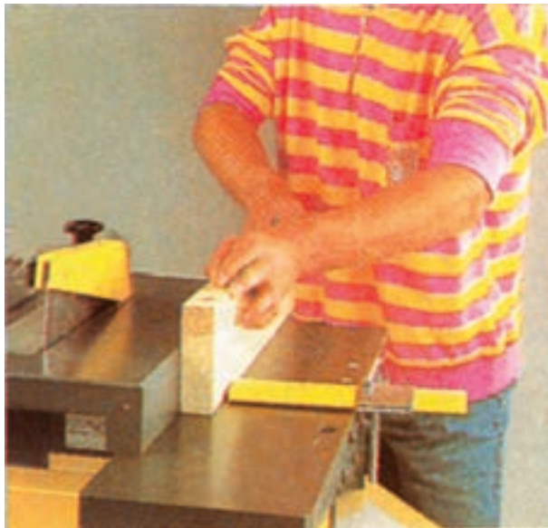
شکل ۴-۴۷- رنده کار فاقد لباس کار مناسب است و به گونه ای ناصحیح ایستاده است
