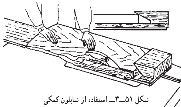
شکل ۳-۵۰- شابلون برای برش‌های طولی لبه صفحات بلند با ارّه گرد
