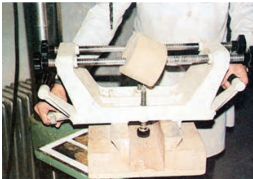
شکل ۹-۴۲- استفاده از فیکسچر در استقرار قطعات نامنظم روی میز ماشین
