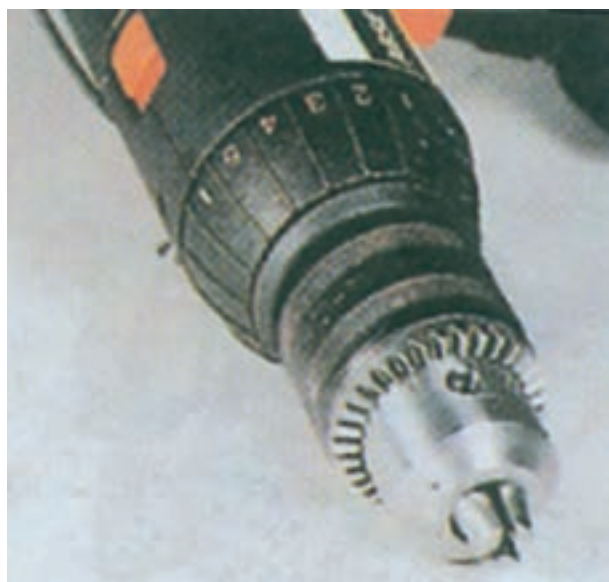
شکل ۱۶-۱۲- دریل برای سرعت کم تنظیم شده
