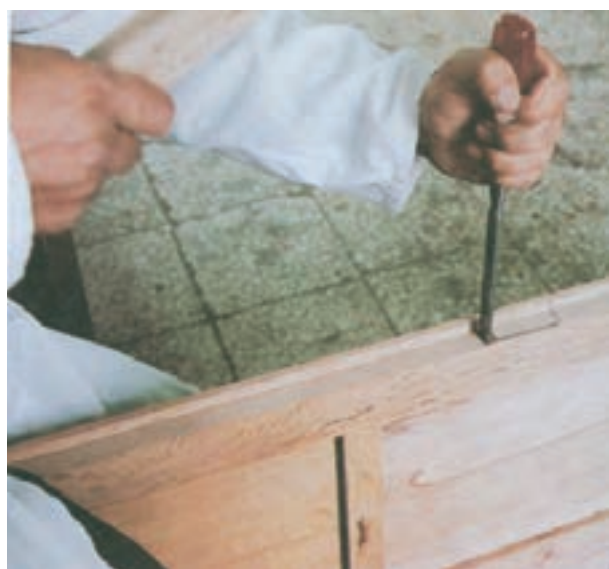
شکل ۱۶-۶ مورد استفاده مغار برای در آوردن جای یراق و محل اتصالات
