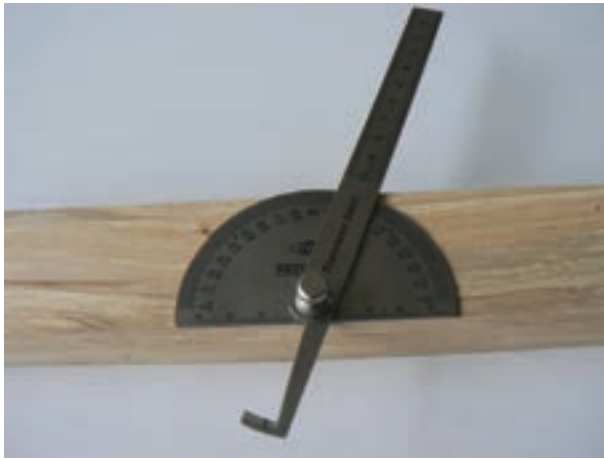
شکل ۱۵-۱ اندازه‌گیری و خط‌کشی زاویه به وسیله‌ی نقاله
