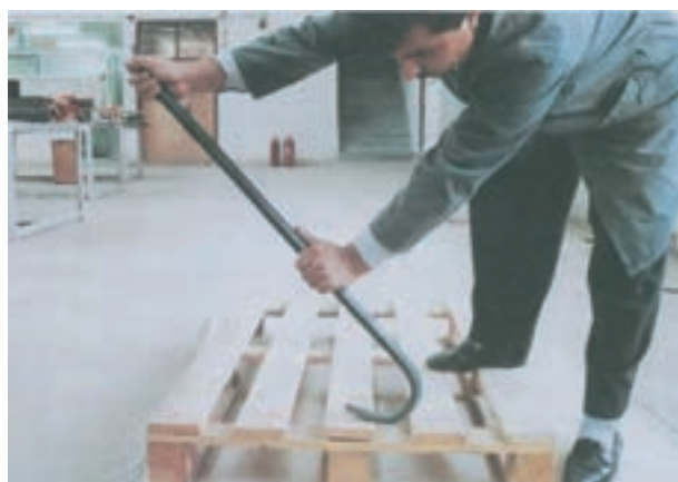
شکل ۱۱-۱۶- طریقه‌ی میخ‌کشی به وسیله‌ی میخ‌کش اهرمی
