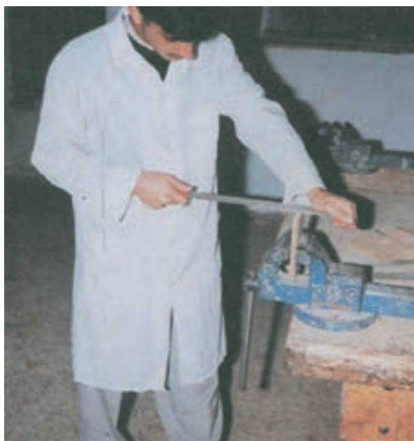
شکل ۳-۳- نحوه‌ی ایستادن جهت سوهان کاری و چوبساکاری
