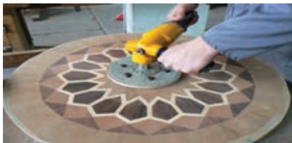
شکل ۲۵-۹- به وسیله ماشین سنباده دیسکی (بشقابی) صفحاتی روکش چسبانی شده اند. به طور ساده یا نقشه دار (با طرح های مختلف) می توانید سنباده کاری و پرداخت کنید. با تعویض دیسک سنباده آن و قرار دادن صفحه نمدی به ماشین، سطوح پولیستر شده را پرداخت کنید.
