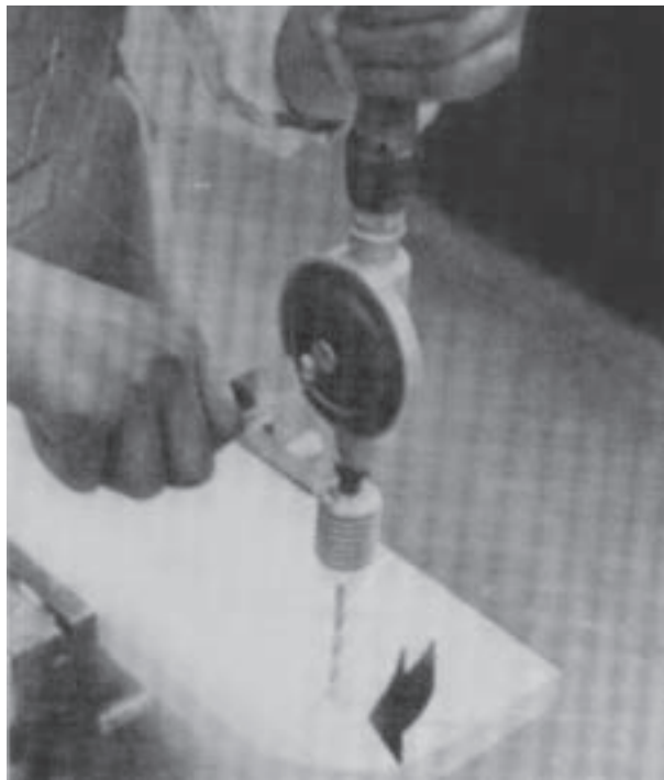
شکل ۱۴-۵۲- با دریل دستی یا برقی سوراخ عمود بر سطح قطعه انجام می‌شود
