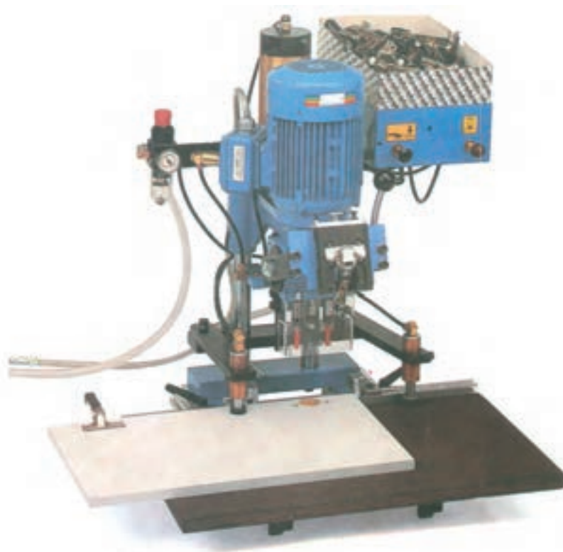
شکل ۸-۴۸- ماشین فرز مخصوص جهت درآوردن جای لولای کابینتی، در این ماشین قطعه کار به‌وسیله‌ی دو کفشک پنوماتیکی روی صفحه نگه‌داری می‌شود.
