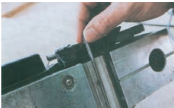
شکل ۵-۸۲- نحوه‌ی استقرار تیغه در تویی
