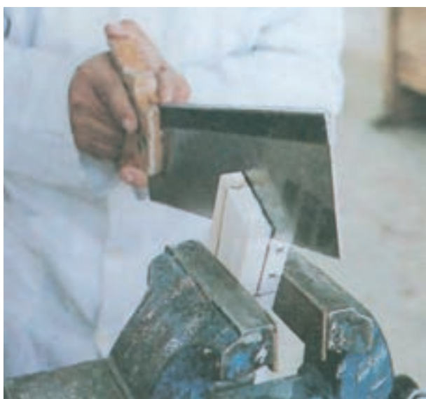
شکل ۱۰-۷- طریقه برش اتصال نیم و نیم
