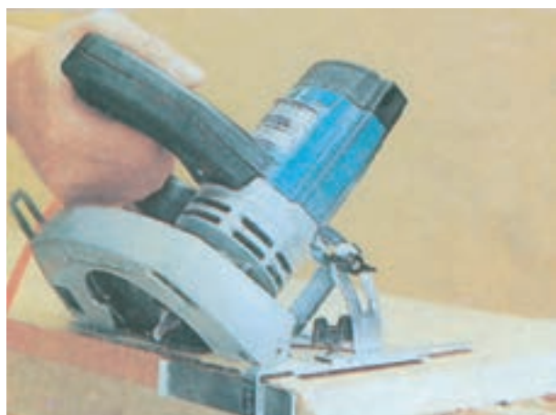
شکل ۲-۲۹- برش تحت زاویه به وسیله‌ی گونیای دستگاه
