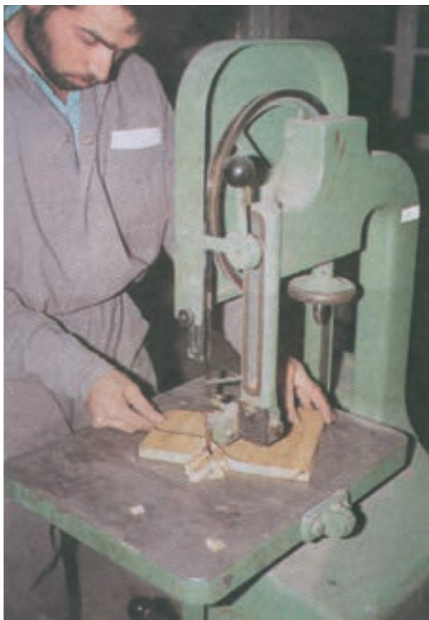
شکل ۳۱-۱۴- قوس بری قطعه صندلی الکلنگ به وسیله آره نواری کوچک
