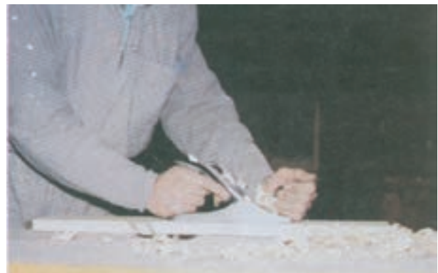
شکل ۴۶-۱۴- رندیدن سطح قطعه شماره ۷ با رنده آهنی و با کمک هاکن یا قلاب میزکار
