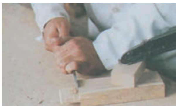
شکل ۱۴-۶ طریقه‌ی تسطیح انتهای زبانه
