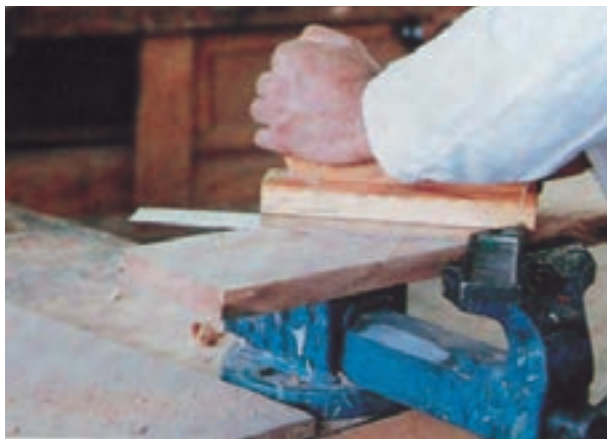
شکل ۵-۳۲- نحوه کاربرد رنده خشی
