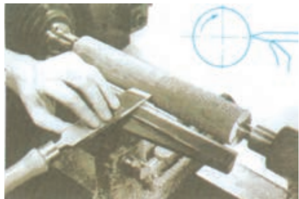
شکل ۱۳-۱۲- مغار روی تکیه‌گاه در حالت‌های مختلف تراشه‌های متفاوتی برمی‌دارد.
