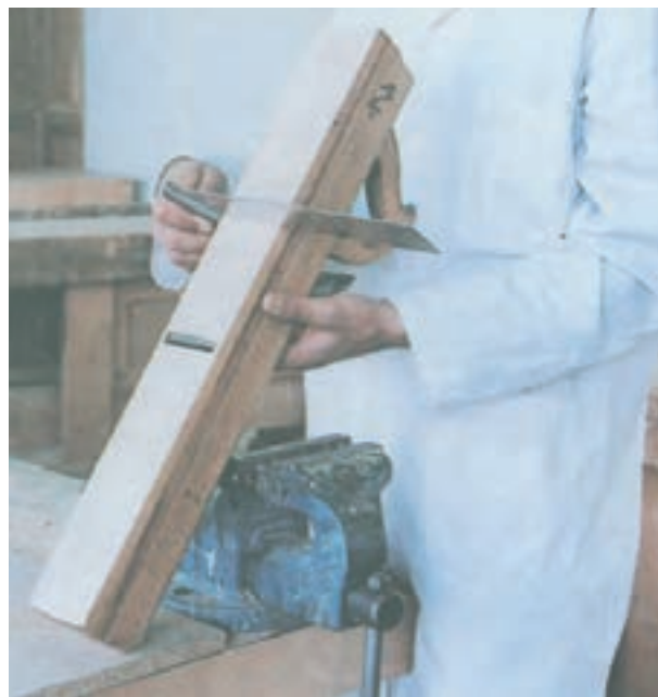
شکل ۵-۳۰- کنترل عرضی سطح رنده
