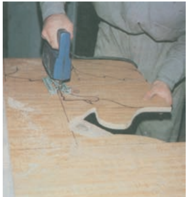
شکل ۲۷-۱۴- عمل برش سر خروس و نحوه استقرار هنرجو
