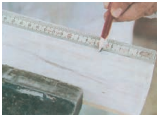
شکل ۶-۷- اندازه اتصال را روی چوب علامت‌گذاری کنید.
