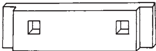
شکل ۶۳-۱۴- قید افقی اتصال پایه قطعه شماره ۱۰
