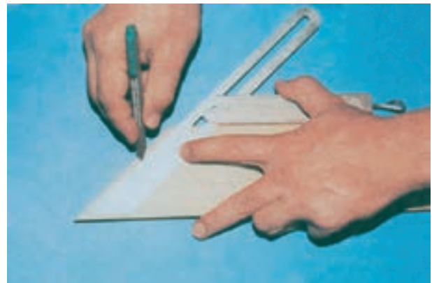
شکل ۱۸-۱- انتقال زاویه بر روی قطعه مورد نظر
