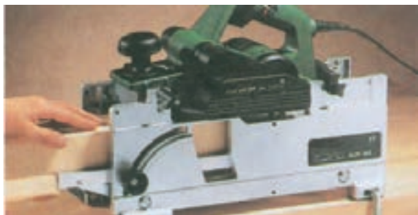
شکل ۷۴-۵- نحوه کندگی کردن (به یک ضخامت کردن) چوب با رنده برقی
