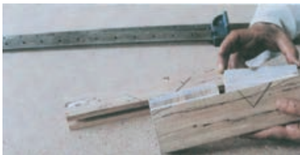
شکل ۷-۴۵- داخل کردن زبانه‌ی قلیف
