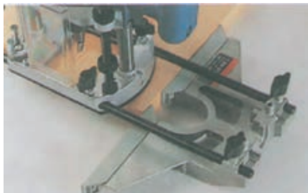
شکل ۸-۱۲- با قراردادن گونیا در کنار قطعه کار، فاصله محل ابزار تا لبه‌ی کار مشخص می‌شود.
