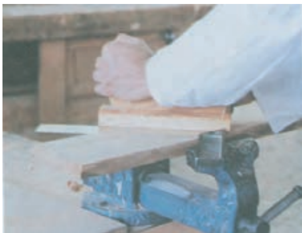
شکل ۵-۳۳- حرکت دادن مورب رنده خشی
