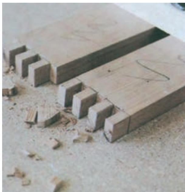
شکل ۷-۳۶- قسمت‌های اضافی فاق و زبانه در آورده شده است.
