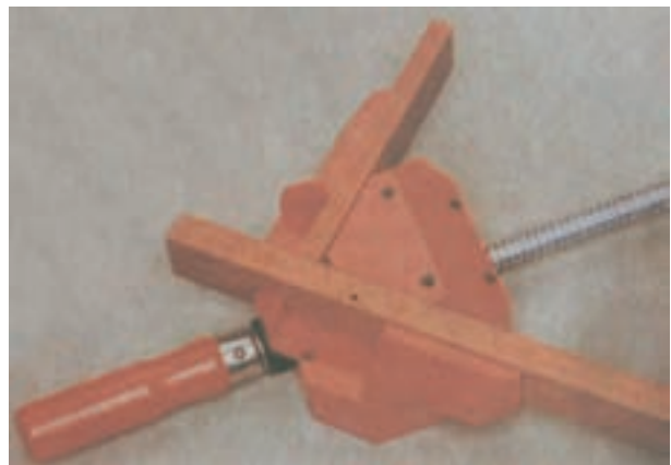
شکل ۱۶-۱۰- یک نوع گیره مخصوص قاب
