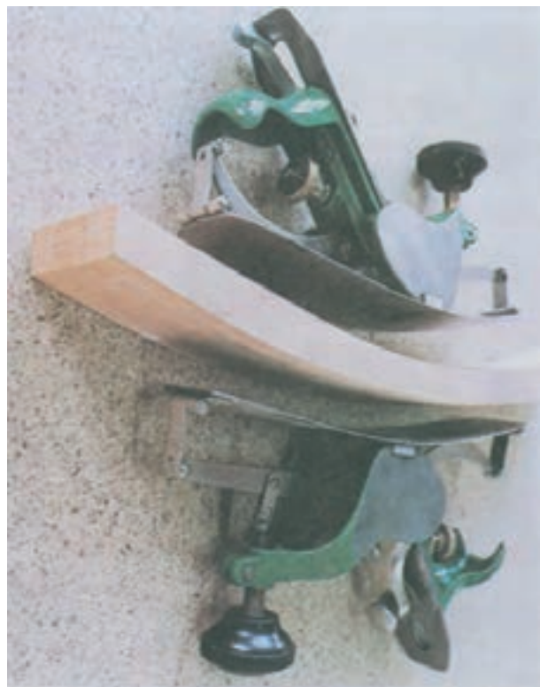
شکل ۶۰-۵ محدب و مقعر شدن کف رنده
