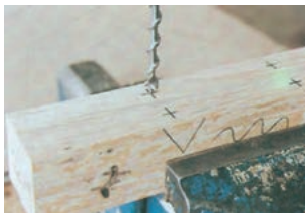
شکل ۷-۵۱- استقرار نیش‌مته در مرکز سوراخ
