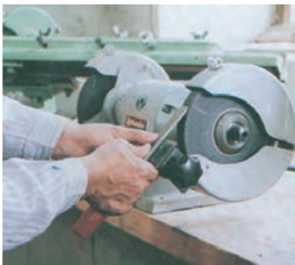
شکل ۳۱-۶- تنظیم تکیه‌گاه برای تیزکردن مغار
