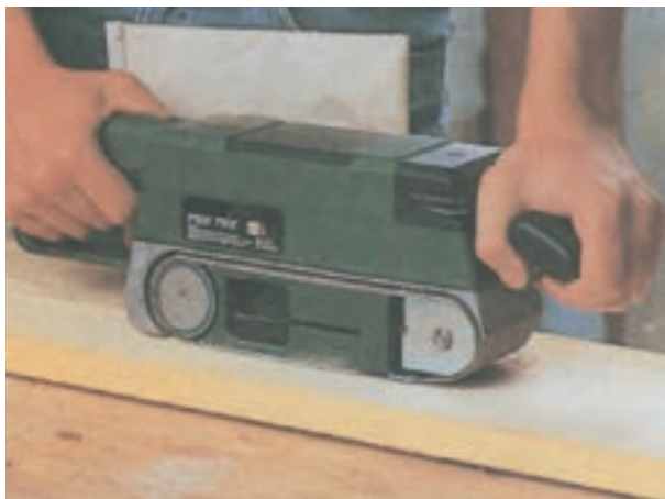
شکل ۹-۱۲- نحوه‌ی گرفتن ماشین سنباده به وسیله‌ی دو دست از خم شدن بر روی ماشین هنگام کار خودداری شود. خاک سنباده حاصل به داخل کیسه مربوط منتقل می‌شود.
