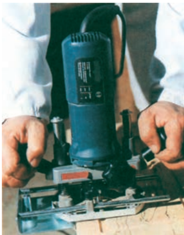
شکل ۲۹-۸- با گرفتن ماشین در دو دست و تکیه‌دادن آن به لبه‌ی جعبه‌ها (کشو) روی آن‌ها شیار دلخواه را ایجاد کنید.
