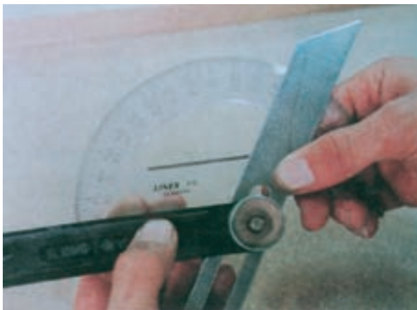
شکل ۱۶-۱ تنظیم گونیای تاشو به وسیله‌ی نقاله
