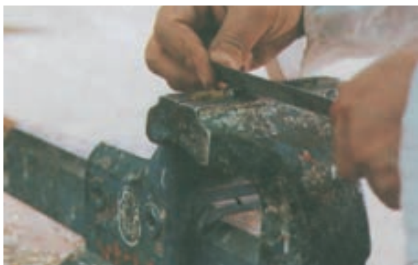
شکل ۲-۶۸- نحوه‌ی به‌دست‌گیری سوهان در تیزکردن اره‌ها
