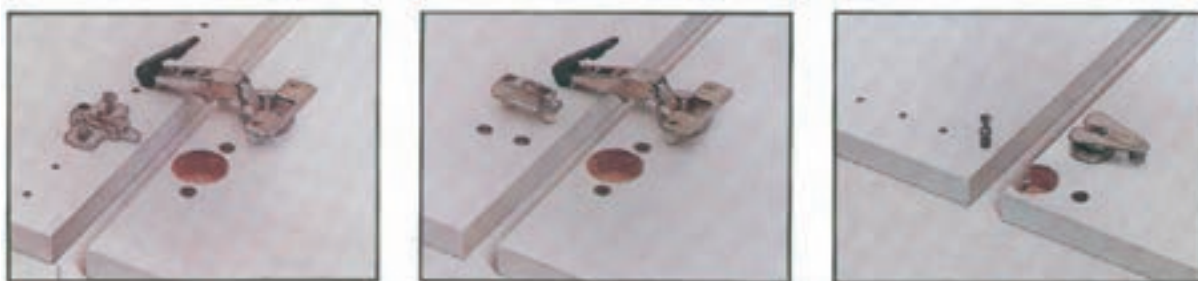
شکل ۸-۵۰- طریقه ی جاسازی و نصب لولای کابینتی
