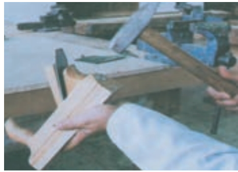
شکل ۹-۵- نحوه‌ی خارج کردن تیغه از کوله رنده
