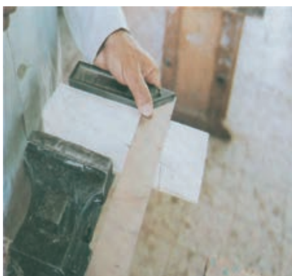
شکل ۷-۷- به وسیله گونیا چوب را خط‌کشی کنید.
