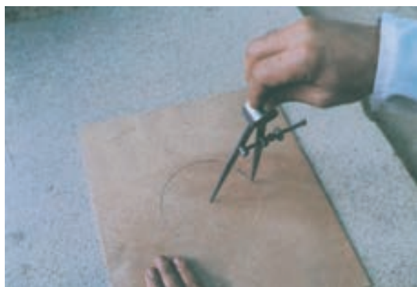
شکل ۱-۲۹- ترسیم دایره به وسیله‌ی پرگار معمولی
