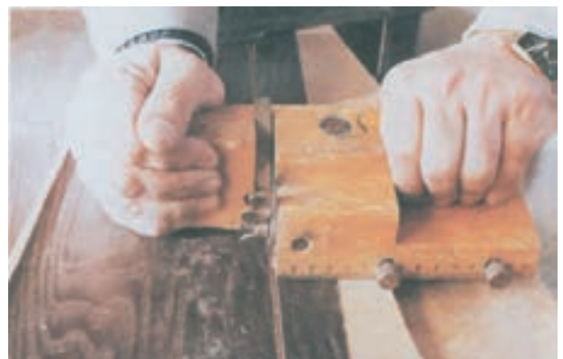
شکل ۵-۵۴- نحوه ایجاد شیار برای نصب مغزی
