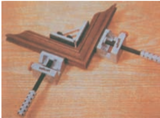
شکل ۱۲-۱۰ پیچ دستی مخصوص گوشه‌های کار
