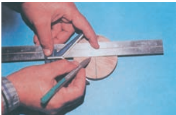
شکل ۲۳-۱- کاربرد مرکز‌یاب برای مشخص کردن مرکز مقاطع گرد
