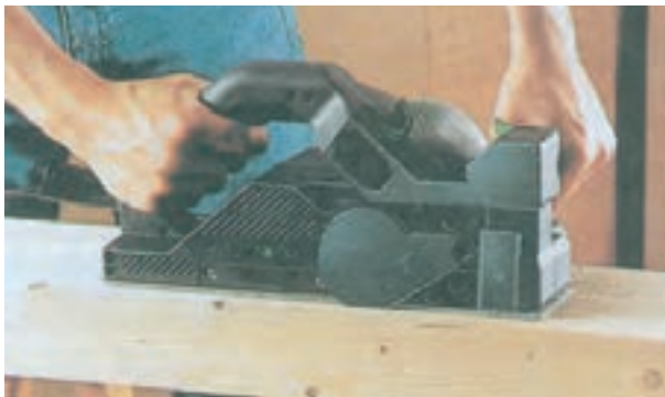
شکل ۵-۶۹- نحوه استقرار دست‌ها در عملیات رنده‌کاری
