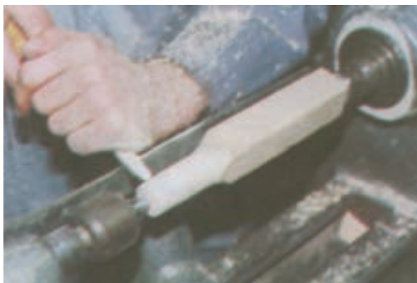
شکل ۱۳-۱۴- ابتدا به وسیله گلوئی ناهمواری‌های چوب گرفته می‌شود.
