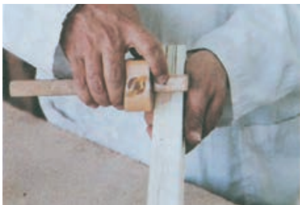
شکل ۷-۱۳- خط کشی اتصال فاق و زبانه با خطکش تیره دار
