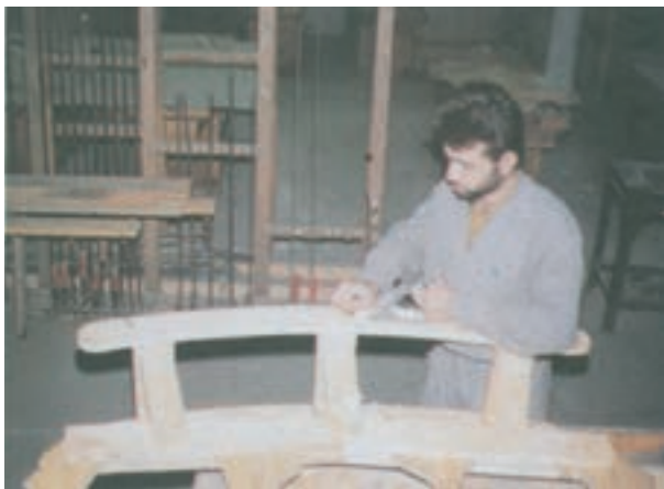
شکل ۸۱-۱۴- عملیات پرداخت کاری نهایی الکلنگ مونتاز شده
