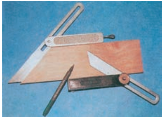
شکل ۱۷-۱- کپی برداری از زاویه‌ی مورد نظر به وسیله‌ی گونیای تاشو
