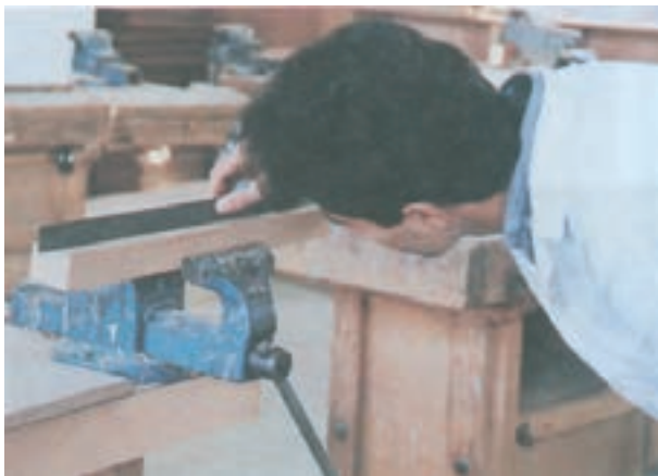
شکل ۲۳-۵- کنترل صافی سطح رنده شده
