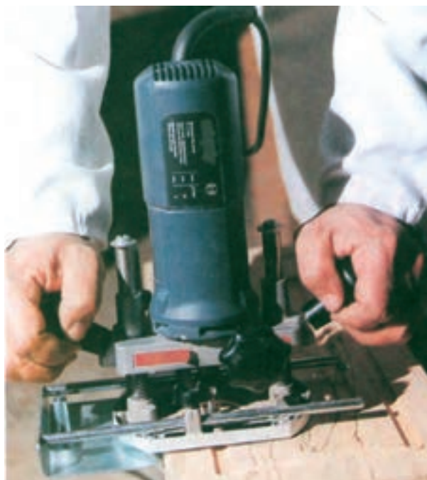
شکل ۸-۳۸- نحوه گرفتن ماشین فرز به وسیله دو دست
