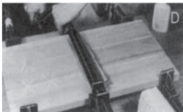
شکل ۱۰-۲۹- با استفاده از تنگ‌های بزرگ می‌توانید تخته‌ها را در کنار هم چسبانیده صفحات عریضی را به‌وجود آورید.
