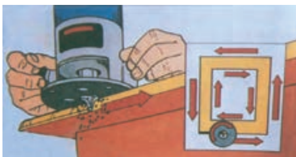
شکل ۸-۲۷- با تکیه‌دادن تیغ فرز به راهنما و تکیه‌گاه پایه به لبه‌ی کار می‌توان تر (لبه) صفحات را فرز کاری کرد.
