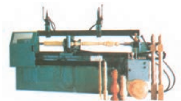
شکل ۱-۱۳- به وسیله عملیات خراطی می‌توان انواع پایه‌های چوبی آباژور (چرخ پایه‌دار) را ساخت.
