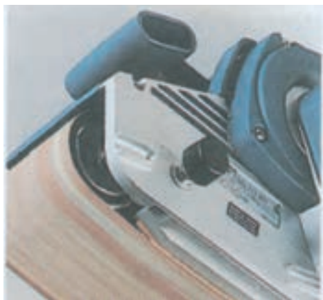
شکل ۹-۹- به وسیله‌ی پیچ مقدار کشش نوار سنباده در ماشین تنظیم می‌شود.
