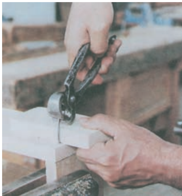
شکل ۱۱-۱۸- طریقه‌ی استفاده از گازانبر
