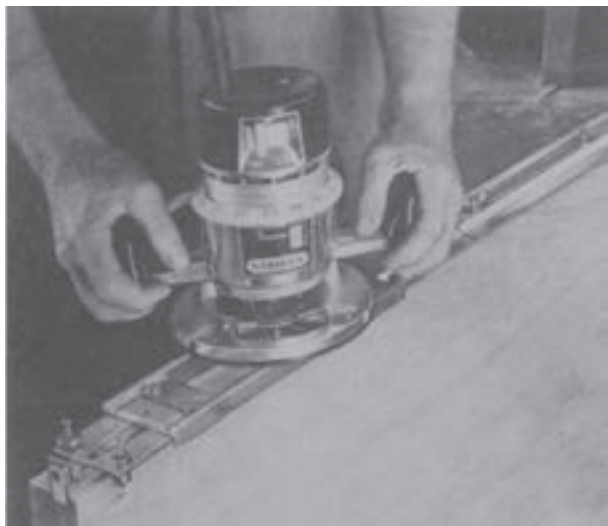
شکل ۸-۴۷- طرز درآوردن محل لولا به‌وسیله‌ی دستگاه فرز با استفاده از شابلن مربوط
