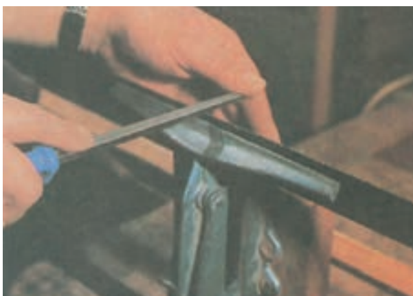
شکل ۳-۲۴ تیزکردن اره با سوهان سه‌گوش
