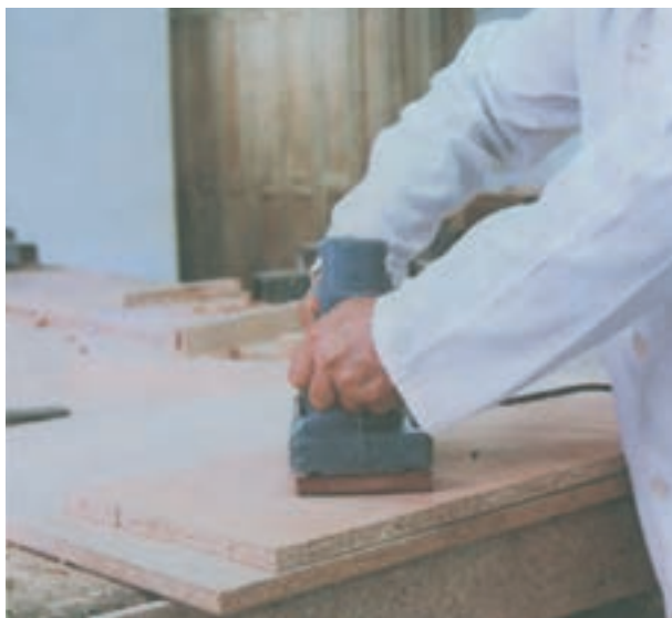
شکل ۹-۳۴- نحوه‌ی گرفتن ماشین سنباده لرزشی به وسیله‌ی دو دست و استقرار شخص نسبت به سطح کار
