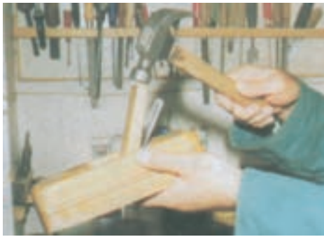
شکل ۱۰-۵- تنظیم تیغه با ضربه‌ی چکش
