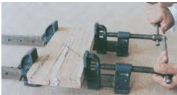
شکل ۷-۴۶- محکم کردن و چسباندن اتصال کنشکاف و قلیف به وسیله‌ی تنگ
