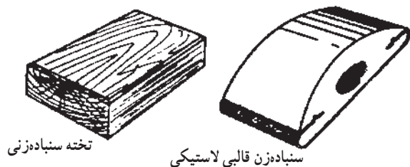
شکل ۹-۵- طریقه سنبناده کاری نر (ضخامت) کار با استفاده از تخته سنبناده
