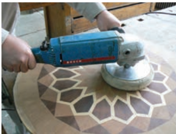
شکل ۲۰-۹- ماشین سنباده دیسکی را می‌توانید به‌عنوان پولیش‌کاری در رنگ‌های پولیستر به‌کار ببرید.
