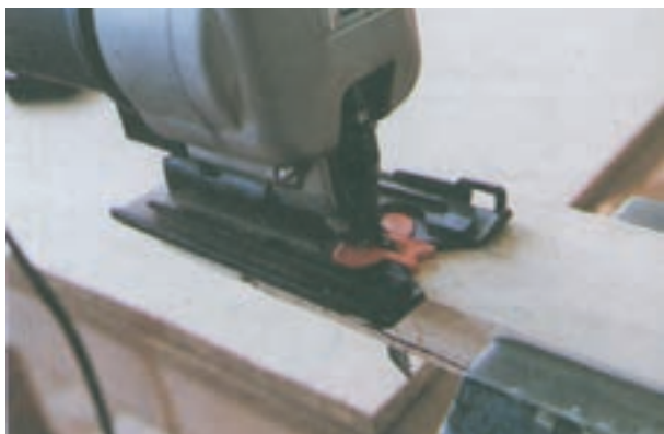
شکل ۲-۵۳- استفاده از قطعه هدایت تیغه در اره چکشی عمود بر
