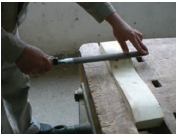
شکل ۳-۹- نحوه‌ی استقرار در مقابل قطعه کار و شروع عمل سوهان‌کاری
