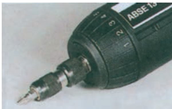
شکل ۱۵-۱۲- دریل پیچ‌گوشتی برای سرعت زیاد تنظیم شده
