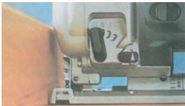
شکل ۲-۳۷- کلید تغییر دور در اره‌ی چکشی
