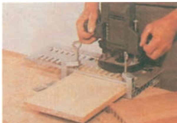
شکل ۸-۲۳- با بستن شابلن اتصال دم چلچله روی قطعات چوبی، می‌توان با به کارگیری ماشین فرز دستی اتصال مذکور را انجام داد.
