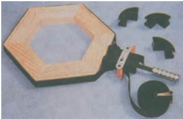
شکل ۱۸-۱۰- نحوه‌ی بستن قطعات کوچک چوبی به وسیله‌ی گیره کمربندی
