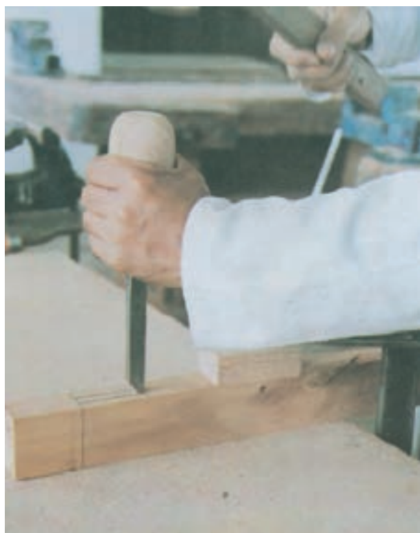
شکل ۶-۱۹- اسکنه عمود قرار داده شده
