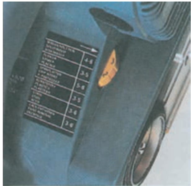
شکل ۹-۱۰- کلید تنظیم دور متناسب با نوع کار
