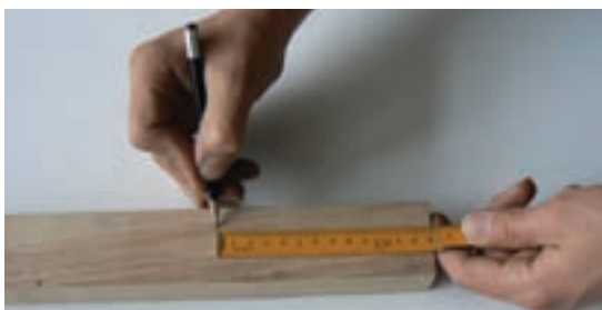
شکل ۱-۴- نحوه‌ی کاربرد متر تاشو
