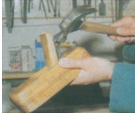
شکل ۱۱-۵- تنظیم جانبی تیغه
