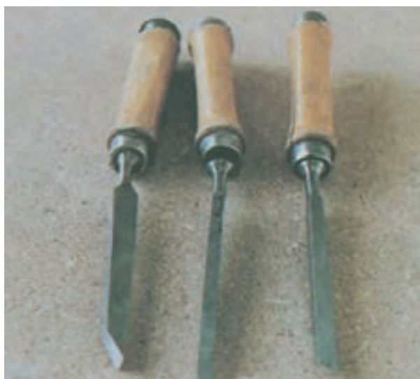
شکل ۱۲-۶ مغار در دسته کج قرار گرفته
