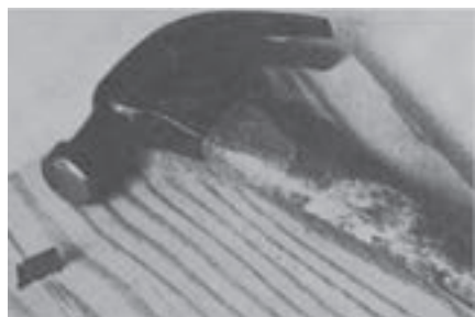
شکل ۶۸-۷ نحوه‌ی کوبیدن سوزن دوخت زیگزاگی در چوب
