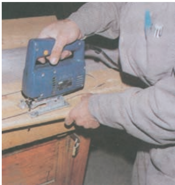
شکل ۳۳-۱۴- برش کاری قوس خارجی قطعه شماره ۱۱
