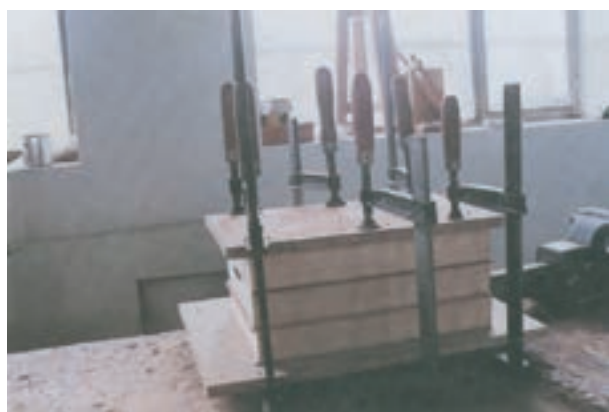
شکل ۶-۱- نحوه‌ی بستن پیچ دستی روی تعدادی از قطعات چسب خورده
