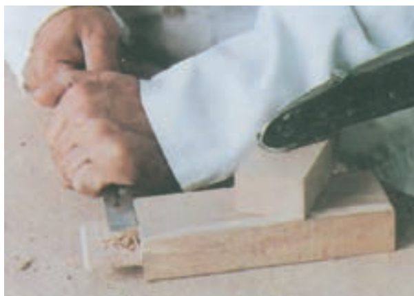
شکل ۶-۴ صاف کردن اطراف زبانه با مغار
