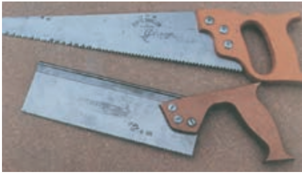
شکل ۲-۵- اره با دندان‌ه رو به جلو
