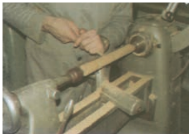
شکل ۱۵-۱۳- عمل خراطی تا استوانه‌ای شدن چوب ادامه پیدا می‌کند.
