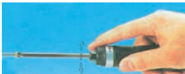
شکل ۸-۱۲- وضعیت استفاده ساده از آچار پیچ‌گوشتی خودکار
