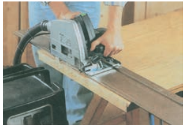
شکل ۲-۳۱- برش در خط مستقیم به وسیله‌ی اره‌ی مجموعه‌ای همراه با مکند
