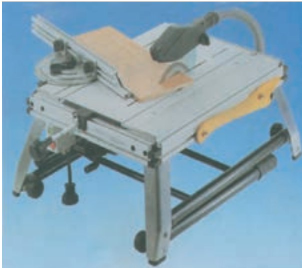
شکل ۲-۳۵- نمونه میز کار جهت متصل کردن اره‌ی گرد (مجموعه‌ای) دستی جهت سهولت کار
