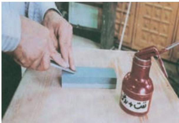
شکل ۶-۳۵- طریقه کشیدن تیغ مغار روی سنگ نفت
