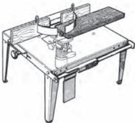
شکل ۸-۵۲- استقرار فرز زیر صفحه میز
