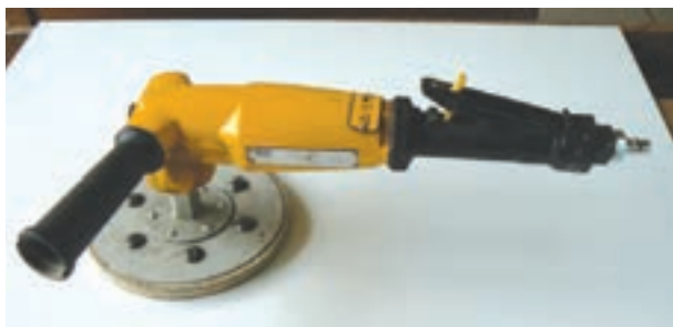
شکل ۲۵-۹- به وسیله ماشین سنباده دیسکی (بشقابی) صفحاتی روکش چسبانی شده اند. به طور ساده یا نقشه دار (با طرح های مختلف) می توانید سنباده کاری و پرداخت کنید. با تعویض دیسک سنباده آن و قرار دادن صفحه نمدی به ماشین، سطوح پولیستر شده را پرداخت کنید.
