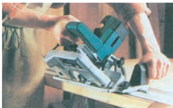
شکل ۲-۳۰- برش به وسیله‌ی اره مجموعه‌ای به کمک صفحه راهنما
