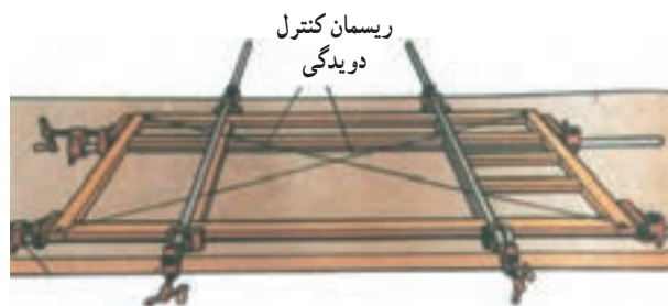
شکل ۱۰-۳۰- با تنگ‌های بزرگ می‌توانید با آوردن فشار یکنواخت از دو جهت کار را به‌خوبی بچسبانید (سطح قاب‌ها پیچیده نشوند).
