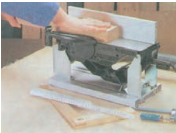
شکل ۵-۷۰- نحوه رنده کردن به طریق حرکت دادن چوب
