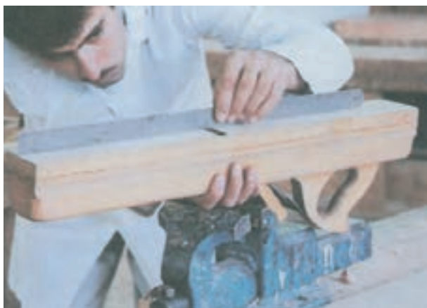
شکل ۲۹-۵- کنترل سطح رنده‌ی بلند
