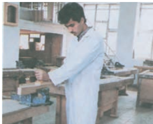
شکل ۱۷-۵ - نحوه‌ی کاربرد رنده یک تیغ
