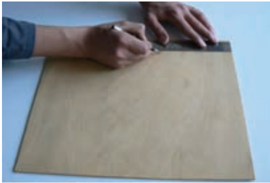
شکل ۱-۱- نحوه‌ی اندازه‌گذاری با خط‌کش فلزی
