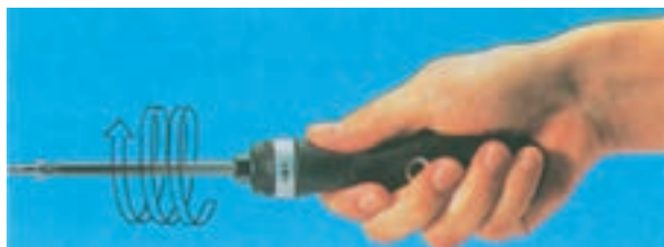
شکل ۹-۱۲- بستن سریع پیچ با آچار پیچ‌گوشتی خودکار
