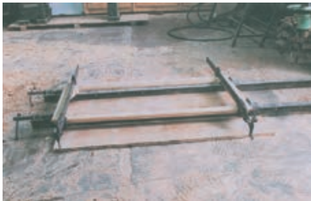
شکل ۲۸-۱۰. برای چسباندن درهای بزرگ از تنگ‌های بلند برای قیده‌های طولی (بلند) و از تنگ‌های متوسط برای قیده‌های عرضی استفاده کنید.
