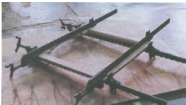
شکل ۲۷-۱۰. برای بستن کلاف درهای کوچک و متوسط از تنگ‌های متوسط استفاده کنید.
