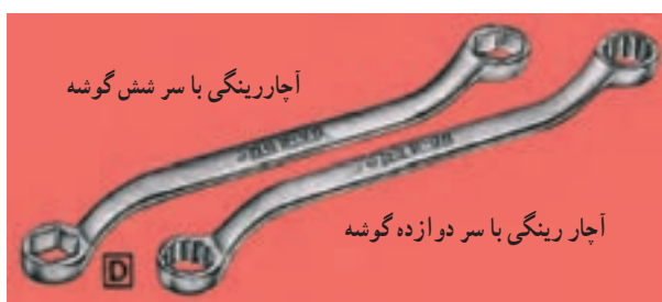
شکل ۲۸-۱۲- آچار رینگی با سر شش و دوازده گوشه
