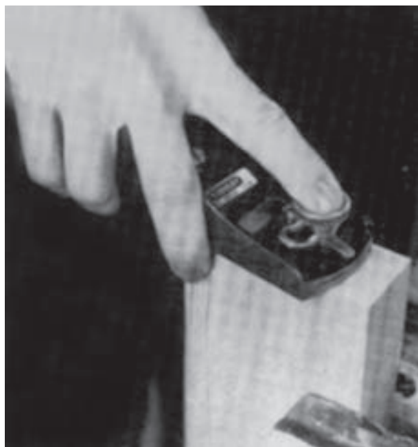
شکل ۱۴-۵۹- استفاده از رنده سرچوب در تسطیح سرچوب قطعه شماره ۸
