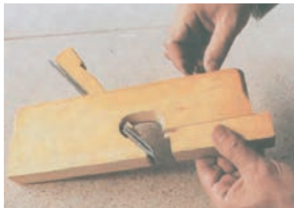
شکل ۵-۴۰- نحوه‌ی تنظیم دهانه پوشال
