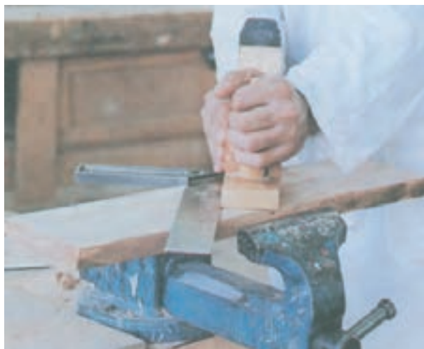
شکل ۳۴-۵- نحوه‌ی رنده کردن مجدد با رنده خشی
