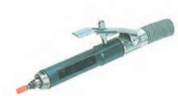
شکل ۸-۴۴ - فرز قلمی پنوماتیک قابل نصب میله خرطومی
