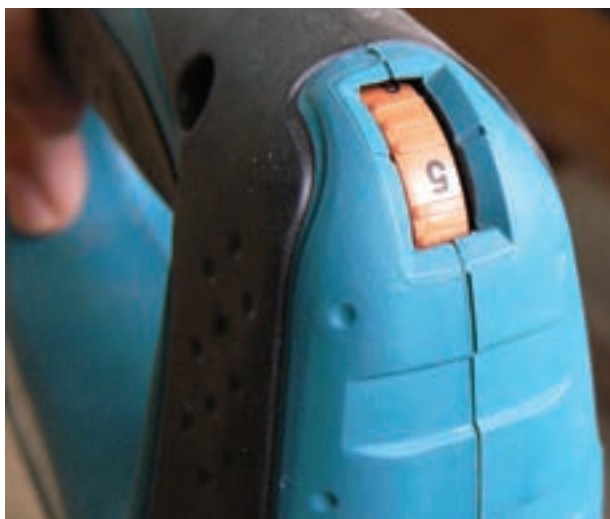
شکل ۲-۳۸- پیچ یا کلید «گاز» اره چکشی از ۱ تا ۶ وضعیت
