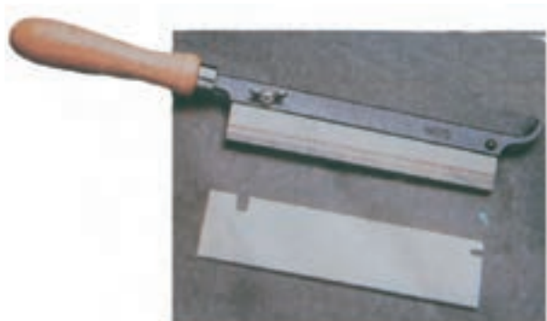
شکل ۱۵-۲- نوعی از اره ظریف بُر با تیغهی قابل تعویض
