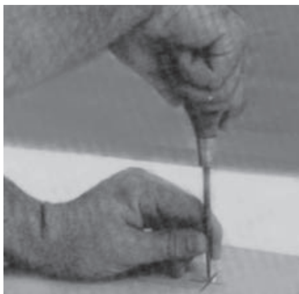
شکل ۵۱-۱۴- محل سوراخ ها را با درفش علامت گذاری کنید.
