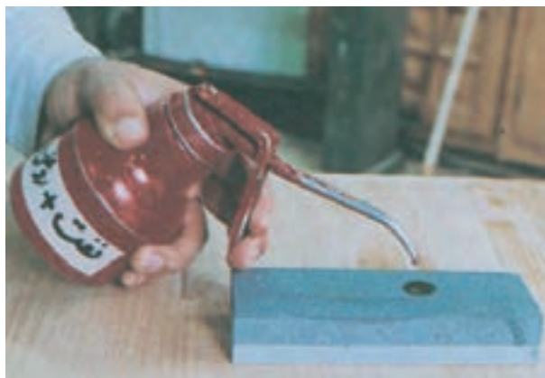
شکل ۶-۳۴- روغن زدن یا نفت زدن روی سنگ
