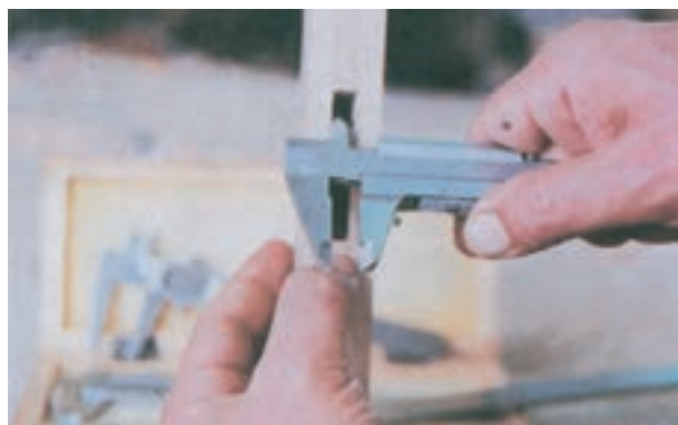
شکل ۱-۳۵- اندازه‌گیری داخلی قطعات به وسیله کولیس
