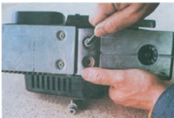
شکل ۵-۸۳- محکم کردن پیچ‌های ثابت کردن تیغه‌ها
