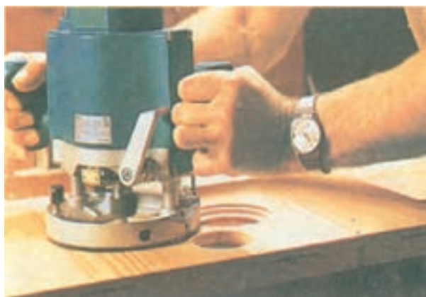
شکل ۸-۲۵- نحوه‌ی زدن دایره روی صفحات به‌وسیله‌ی ماشین فرز
