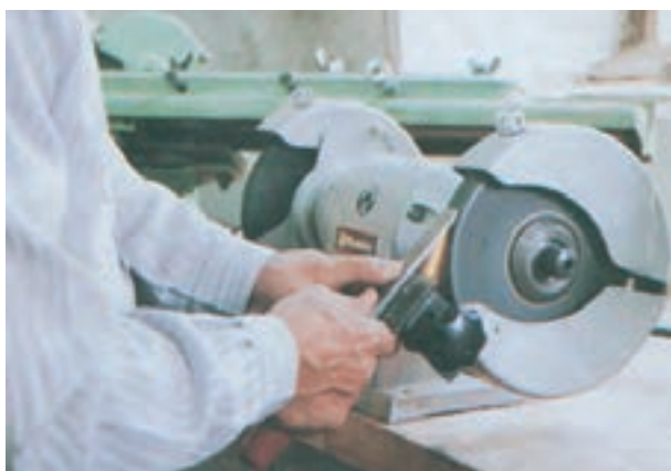
شکل ۳۲-۶- طریقه‌ی تیزکردن تیغی مغار
