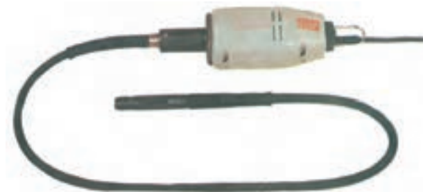
شکل ۸-۴۱- الکتروموتور و میله خرطومی همراه با سه نظام مخصوص با دور ثابت و مستقیم
