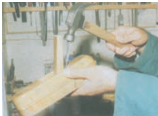
شکل ۱۱-۵- تنظیم جانبی تیغه
