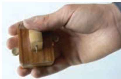
شکل ۱۲-۱- نحوه‌ی در دست‌گیری خطکش تیره‌دار
