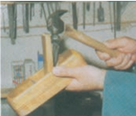
شکل ۱۱-۵- تنظیم جانبی تیغه
