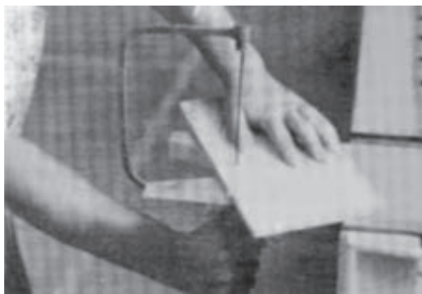
شکل ۲۲-۱۴- طریقه بریدن شابلون به وسیله اره کمانی که دندانها اره باید در موقع پایین کشیدن برش دهد.
