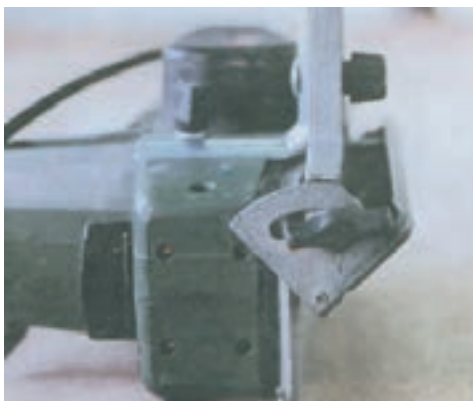
شکل ۵-۶۶- تنظیم رنده برای رنده کردن با زاویه ۴۵ درجه
