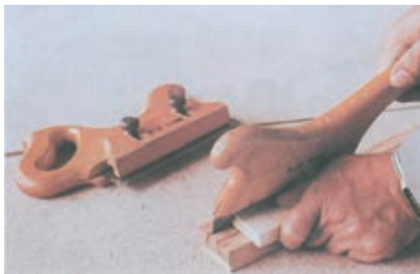
شکل ۱۷-۲- برش اتصال به وسیله اره طرح فرنگ
