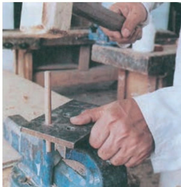
شکل ۷-۵۵- عبور دادن میخ چوبی از آهن دوپل
