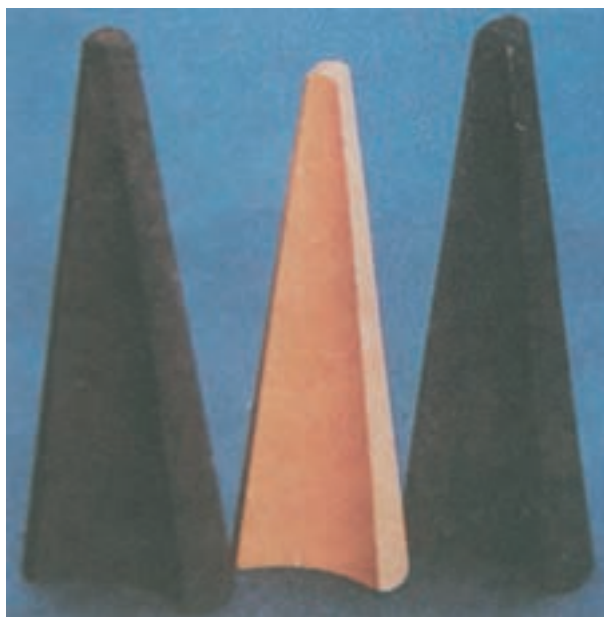
شکل ۶-۴۰- سنگ سنباده مخصوص تیزکردن مغارهای فرم‌دار
