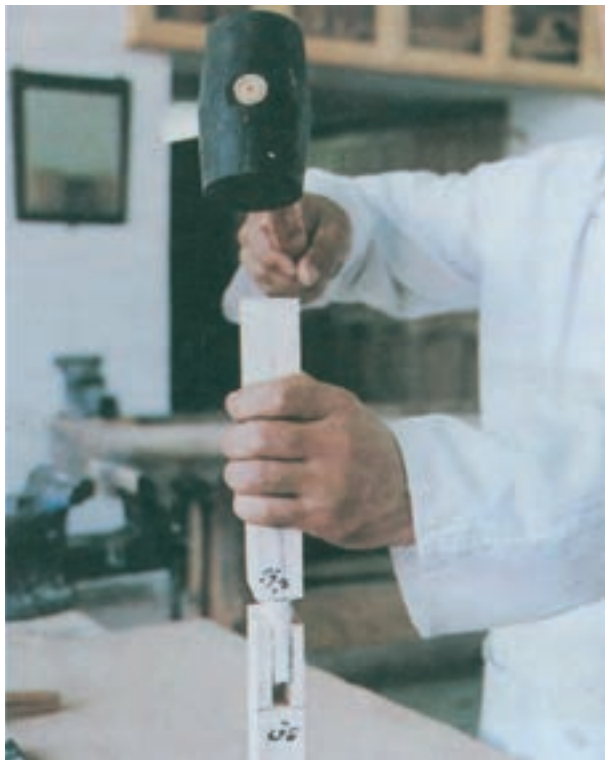
شکل ۷-۱۹- طریقه متصل کردن فاق و زبانه
