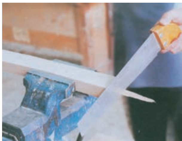
شکل ۲-۸ – لاشه شدن انتهای چوب
