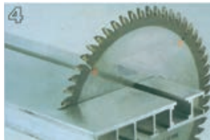
شکل ۲-۳۳- انواع تیغه‌های اره گرد از نظر فاصله دندان‌ها و نوع ساییدگی لبه‌ی الماسه تیغ جهت برش مواد مختلف
