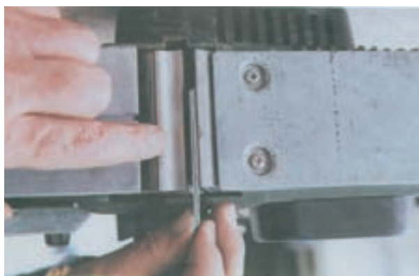
شکل ۵-۶۳- نحوه‌ی جازدن تیغ‌های رنده
