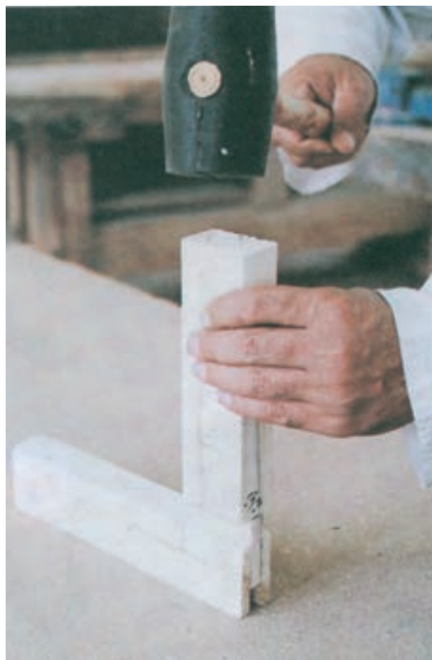
شکل ۷-۲۱- طریقه اتصال فاق و زبان‌ی گوشه‌ای
