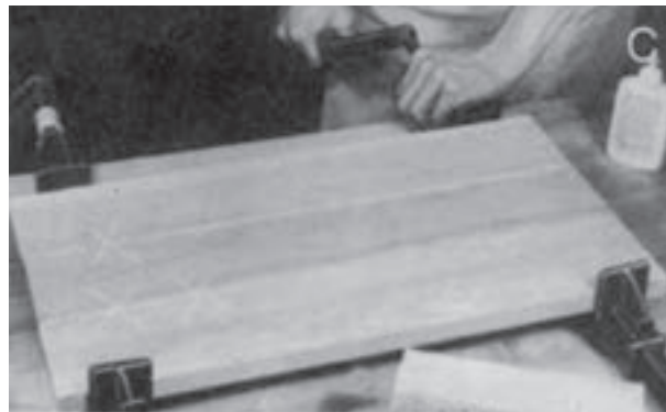
شکل ۱۰-۲۹- با استفاده از تنگ‌های بزرگ می‌توانید تخته‌ها را در کنار هم چسبانیده صفحات عریضی را به‌وجود آورید.
