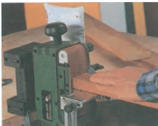
شکل ۹-۱۳- با قرار دادن ماشین سنباده به‌طور ایستاده می‌توانید کله‌ی چوب‌ها را سنباده و پرداخت کنید.
