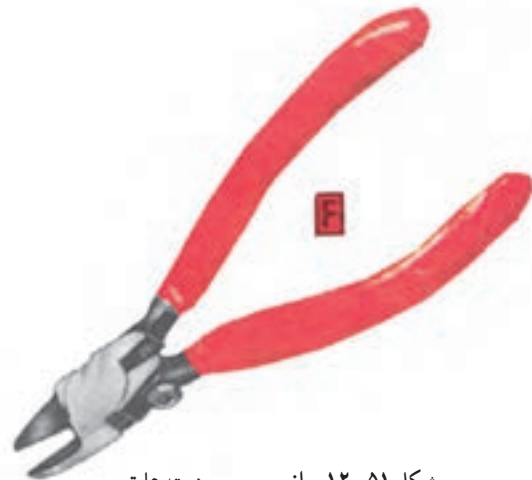
شکل ۱۲-۵۱- انبر سیم‌چین دسته عایق
