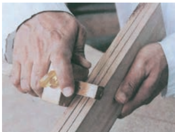
شکل ۷-۴۳- خط‌کشی کنشکاف قلیف با خط‌کش تیره‌دار
