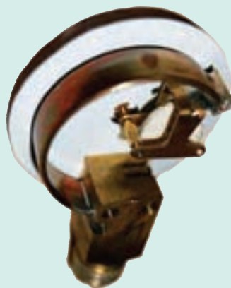
شکل ۱۲-۳ - فشارسنج بوردن
