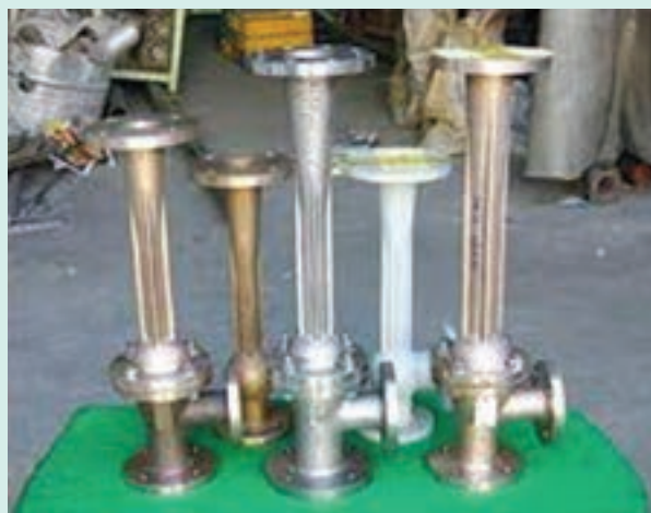
شکل ۲۶-۶- پمپ مکش‌زا
