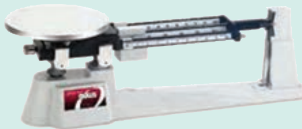
شکل ۲-۵- ترازوی یک کفه‌ای سه اهرمی ۸ (مکانیکی)
