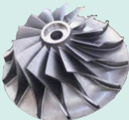
شکل ۶-۶- پروانه نیمه بسته یا نیمه باز
