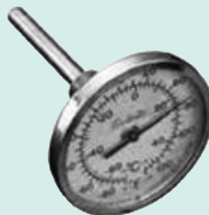
شکل ۱۰-۲- دماسنج بی‌متال
