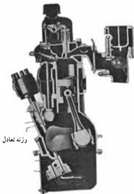
شکل ۲-۶۴- وزنه تعادل میل لنگ در موتور
