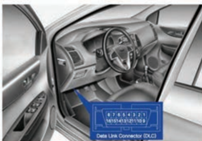
شکل ۵-۳۱- کانکتور عیب یابی (DLC) ۱
