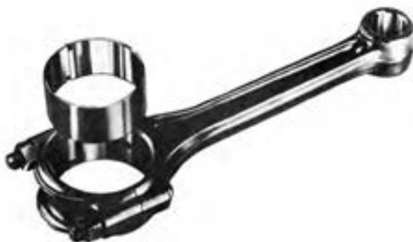
شکل ۲-۵۸- شاتون و ياتاقان آن
