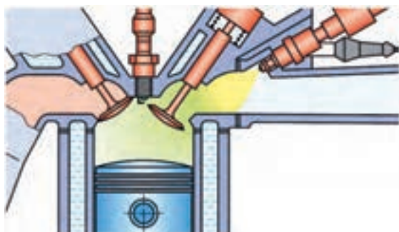
شکل ۳-۲- مخلوط بنزین و هوا به وسیله شمع محترق می‌گردد.
