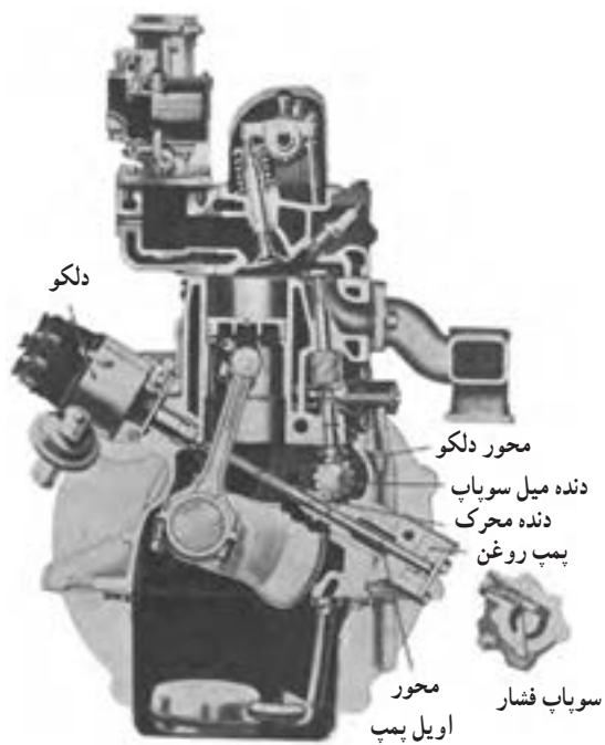
شکل ۱۳-۴- اویل پمپ خارج از موتور قرار داشته و از میل سوپاپ نیرو می گیرد.
