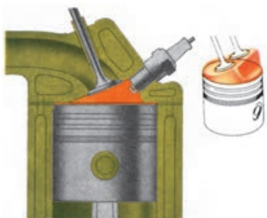
شکل ۱۰-۳- در این فرم اتاق احتراق (گودای شکل)، شعله بهتر پیشروی می‌کند.
