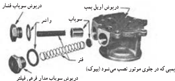
شکل ۲۰-۴- اوایل پمپ که در جلوی موتور نصب می‌شود.
