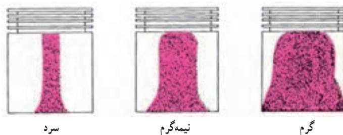
شکل ۲-۳۴- سطوح تماس پیستون بیضی شکل از حالت سرد بودن تا گرم شدن کامل
