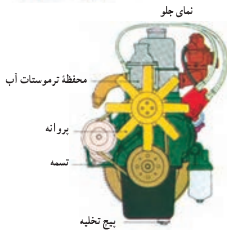
شکل ۱۱-۱ موتور در نماهای مختلف
