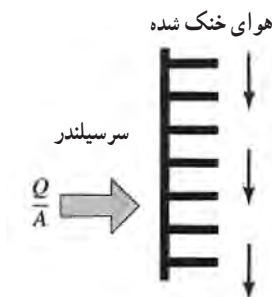
شکل ۳۲-۴ - سیستم خنک کاری با سیال خنک کننده هوا
