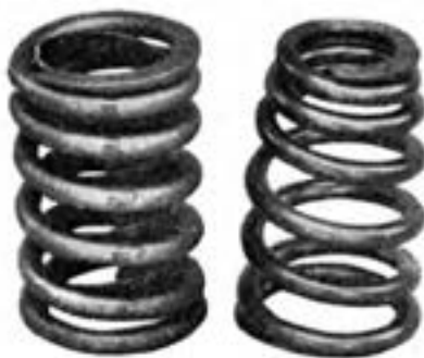
شکل ۱۳-۲- فنر سوپاپ‌ها
