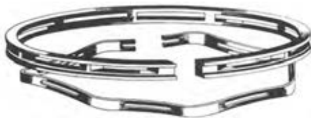
شکل ۴۵-۲- رینگ‌های انبساطی روغنی
