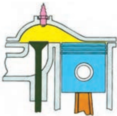
شکل ۹-۲- موتور L شکل
