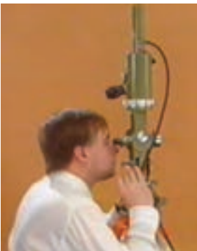
شکل ۱۲-۴- شکل یک ژيروسکوپ که در تونل ها و هدایت آن ها استفاده می شود.
