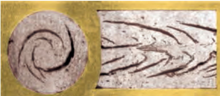
شکل ۲۸-۱- لایه لایه شدن در مقطع گل
