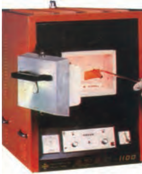
شکل ۶-۶- کوره‌های آزمایشگاهی مافل «تابش غیر مستقیم حرارت به قطعه»
