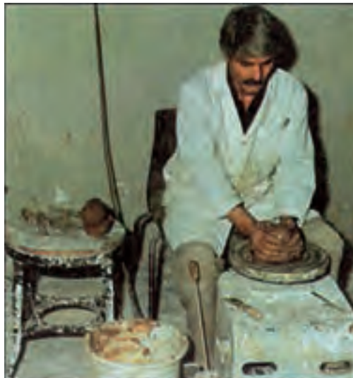
شکل ۴-۱- گل در مرکز چرخ قرار داده می‌شود.
