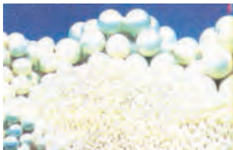
شکل ۶-۳- گلوله‌ها و قطعاتی که به روش CIP ساخته شده‌اند.
