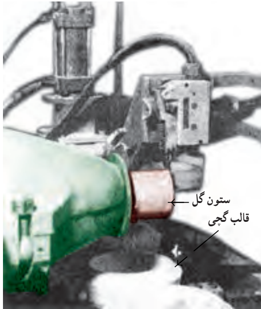
شکل ۲۰-۱- ستون گل خروجی از پاکمیل به اندازه‌ی معین بریده شده و به منظور شکل دادن به قالب هدایت می‌شود.
