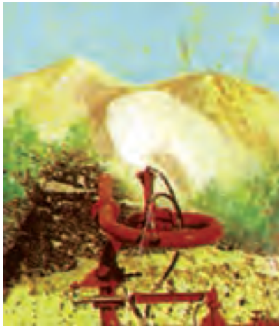
شکل ۱-۳- یک جت آب برای استخراج کائولین
