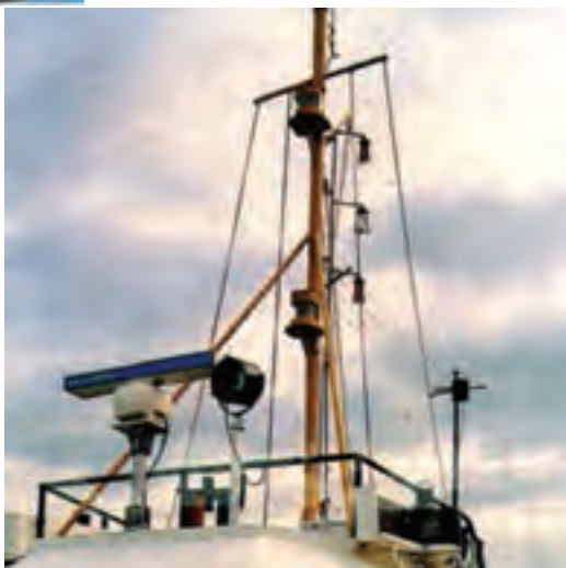
شکل ۴-۱۰ و ۴-۱۱- تصاویری از آنتن رادارهای ناوبری
