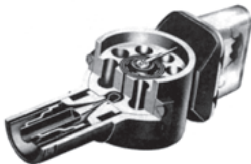
شکل ۳-۴- نمایی از یک مگنترون نوع حفره‌ای
