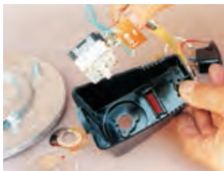
● در شکل ۲۰-۴، تایمر، لامپ خبر و ترمینال دیده می‌شود. مجموعه‌ی موتور و تایمر دو قسمت به هم چسبیده هستند. با گرداندن تایمر کلید روشن خواهد شد و تایمر وارد مدار می‌شود.
