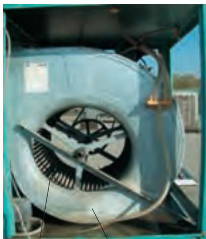
شکل ۸-۹ - محرک گردان کلید گریز از مرکز
