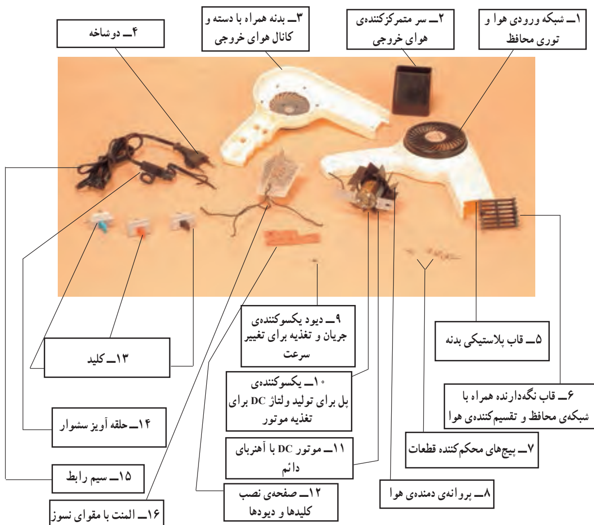
شکل ۴۲-۶ اجزای ساختمانی یک نمونه سشوار
