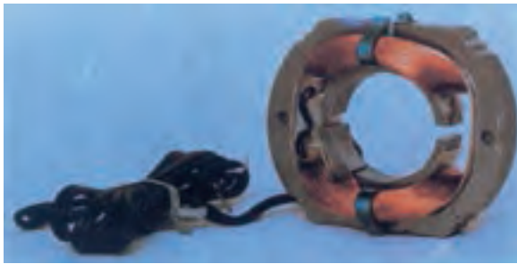
شکل ۸-۱۴ استاتور و هسته پمپ آب
