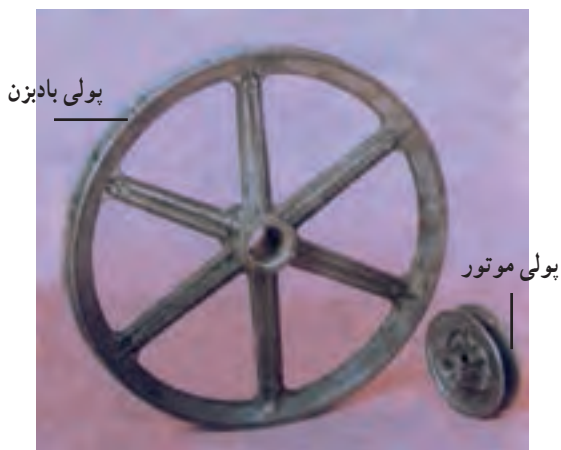
شکل ۸-۱۱ - پولی‌های موتور و فن
