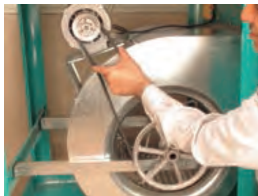
الف- طرز قرار گرفتن تسمه روی پولی‌ها
