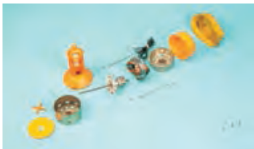
شکل ۸-۱۸ - نمایش ظاهری و اجزای یک واترپمپ
