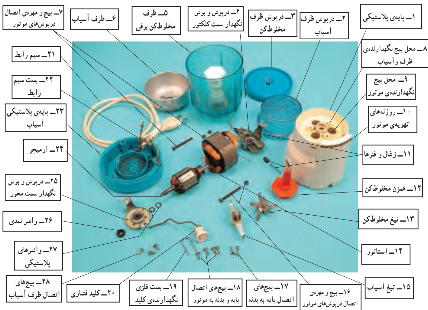
شکل ۴-۳۲- اجزای ساختمانی یک نمونه مخلوط‌کن برقی
