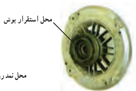
(الف) شکل درپوش با محل استقرار بوش ها
