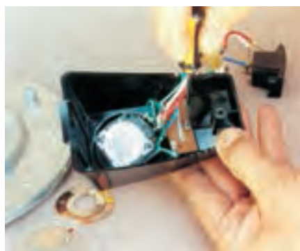
● طبق شکل ۱۹-۴ با یک پیچ گوشتی چهارسو، پیچ روی فیبر چایی لامپ خبر پلویز را باز کنید تا قاب کائوچویی کاملاً آزاد شود.
