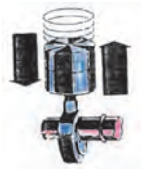
شکل ۹-۴- کمپرسور پیستونی
