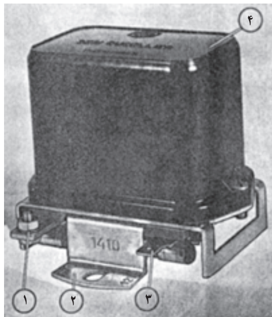
شکل ۱۵-۸ - ساختمان ظاهری تنظیم کننده برق ۱- اتصال DF ۲- اتصال D - ۳- اتصال B + ۴- سرویس
