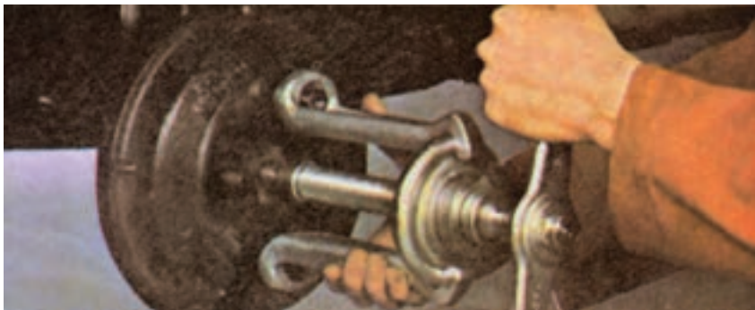
شکل ۱-۳۴- روش درآوردن کاسه چرخ
