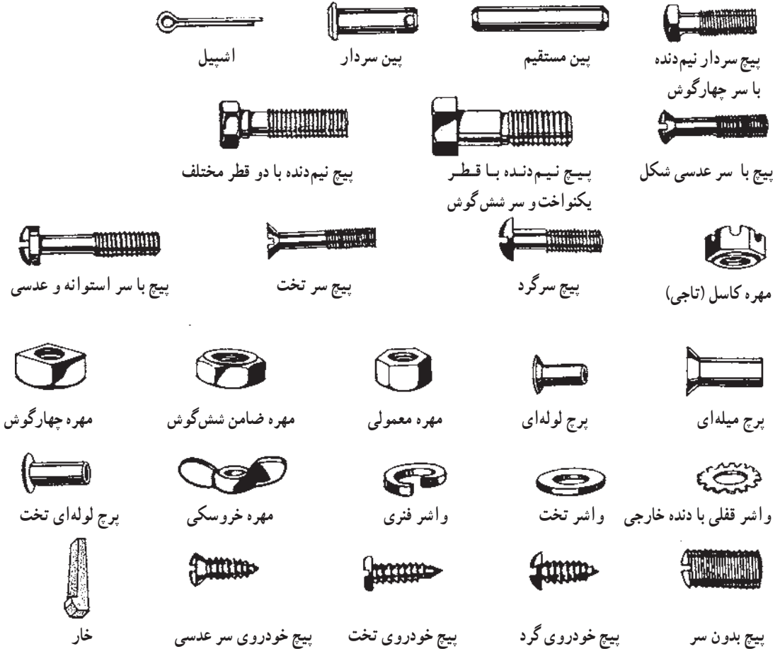
شکل ۱-۴۲- انواع پیچ، مهره و واشر
