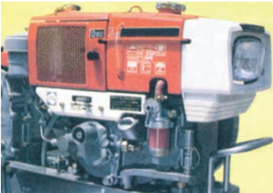
شکل ۹-۱۷- موتور دیزل سبک
