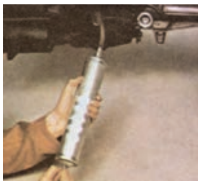
شکل ۳۹-۱- روش پر کردن گیربکس
