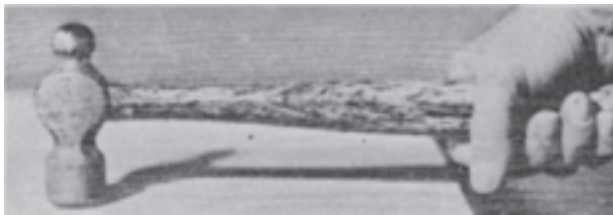
الف - چکش باید به طور کامل با سطح جسم تماس بگیرد
