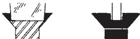
شکل ۱-۱۲- طرز قرار گرفتن صحیح نوک آچار از نظر طول و ضخامت در شیار
