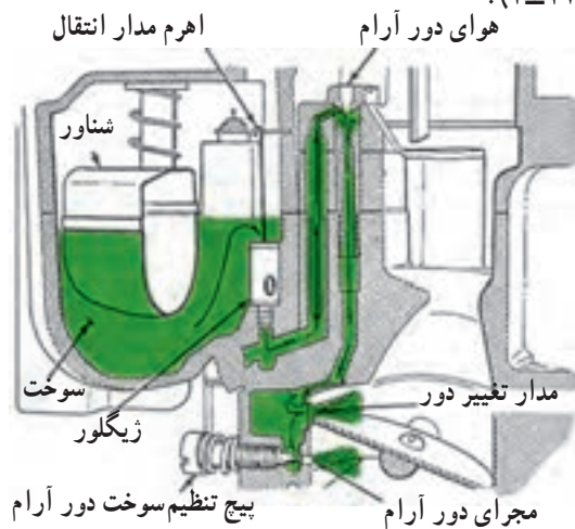
شکل ۴-۱۶- مدار دور آرام
