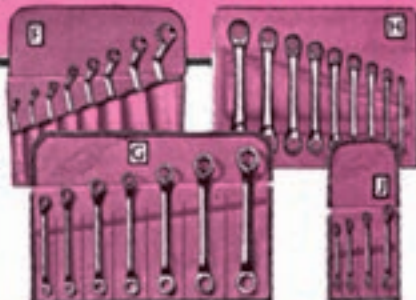
شکل ۴-۱- آچارهای رینگی مختلف
