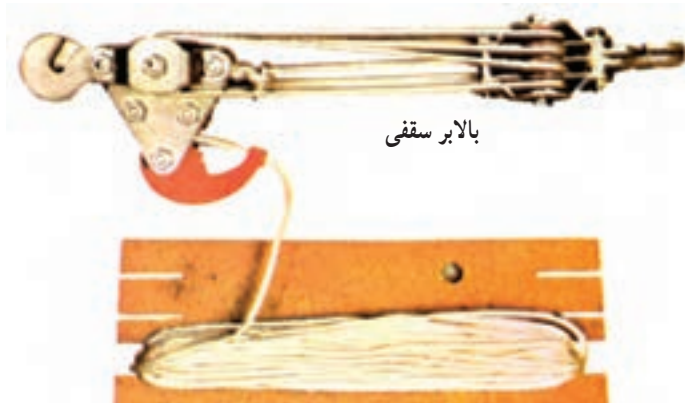
شکل ۱-۳۳- کابل و بالابر سقفی
