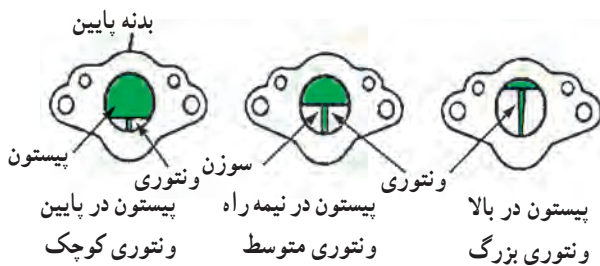
شکل ۹-۹- اجزای کاربراتور و نتوری متغیر
