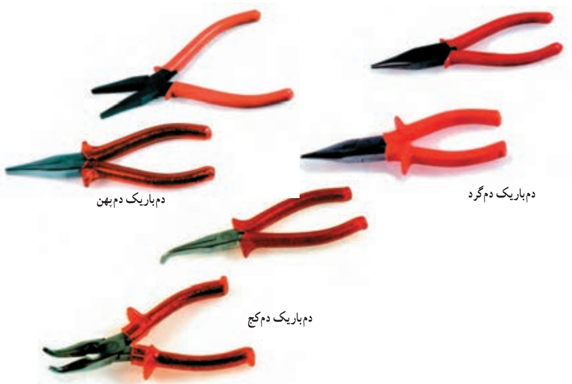
شکل ۲۰-۱- انواع دم باریک
