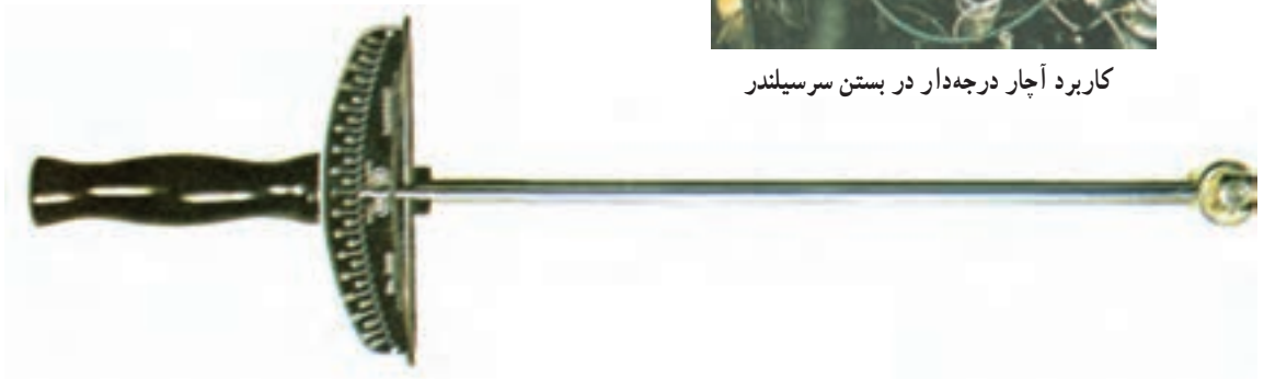
شکل ۸-۱ آچار درجه‌دار و کاربرد آن
