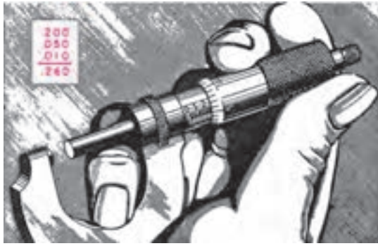
شکل ۵۴-۱ روش به دست گرفتن میکرومتر
