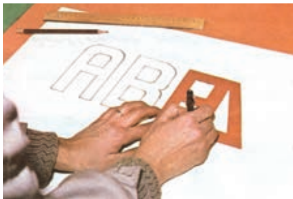
شکل ۳-۱۱ - استفاده از شابلون (قالب)
