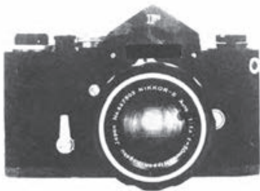
شکل ۴۸-۴- دوربین بازتابی تک لنز
