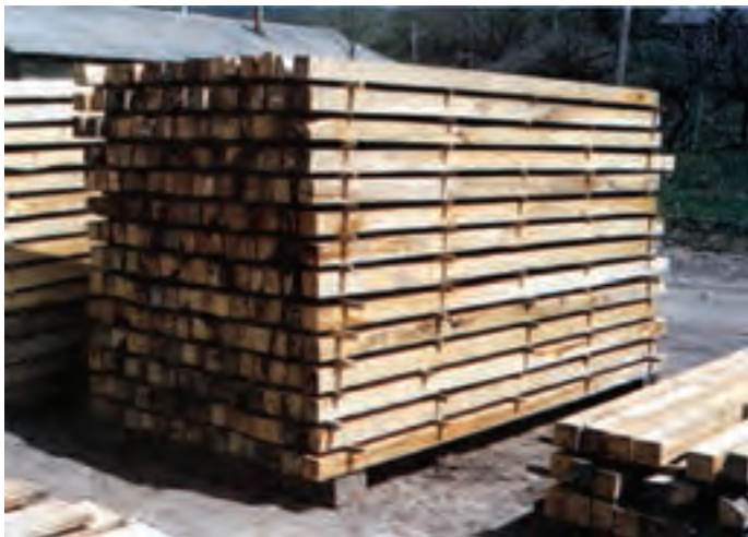
شکل ۱۲-۲- نحوه چوبدستک‌گذاری در یک دسته چوب
