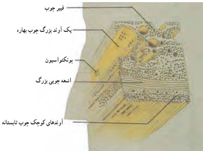
شکل ۱-۱- ساختمان سه‌بعدی قطعه‌ای از چوب بلوط
