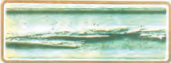
اثر تخریب این نوع سوسک‌ها در چوب پهن‌برگ
