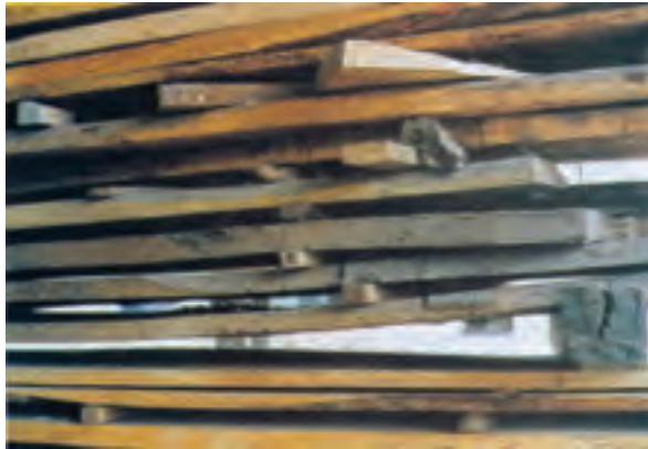
شکل ۱۳-۲- وجود یک چوبدستک ضخیم تر به کج شدن تخته ها می انجامد.
