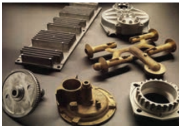
شکل ۳-۷- قطعات ریخته گری تحت فشار روی
