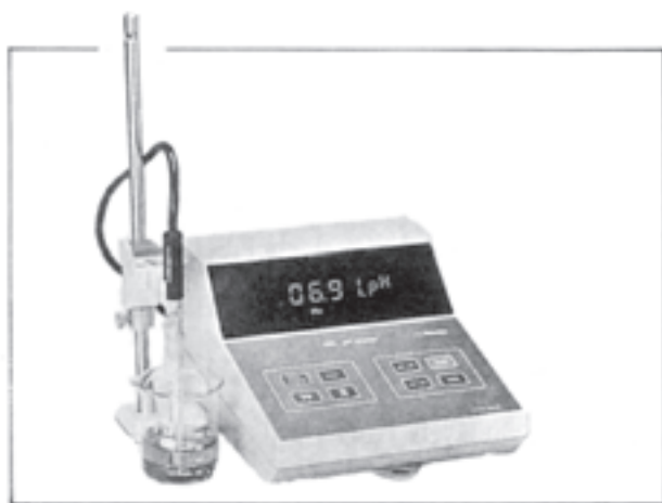
شکل ۲-۱۵- دو نوع pH سنج با دقت \pm 0.1 pH
