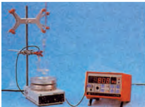
شکل ۴-۱۵- اندازه‌گیری pH به وسیله‌ی دستگاه pH سنج
