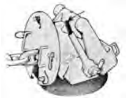
شکل ۲-۳۳- کمپرسور دهانه لوله عبور زنجیر از چاه
