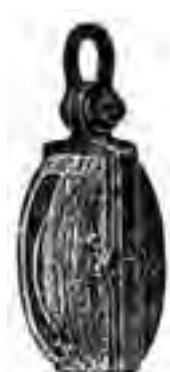
External Bound Block شکل ۲-۴- قرقه چوبی با تسمه فلزی خارجی
