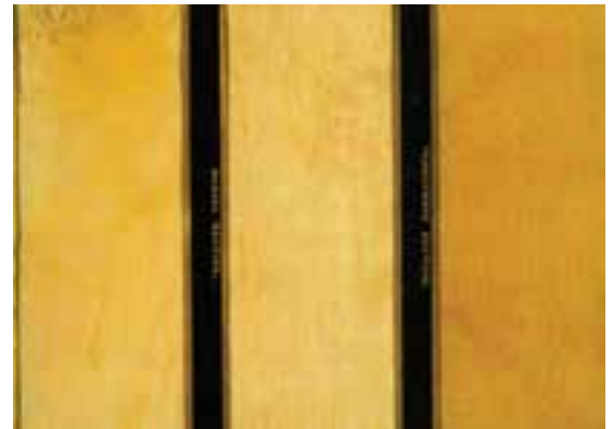
شکل ۱۰-۳۲ برش‌های عرضی، شعاعی و مماسی چوب ممرز.
