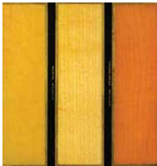
شکل ۱۰-۲۹ برش های عرضی، شعاعی و مماسی چوب توسکا.
