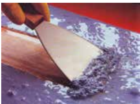
شکل ۱۱-۱۳- برداشتن رنگ از سطح کار به روش شیمیایی.
