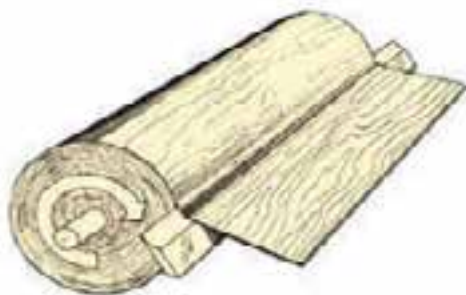
شکل ۱۰-۴۶ تهیهی روکش به روش لوله‌بری.
