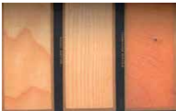
شکل ۱۰-۲۳ چوب نراد در سه برش عرضی، شعاعی، مماسی.
