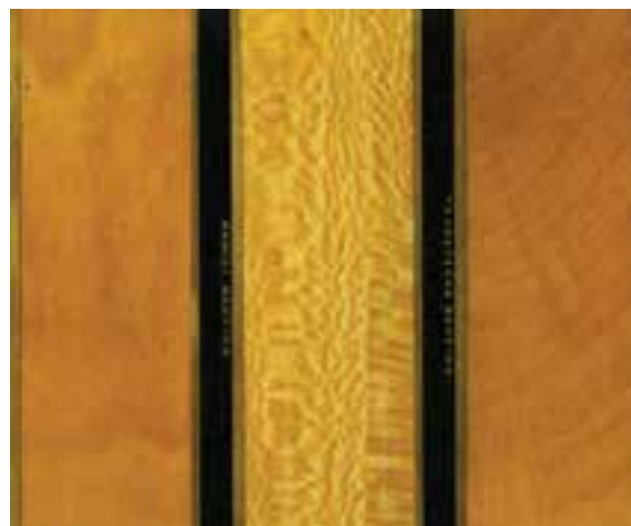
شکل ۲۵-۱۰ چوب چنار در سه برش عرضی، شعاعی، مماسی.
