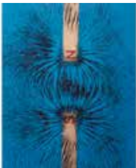
(پ) دو آهنربای میله‌ای که قطب‌های غیرهمانسان نزدیک یک‌دیگر است.
