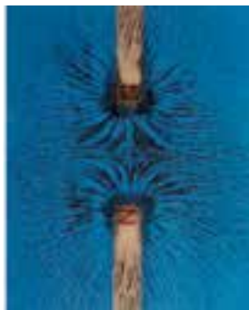
(ب) دو آهنربای میله‌ای که قطب‌های همانسان نزدیک یک‌دیگر است.
