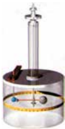
شکل ۲-۲۰- ترازوی پیچشی کولن
