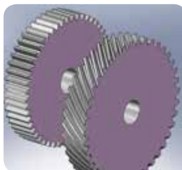
تفاوت دنده چرخ‌دنده ساده و مارپیچ
