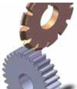
نمایش تیغه فرز مدولی و قطعه کار
