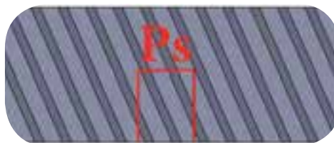
معرفی گام ظاهری در چرخ‌دنده شانه‌ای مایل
