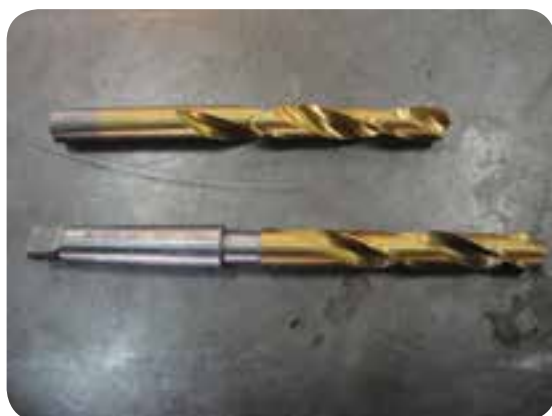
دنباله استوانه‌ای و مخروطی در مته‌ها
