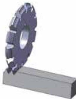
تراشیدن دنده شانه‌ای بوسیله ماشین فرز افقی و عمودی
