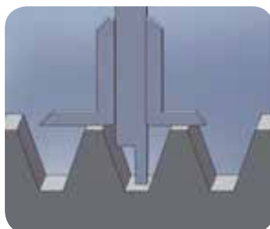
نحوه استفاده از کولیس عمق سنج
