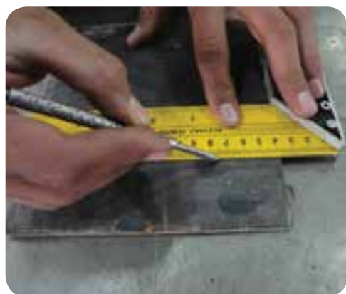
روش ترسیم خط به کمک گونهای ساده و سوزن خطکش
