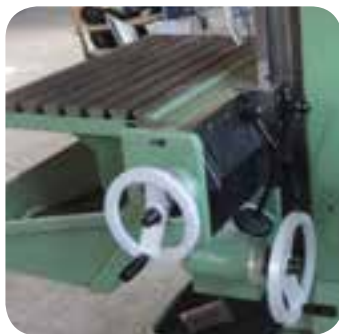
مکانیزم جابجایی میز ماشین
