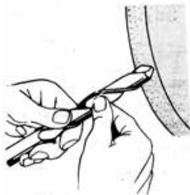
تیز کردن مته با دست و سنگ دو طرفه
