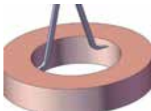
انتقال اندازه قطر سوراخ با پرگار پاشنه
