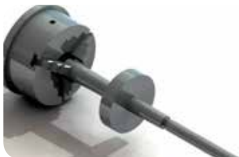
سوار کردن درن بر روی دستگاه تقسیم
