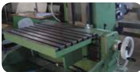
میز ماشین فرز و سیستم حرکتی آن
