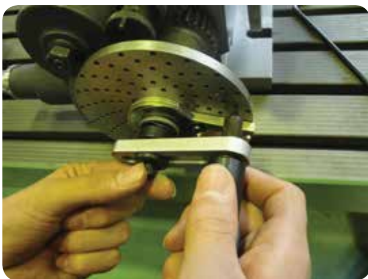
صفحه سوراخ‌دار و قیچی نصب بر روی دستگاه تقسیم
