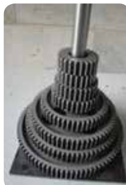
سری چرخ‌دنده تعویضی استاندارد
