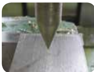
مشخص کردن محل دقیق سوراخ کاری به کمک یک میله راهنما
