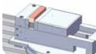
بستن قطعه کار در گیره به طور صحیح
