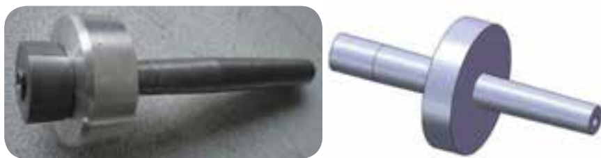
سوار کردن قطعه بر روی محور مخروطی
