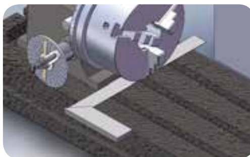
نصب صحیح دستگاه تقسیم بر روی میز ماشین
