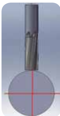
نحوه قرار گیری ابزار نسبت به قطعه کار در مارپیچ تراشی
