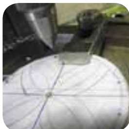
بستن قطعه با روپند بر روی میز گردان
