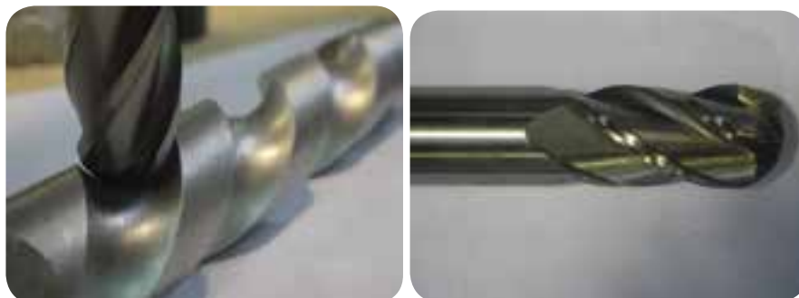
استفاده از تیغه فرز انگشتی سر کروی برای ایجاد شیار مارپیچ
