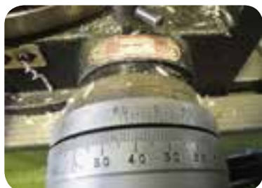
حلقه مدرج دستگیره میزگردان برای جابجایی دقیق‌تر
