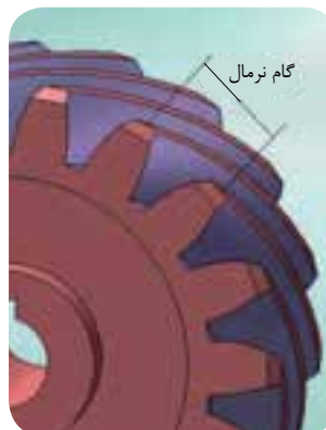
نمایشی گام نرمال در چرخ‌دنده مارپیچ
