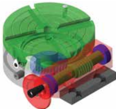
نمایش سیستم داخلی میزگردان
