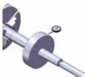
کنترل دور بودن قطعه با ساعت اندازه‌گیری
