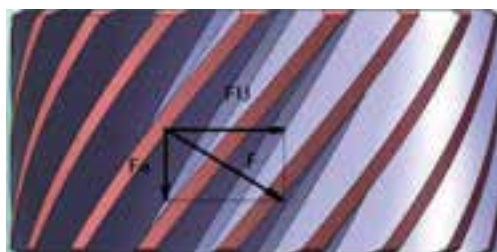
تجزیه نیروها در چرخ‌دنده مارپیچ
