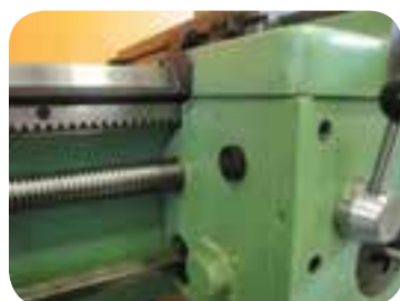
کاربرد چرخ و شانه در ماشین‌های تراش
