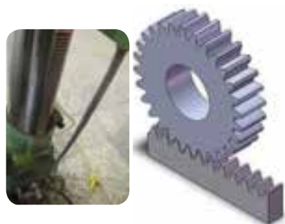
کاربرد چرخ و شانه در ماشین‌های مته
