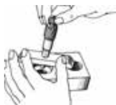
کنترل عمق سوراخ با استفاده از میکرومتر
