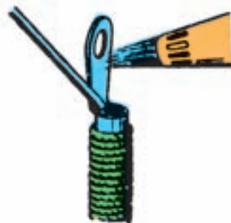
شکل ۲۲-۲- مراحل لحیم کاری کابل شو
