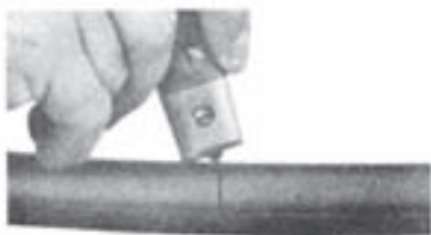
شکل ۲۱-۲- عایق برداری
