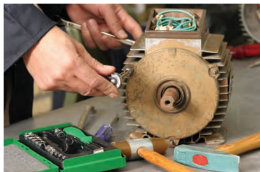
الف - باز کردن پیچ‌های موتور
