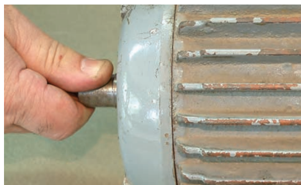
شکل ۳۰-۶ — آزمایش لنگی (لقی) بوش ها یا بلبرینگ ها
