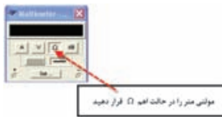
شکل ۶-۱۹ قرار دادن مولتی متر در حالت اهم
