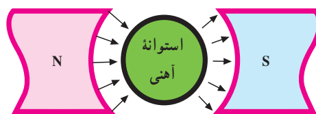
شکل ۵-۳ چگونگی ایجاد میدان مغناطیسی یکنواخت و شعاعی
