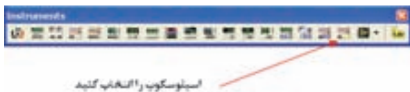
شکل ۳۳-۶- انتخاب دستگاه اسیلوسکوپ از نوار ابزار
