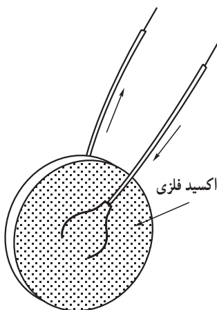
شکل ۱-۳۲- یک نمونه ترمیستور
