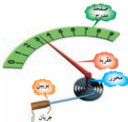
شکل ۳۲-۵- دستگاه اندازه‌گیری با هسته متحرک
