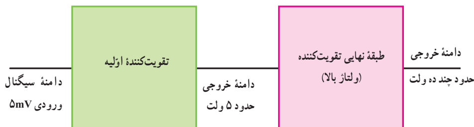
شکل ۲۰-۴ تقویت کننده های اسیلوسکوپ
