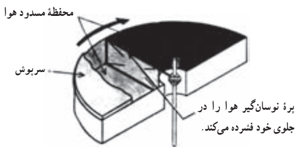
شکل ۵-۳۵- حرکت محور باعث گردش عقربه و پره می‌شود. به تدریج که هوا در قسمت جلوی محفظه فشرده می‌شود عقربه با مانع برخورد می‌کند. این موضوع باعث کند شدن عقربه و در نتیجه کاهش نوسانات می‌شود.
