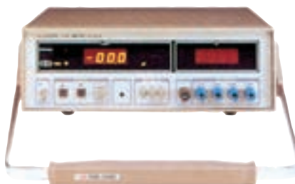
شکل ۲-۳۳ نمونه‌ای از پل دیجیتالی
