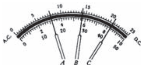
شکل ۲-۱۷ حدود اندازه‌گیری (ضریب کلید رنج) روی عدد ۲۵۰ قرار دارد.
