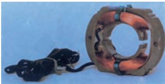
شکل ۸-۱۴ استاتور و هسته پمپ آب
