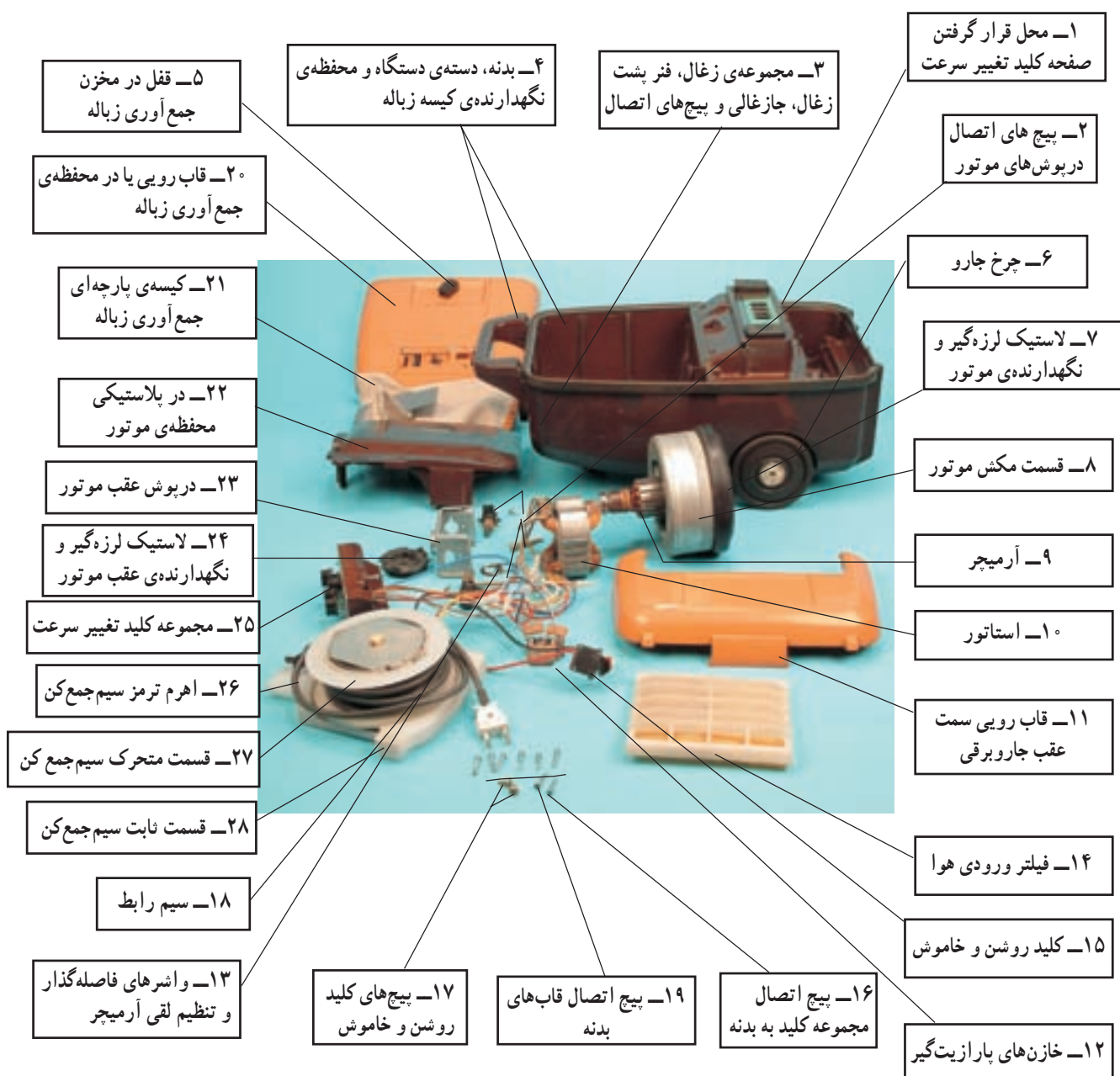
شکل ۲-۵۲ - اجزای ساختمانی یک نمونه جارو برقی
