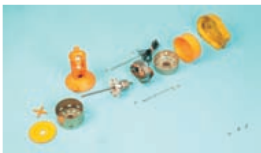
شکل ۸-۱۸ - نمایش ظاهری و اجزای یک واترپمپ
