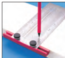
شکل ۱-۳۴ قرقه‌های متصل کننده‌ی خط کش به میز
