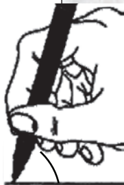
شکل ۳-۱۳ زاویه ی قلم کمتر از ۸۰ درجه نباشد.
