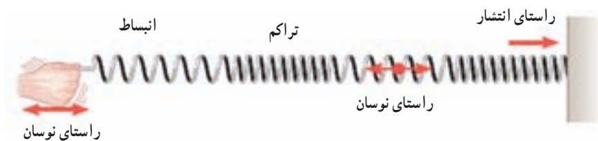
شکل ۱۰-۴- انتشار موج طولی در فنر
