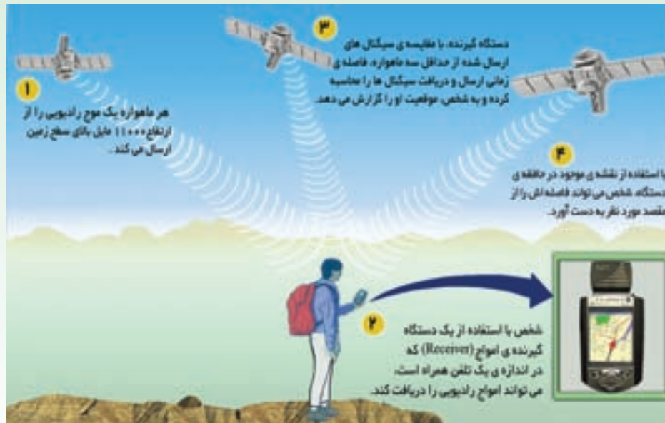
شکل ۵-۵- راه‌یابی با کمک GPS
