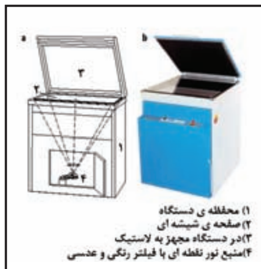
شکل ۳-۶۲- a: تصویر شماتیک، b: تصویر واقعی
