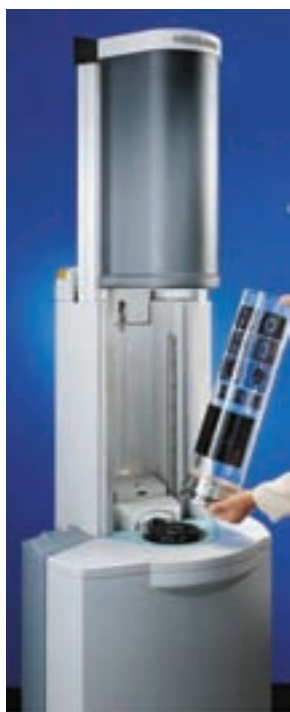
شکل ۱۴-۱- دستگاه اسکنر درام استوانه‌ای برای ثبت تصاویر
