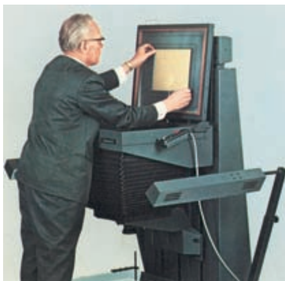
شکل ۳-۵۵- قرار دادن فیلم خام بر روی صفحه‌ی مکنده
