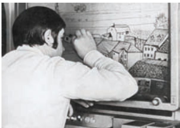
شکل ۳-۵۳- تصویر بر روی شیشه‌ی مات کنترل می‌شود.
