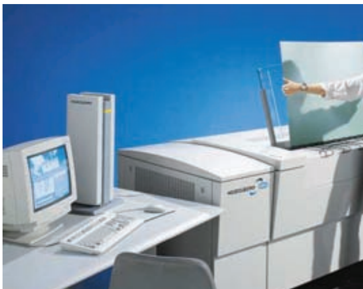
شکل ۱-۱۹- سیستم کامپیوتر به پلیت دیجیتالی برای نوردهی پلیت
