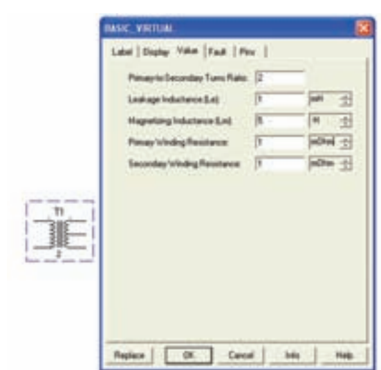
شکل ۱-۴۳ تنظیم نسبت ترانسفورماتور
