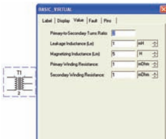
شکل ۱۱-۳ صفحه‌ی تنظیمات ترانسفورماتور
