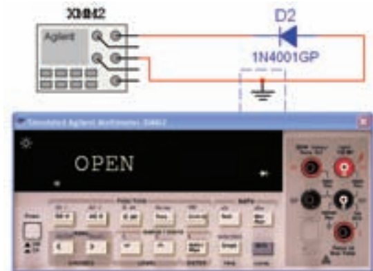
شکل ۲-۲۲ آزمایش دیود در بایاس مخالف
