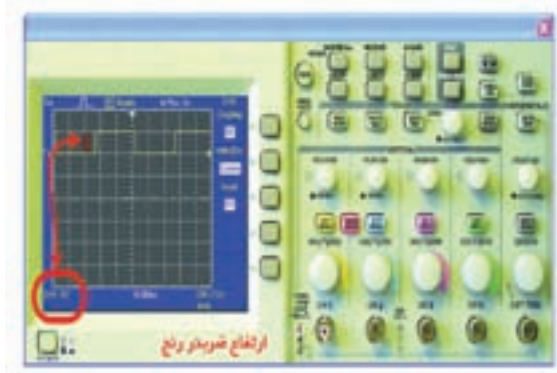
شکل ۲-۱۰۳ اندازه‌گیری ولتاژ پیک تا پیک
