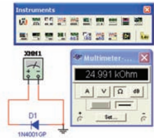
شکل ۱۷-۲ مقاومت دیود در بایاس مخالف
