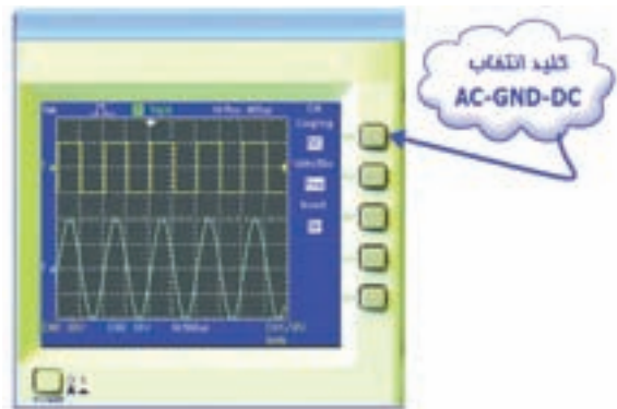
شکل ۲-۹۴ کلید انتخاب ورودی AC-GND-DC
