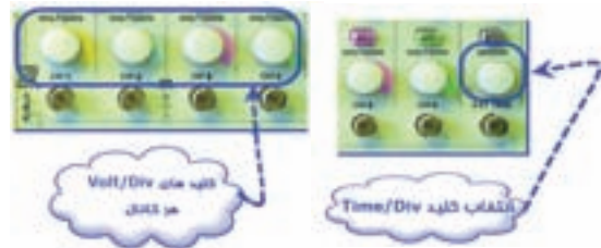
شکل ۲-۹۳ کلیدهای انتخاب Volt/Div و کلید Time/Div
