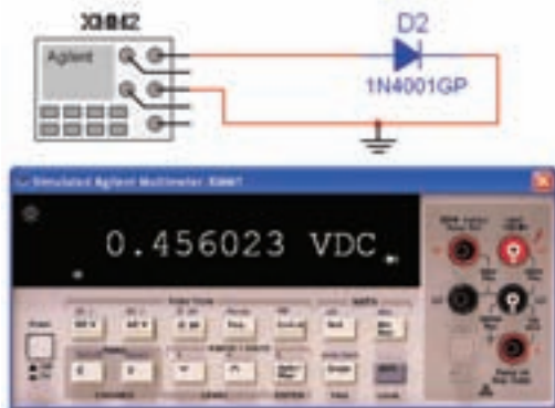
شکل ۲۱-۲ آزمایش دیود در بایاس موافق
