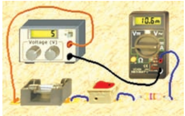
شکل ۶-۱ تغییر مقاومت در نرم‌افزار ادیسون و بررسی قانون اهم
