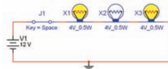
شکل ۱-۱۶ تاثیر اتصال کوتاه یک لامپ در مدار سری
