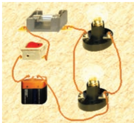
شکل ۱-۵۱ مدار عملی دو لامپ با فیوز و کلید
