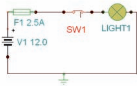
شکل ۱-۲۲ نقشه‌ی فنی یک مدار ساده
