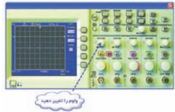
شکل ۲-۱۰۲ تغییر مکان عمودی خط GND
