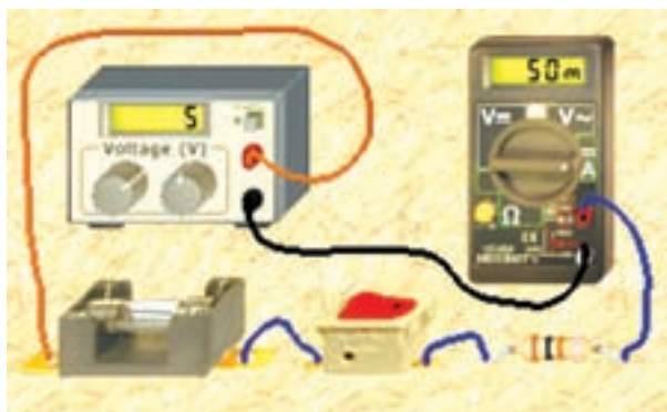
شکل ۳-۱ اندازه‌گیری جریان در یک مدار ساده با استفاده از قانون اهم
