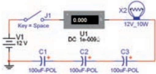
شکل ۸-۵ جریان عبوری از مدار خازن‌های سری
