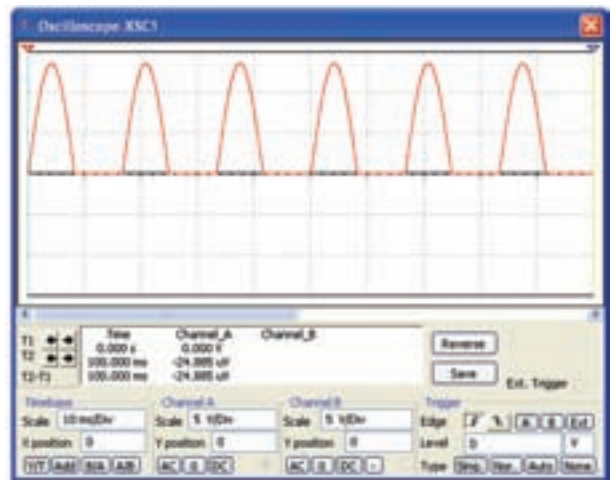
شکل ۳-۴ مدار و شکل موج یکسوساز نیم‌موج
