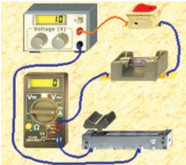
شکل ۱-۱۳ در مدار پتانسیومتر فیوز سوخته است
