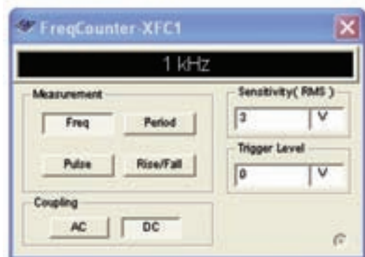
شکل ۶-۶ استفاده از فرکانس متر در اندازه‌گیری فرکانس
