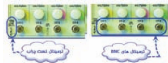
شکل ۲-۹۲ ترمینال تست پراب و کانال‌های ورودی دستگاه
