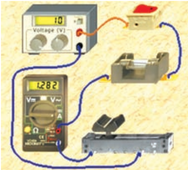
شکل ۱-۱۲ تغییر مقدار مقاومت و اثر آن روی مقدار جریان
