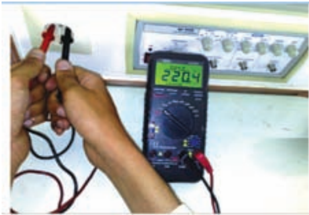
شکل ۲-۷۹ اندازه‌گیری ولتاژ برق شهر
