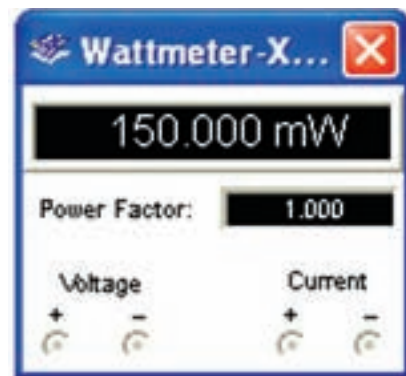
شکل ۴-۸ اندازه‌گیری توان در یکی از شاخه‌های مدار موازی
