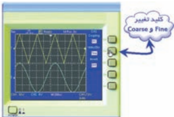
شکل ۲-۱۰۸ انتخاب کلید FINE برای تنظیم دقیق‌تر دامنه
