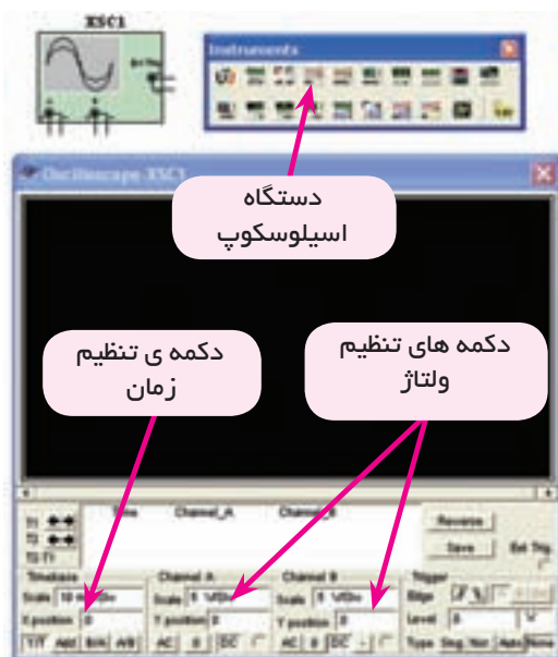
شکل ۱-۲۰ اسیلوسکوپ و دکمه‌های تنظیمات
