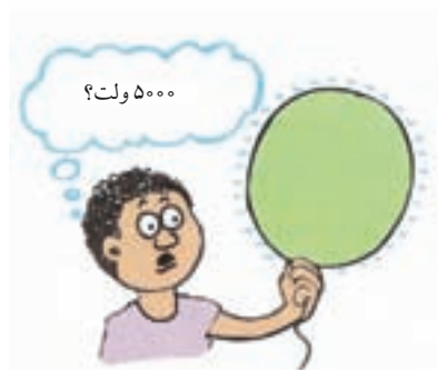
شکل ۲-۲۴ مالش بادکنک با موی سر، ولتاژ آن را ممکن است تا چندین هزار ولت افزایش دهد.
