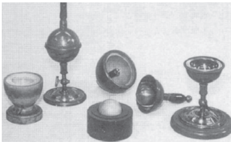
شکل ۸-۱۱ وسایل ساده‌ای که فارادی در سال ۱۸۳۷ میلادی برای بررسی اثر دی الکتریک در ظرفیت خازن‌ها از آن‌ها استفاده کرده است.
