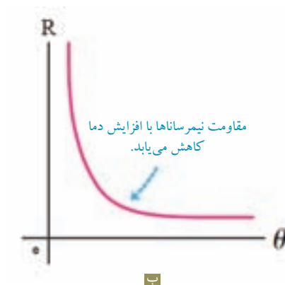
شکل ۷-۴ (الف) مقاومت رساناها با افزایش دما، بیش‌تر می‌شود. (ب) مقاومت نیمرساناها با افزایش دما کاهش می‌یابد.
