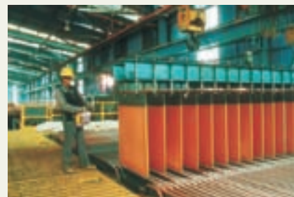
شکل ۳-۸ آبکاری ورقه‌های فلزی
