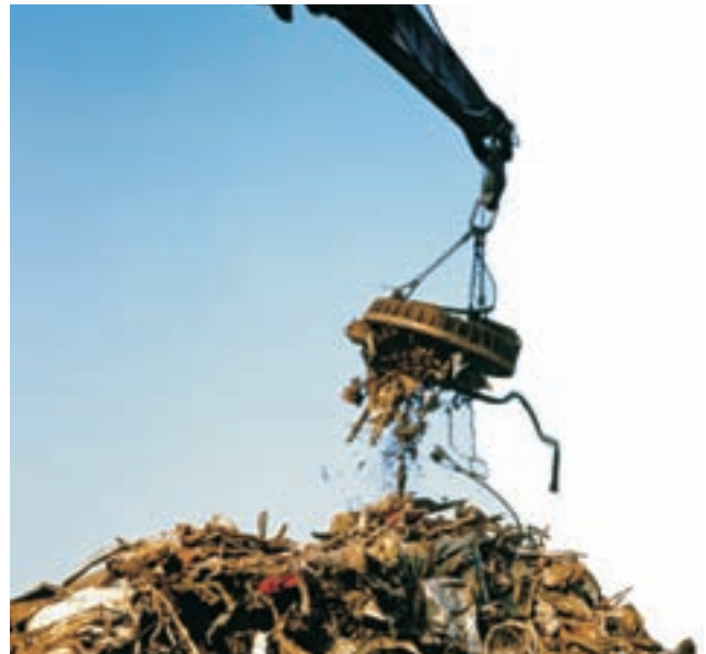
شکل ۱۰-۲۸ (الف) یک آهنربای الکتریکی صنعتی. (ب) یک آهنربای الکتریکی ساده.
