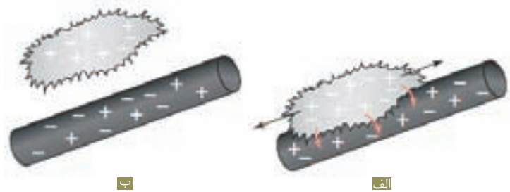
شکل ۲-۱۹ گرمای حاصل از مالش دو جسم به یکدیگر، الکترون‌ها را از اتم‌های یک جسم جدا و به جسم دیگر منتقل می‌کند.
