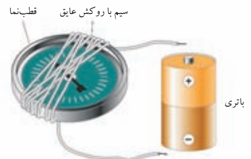
شکل ۱۰-۳۵ گالوانومتر ساده با اتصال دو سیم به باتری، حرکت عقربه‌ی قطب‌نما، عبور جریان از سیم را آشکار می‌کند.
