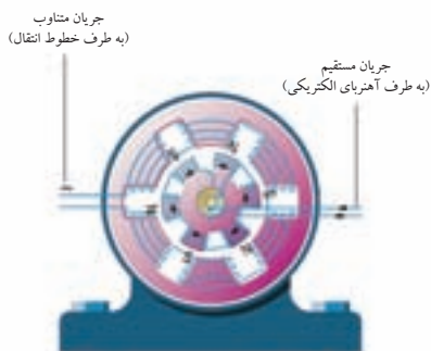
شکل ۱۲-۲۲ (الف) در مولدهای صنعتی، با چرخیدن آهنربای الکتریکی بین پیچ‌ها، جریان متناوب تولید می‌شود (ب) نمایی از مولدهای صنعتی تولید برق.
