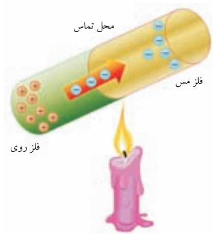
شکل ۲-۲۱ گرما سبب اختلاف پتانسیل دو سر تماس رساناها و در نتیجه شارش الکترون‌ها می‌شود.
