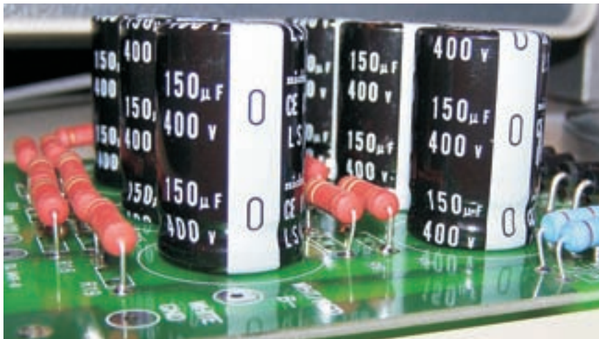
شکل ۸-۲ خازن در یک مدار الکترونیکی
