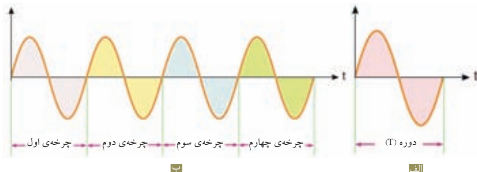
شکل ۶-۱۲ (الف) زمان یک چرخه‌ی کامل، برابر دوره‌ی تناوب موج است. (ب) دوره‌ی تناوب در هر چرخه‌ی یک موج سینوسی یکسان است.
