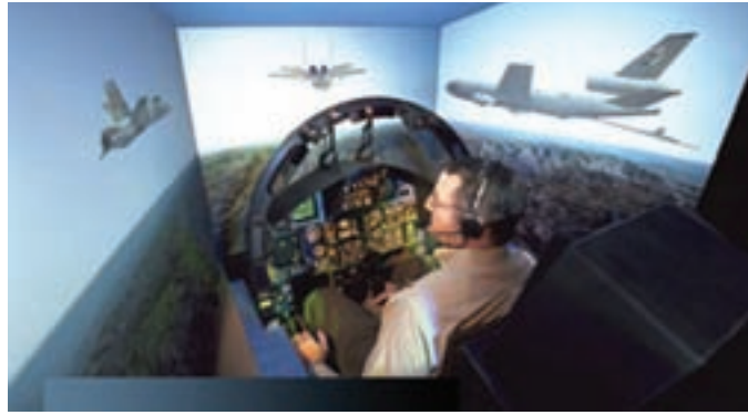
شکل ۳-۱۰- واقعیت مجازی - با حرکت فرد به سمت چپ و راست، دید سه بعدی او به دو طرف متمایل می شود.
