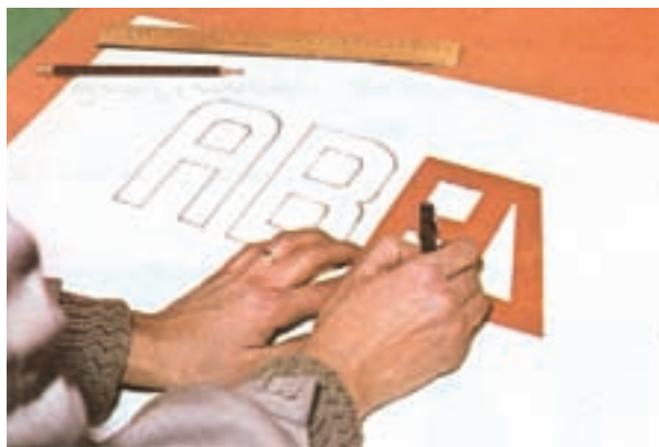
شکل ۳-۱۱ - استفاده از شابلون (قالب)
