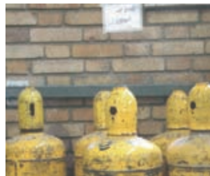
شکل ۱۱-۳ انبار کردن درست کپسول
