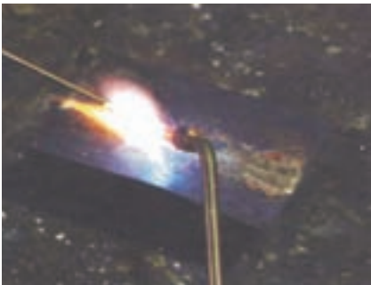
شکل ۶-۱۸ ایجاد گاز در اطراف محل لحیم کاری
