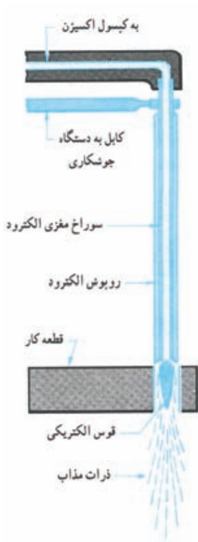
چگونگی برش قوسی با اکسیژن
