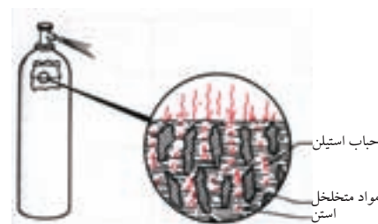
شکل ۲-۵ فضای داخل کپسول استیلن
