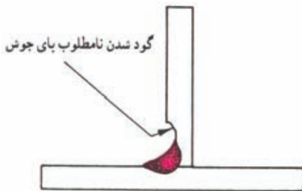
شکل ۸-۶۸ جوش سپری در حالتی که جوش دارای خوردگی است، نشان داده شده است
