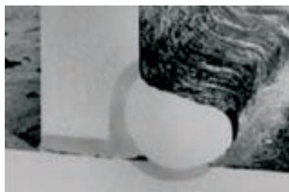
شکل ۴-۹ سرفتگی جوش ماهیچه‌ای
