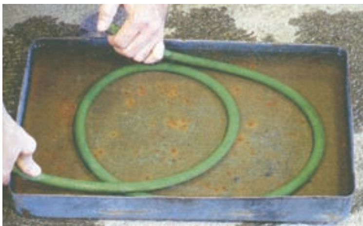
شکل ۸-۸-۱ کنترل سلامت شیلنگ‌ها
