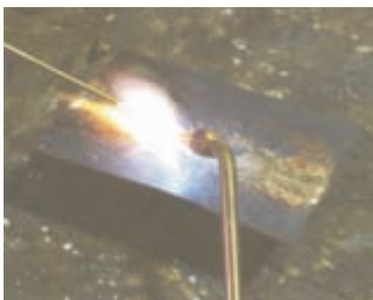
شکل ۶-۱۴ ایجاد گاز در اطراف محل لحیم کاری
