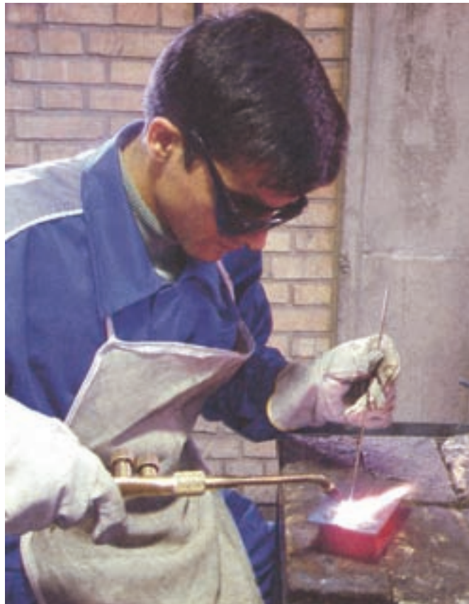
شکل ۸-۴۱ جوشکار در حال جوشکاری با سیم جوش
