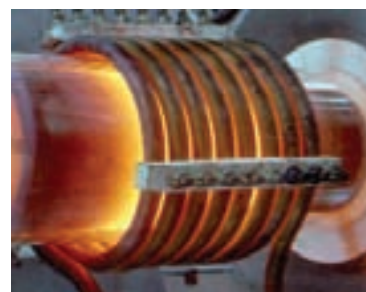
شکل ۲-۵۰ سختی سطحی به روش القایی
