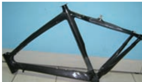
شکل ۱-۱۸ بدنه یک دوچرخه از الیاف کربن
