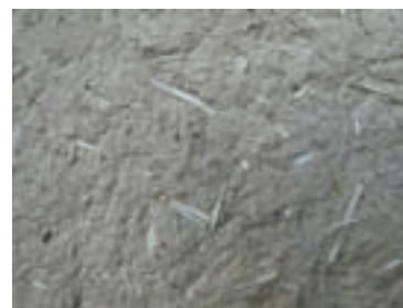
شکل ۱-۱۵ الیاف شیشه در زمینه پلیمری خاص
