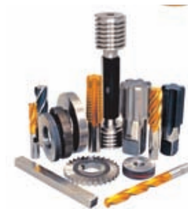
شکل ۴۰-۲ ابزارهای برش از فولادهای ابزار ساخته می شود که بیشتر از فولادهای ابزارهای سردکار هستند.
