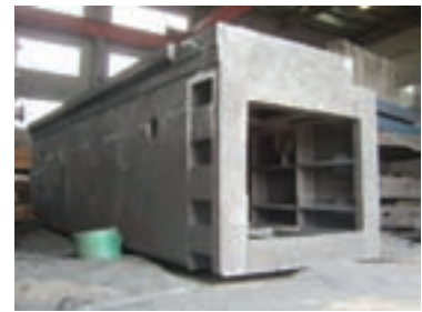
شکل ۲-۵۴ پایه یک ماشین‌ابزار از جنس چدن خاکستری
