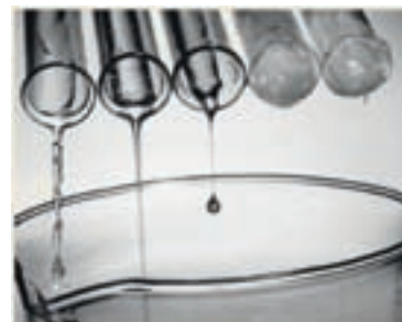
شکل ۳-۵ مقایسه ویسکوزیته چند مایع
