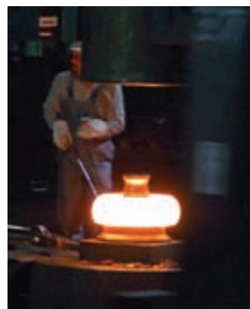
شکل ۳۹-۲ یکی از کاربردهای مهم فولادهای گرم کار بر فرایند فورج (آهنگری) است.
