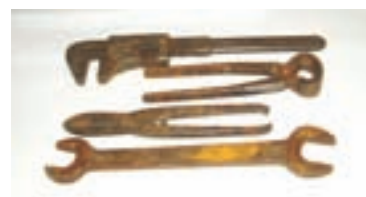
شکل ۱-۵۰ آثار خوردگی بر سطح ابزار فوق‌نشان‌دهنده حساسیت آهن به آب و هوای مرطوب است.
