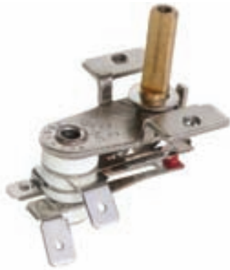
شکل ۱-۴۶ یک نوع ترموستات را نشان می‌دهد. ورقه‌های فلزی با جنس‌های مختلف و ضریب انبساط حرارتی مختلف اساس کار این وسیله است.
