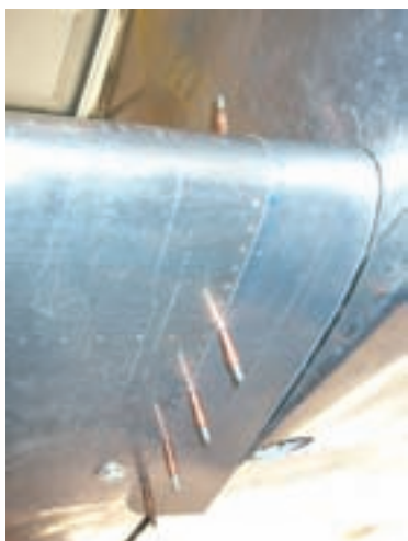
شکل ۳-۴۷ پرچکاری بال هواپیما
