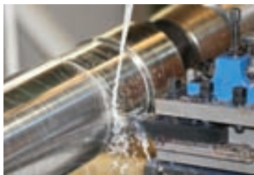
قطعه در حال تراش بدون براده‌برداری
