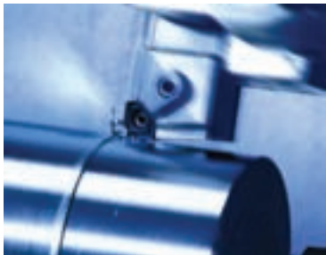
شکل ۴۲-۱ به دلیل سختی کاربردها از آن‌ها برای براده‌برداری از فلزات استفاده می‌شود.
