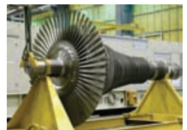
شکل ۲-۳۵ کاربرد فولادهای نسوز در تولید توربین‌های گازی
