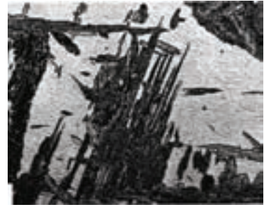
شکل ۲-۴۴ ساختار سوزنی در حقیقت ساختار مارتنزیت است که در طی آن اتم‌های کربن در کریستال‌های تغییر ساختار داده آهن به دام افتاده‌اند.
