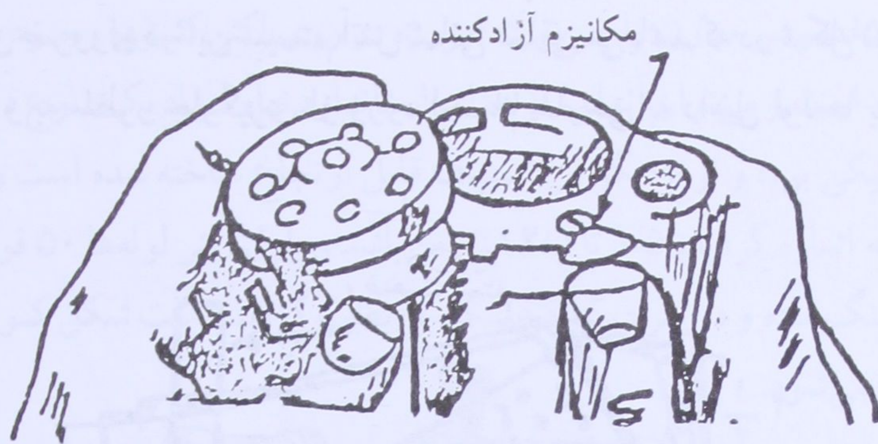
شکل ۶ - ۶ برداشتن درپوش نازل سرعت زیاد
