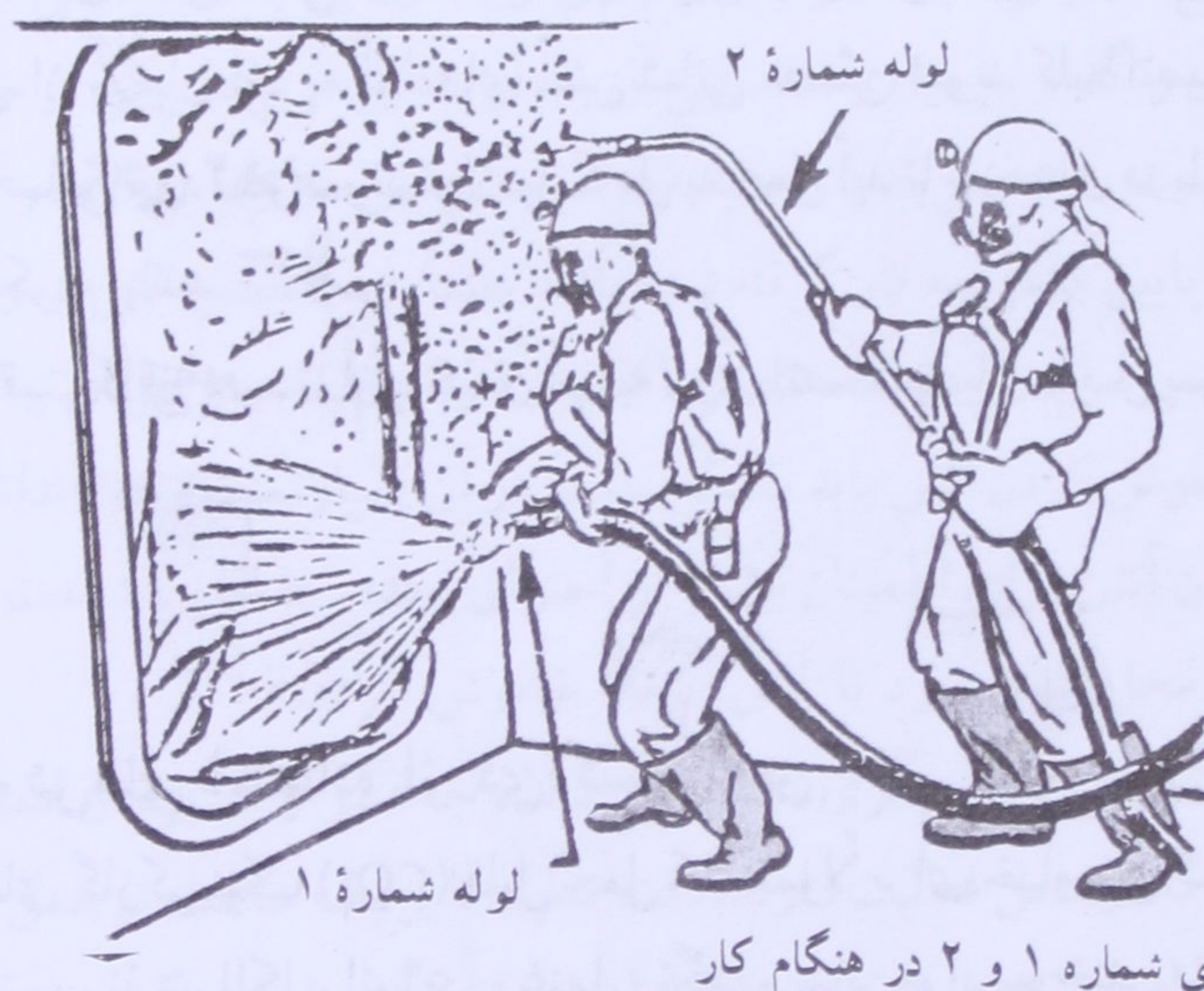
لوله های شماره ۱ و ۲ در هنگام کار شکل ۹ - ۶ نحوه عمل لوله
