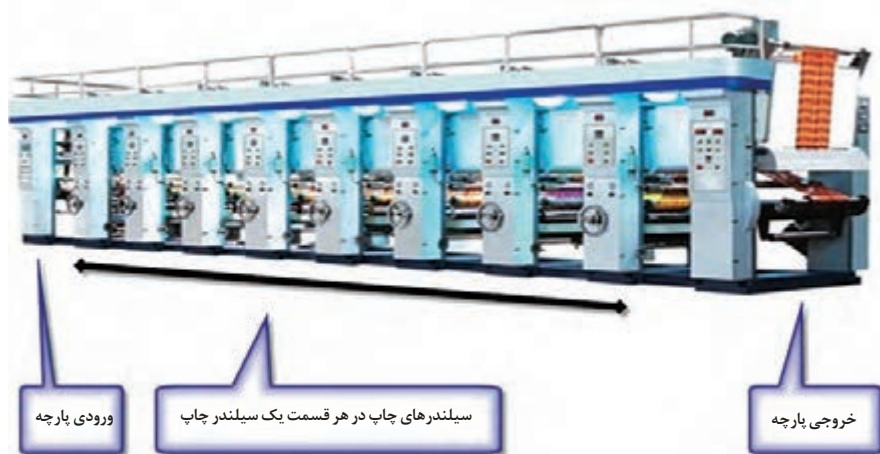
شکل ۸- نمای عملکرد ماشین چاپ غلتکی افقی
