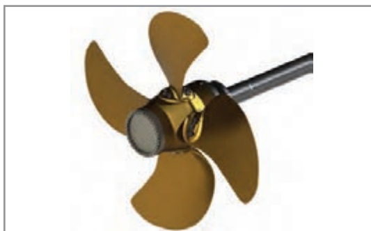
شکل ۳- پروانه گام متغیر
