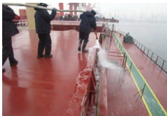
شکل ۵- آزمایش نفوذناپذیری درِ انبار در برابر آب
