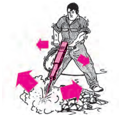
شکل ۳- عوارض ناشی از ارتعاش
