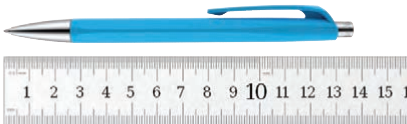
شکل ۳- اندازه‌گیری طول یک قطعه با خط‌کش فلزی
