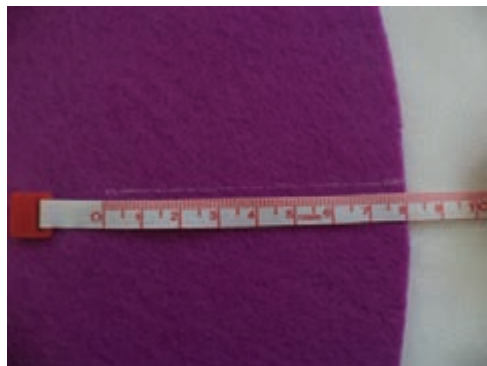
شکل ۴- تأثیر زاویه دید بر خواندن صحیح مقیاس متر نواری
