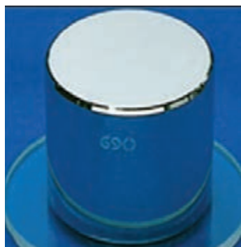
شکل ۱- استاندارد فلزی کیلوگرم از جنس پلاتین - ایریدیوم (جرم آن معادل ۱ کیلوگرم)
