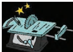
شکل ۳۲- نبود حفاظ در محل‌های متحرک دستگاه
