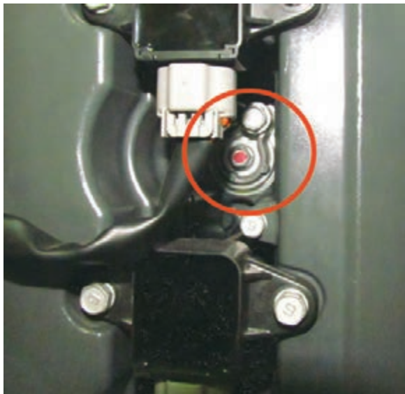
شکل ۳۵- یک نمونه از آند فدا شونده
