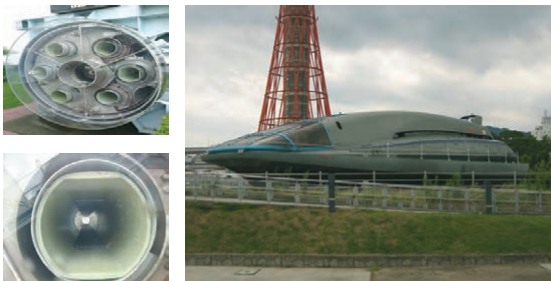
شکل ۳- کشتی رانش مغناطیسی یاماموتو (Yamato)
