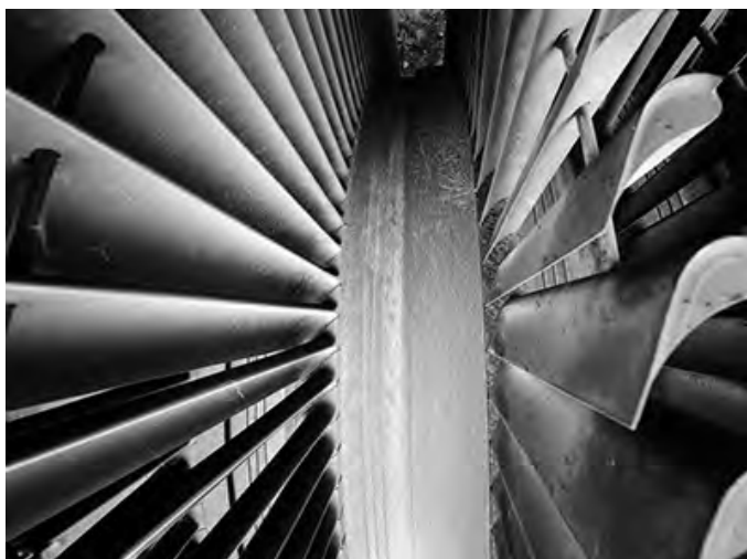
شکل ۸- میله‌های عبور کننده از داخل پره‌ها
