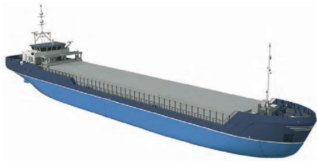
شکل ۱۰- سطح خیس شده شناور (ناحیه آبی‌رنگ)
