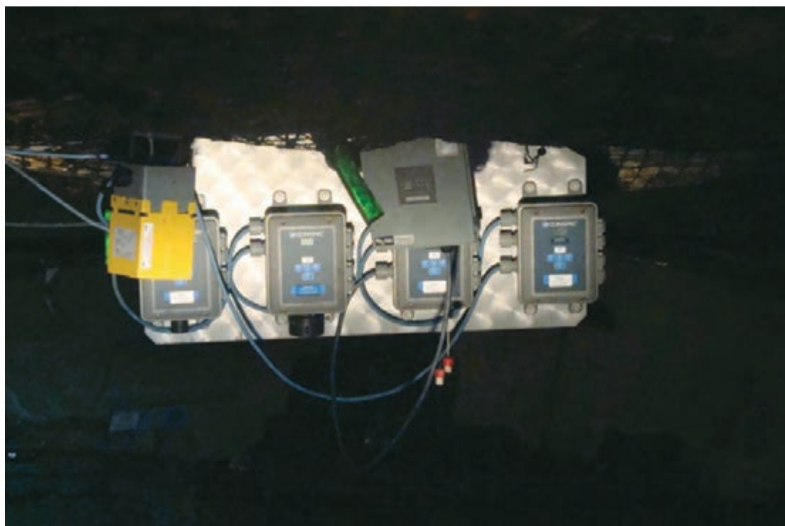
گازسنج‌های دائمی در سینه کار معدن
