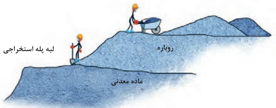
نحوه برداشت روباره در معادن روباز
