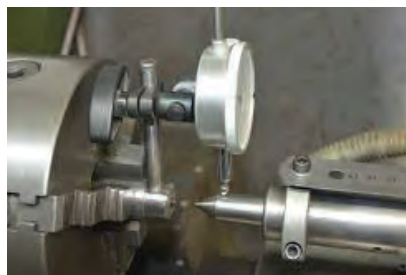
شکل ۳۰- اندازه‌گیری انحراف مرغک
