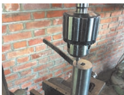
شکل ۲۳ - مته مرغک زنی به وسیله ماشین مته ستونی
