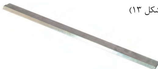
شکل ۱۳- پیچ و گوه محور عرضی
