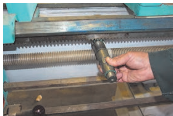
شکل ۱۵- درگیری چرخ دنده با دنده شانه‌ای
