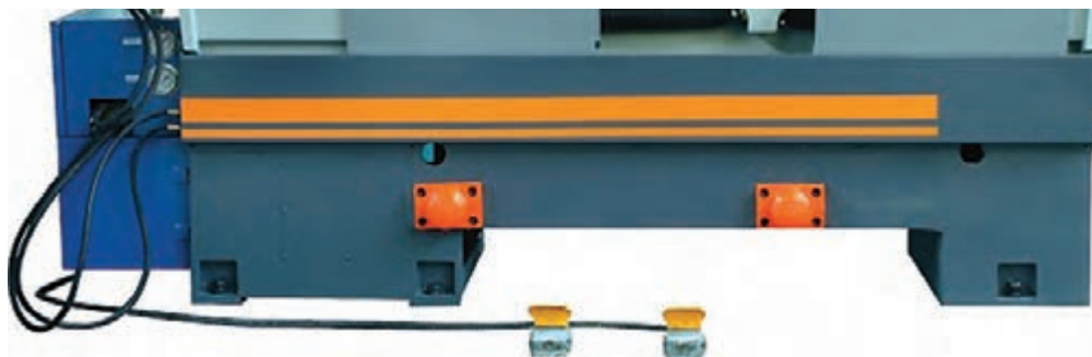
شکل ۵- مجموعه پایه و بدنه دستگاه تراش
