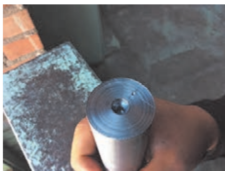
شکل ۲۲ - سنبه نشان زدن پیشانی قطعه کار
