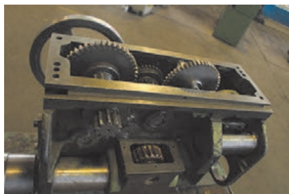
شکل ۱۵- درگیری چرخ دنده با دنده شانه‌ای
