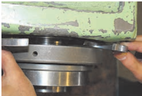
شکل ۴- خارج کردن نیم‌واشرها
