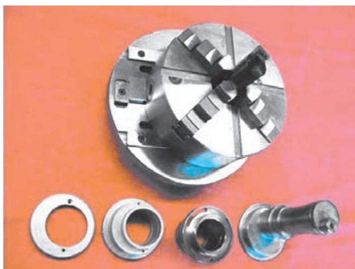
شکل ۱۷- سه‌نظام قابل تنظیم و قطعات تولید شده
