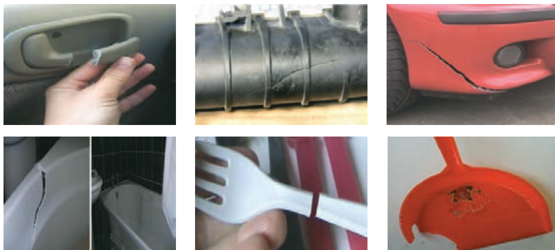
شکل ۲۱- تصاویر قطعات پلاستیکی آسیب دیده
