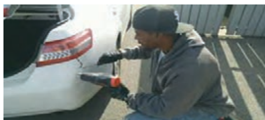
شکل ۲۲- جوشکاری تعمیری قطعات پلاستیکی
