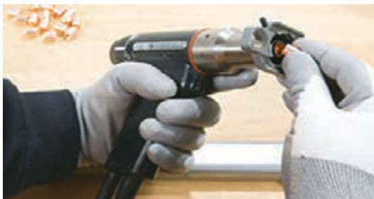
شکل ۲۰- قرار دادن محافظ سرامیکی
