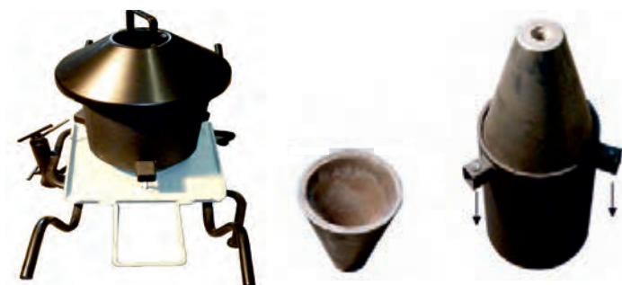
شکل ۶- بوته نگهدارنده مذاب
