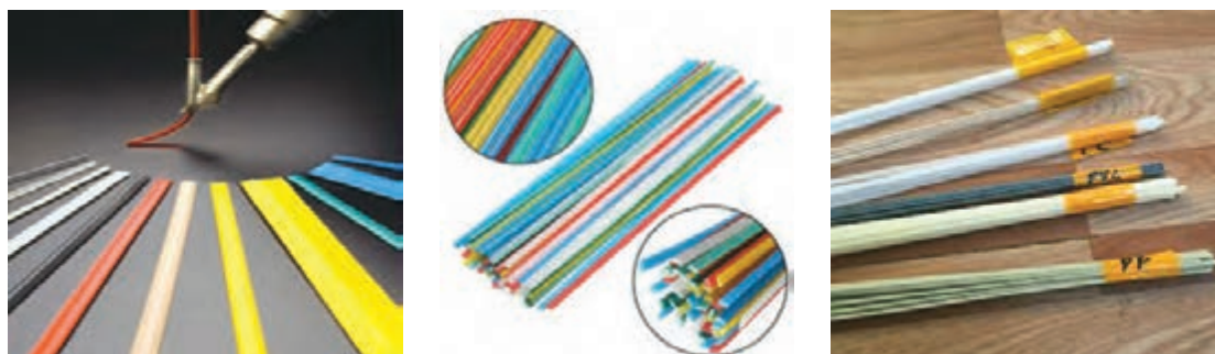
شکل ۱۳- انواع مفتول‌های پلاستیکی جوشکاری
