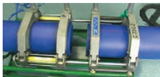
شکل ۱۷- جوشکاری الکتروفیوژن Electrofusion
