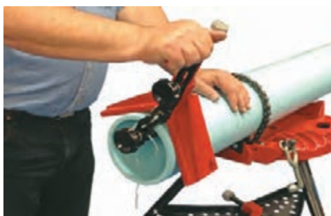
شکل ۲۴- پخ زدن قطعات پلاستیکی برای جوشکاری
