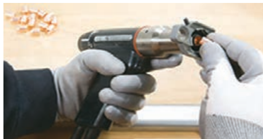
شکل ۱۹- قرار دادن گل میخ در داخل نگهدارنده
