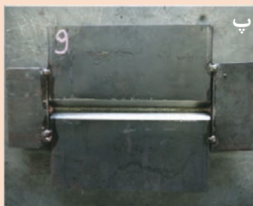
شکل ۱۷- موقعیت دهی و مونتاژ قطعه کار
