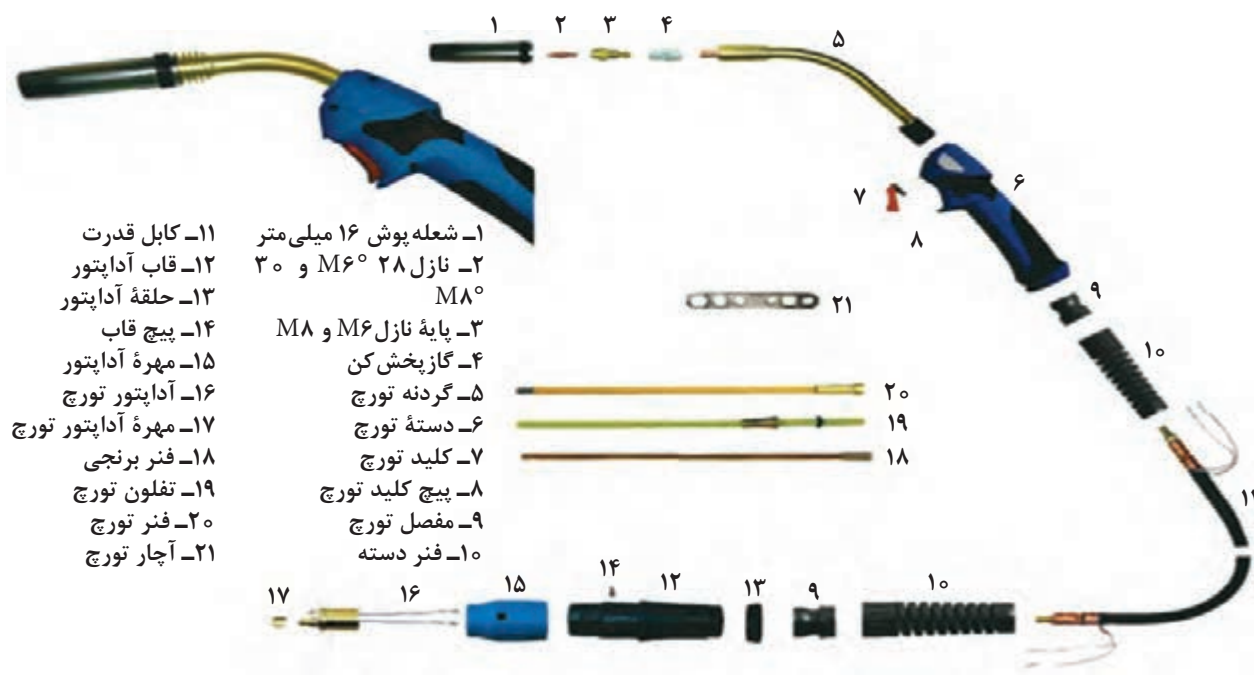
شکل ۷- اجزای تشکیل دهنده تورچ GMAW
