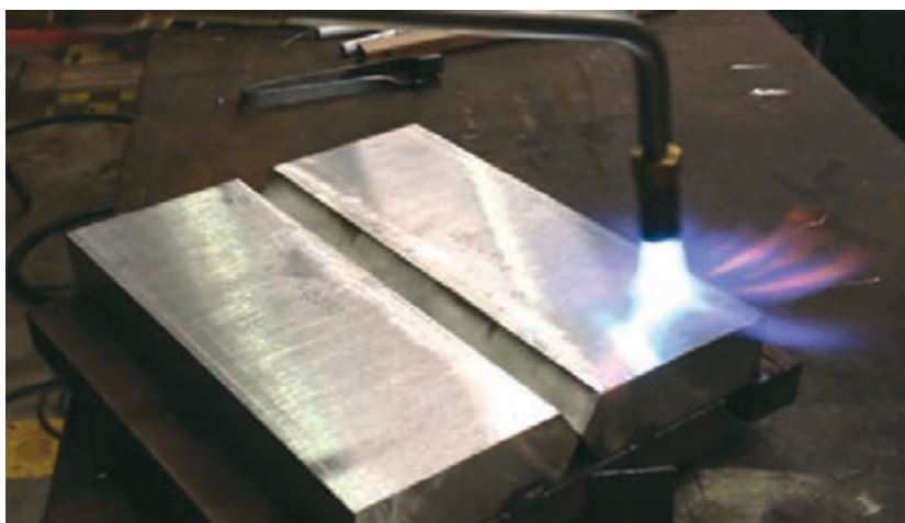
شکل ۵- پیش گرم کردن قطعه ضخیم توسط شعله
