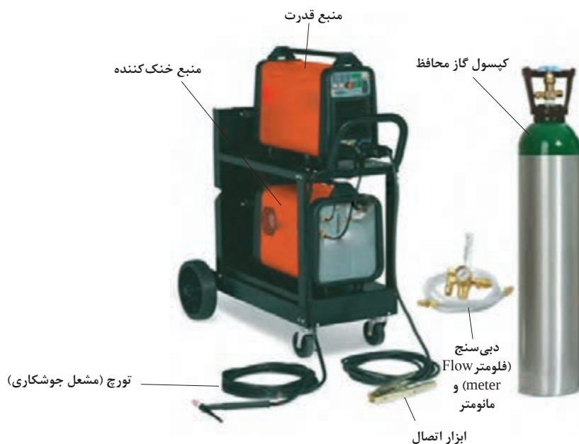
شکل ۲- تجهیزات فرایند GTAW
