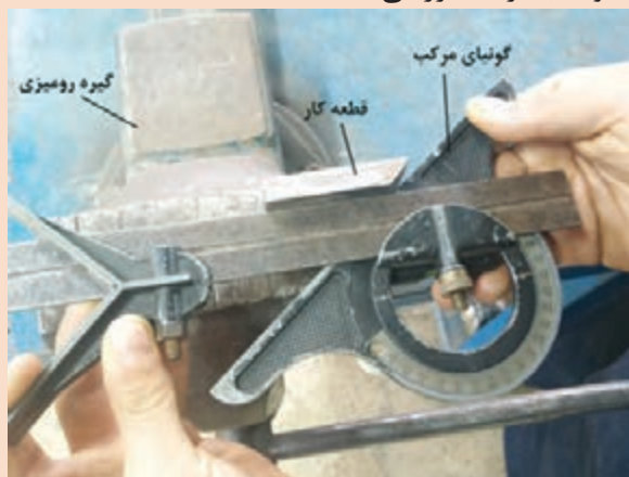
شکل ۲۳- بررسی صحت زاویه با گونیای مرکب
