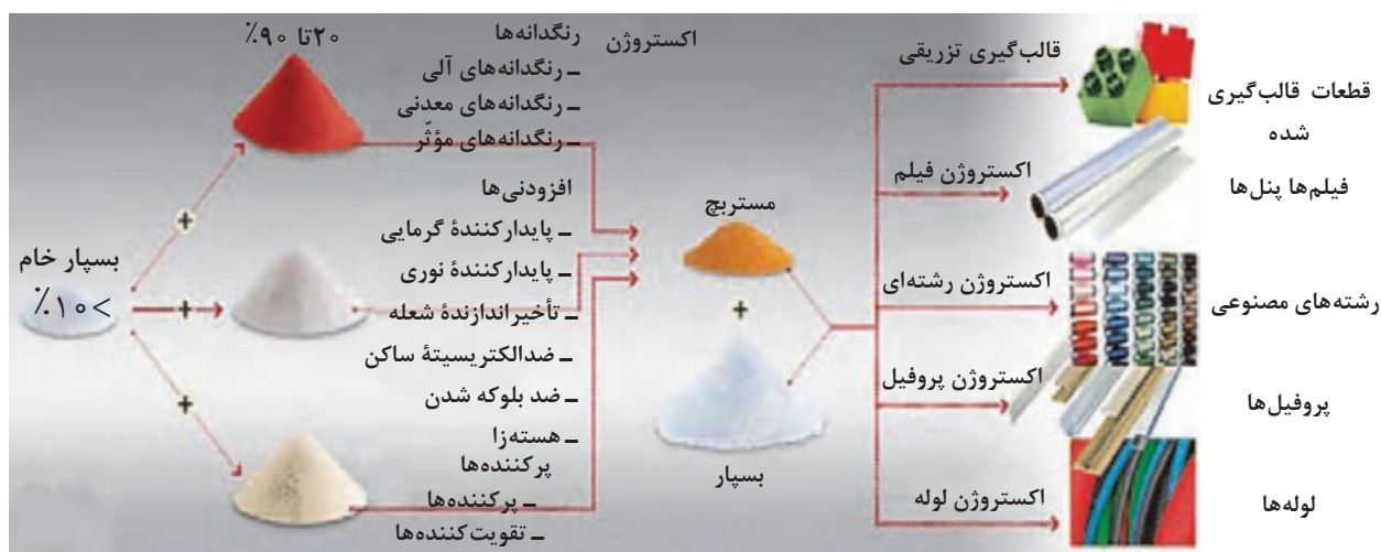
شکل ۶- فرایند تولید مستربج و قطعات بسپاری
