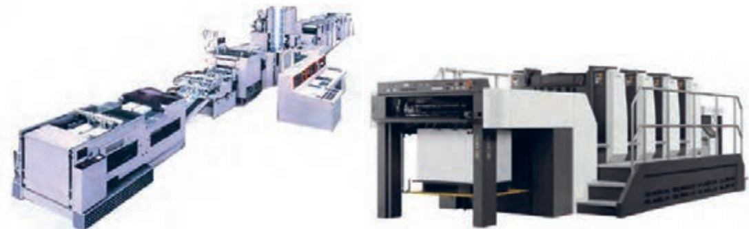
شکل ۳۶- دو نمونه از ماشین‌های چاپ ورقی و رول ویژه بسته‌بندی
