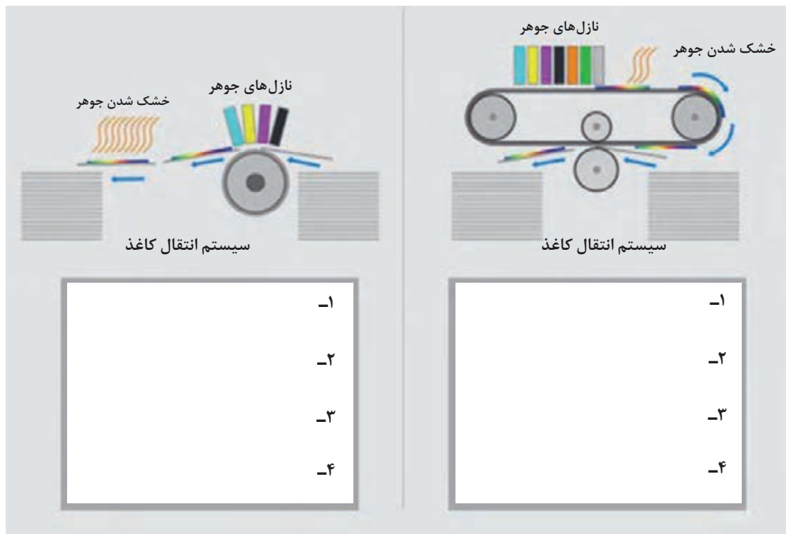
شکل ۱۱- تفاوت‌های کلی میان دو روش چاپ جوهرافشان و چاپ لاندرا
