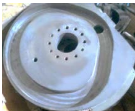
شکل ۱۴-پ) یک لنگ شیاردار در ماشین دایکات
