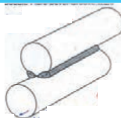
جوش شیاری V شکل لبه برگردان دوطرفه
