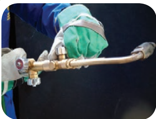
باز کردن شیر محصول استیلن قبل از روشن کردن مشعل
