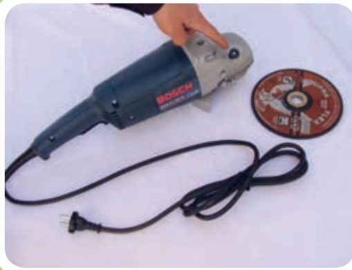
کلید مخصوص قفل کردن محور سنگ
