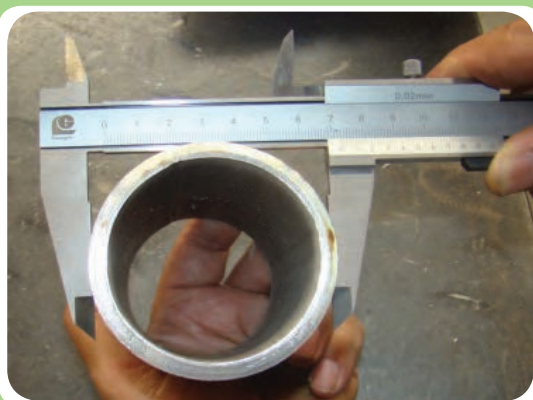
اندازه‌گیری قطر خارجی لوله توسط کولیس
