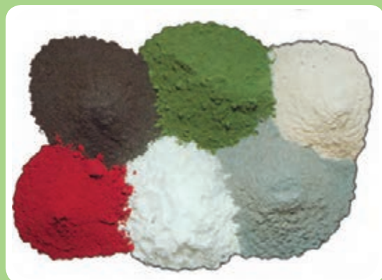
مواد پودری تشکیل دهنده روپوش الکترود
