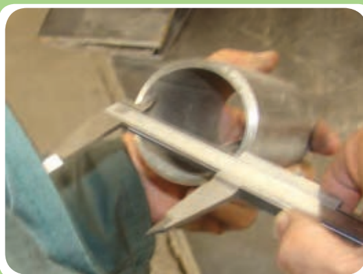
اندازه‌گیری قطر داخلی لوله توسط کولیس
