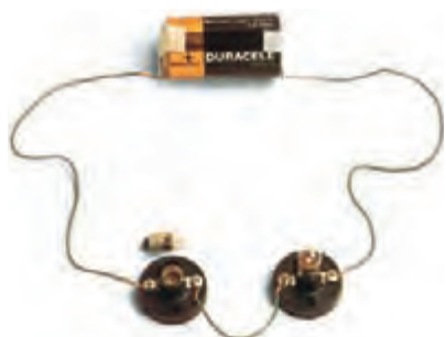
شکل ۲۱-۵- قطع لامپ موجب قطع شدن مدار سری می‌شود.
