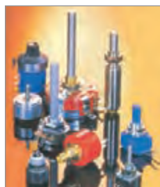
(ب) مقدار مقاومت با چرخاندن ولوم به کمک دست تغییر می‌کند.
