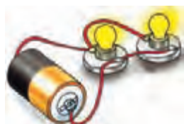
شکل ۵-۶۳- اتصال دو لامپ به صورت موازی
