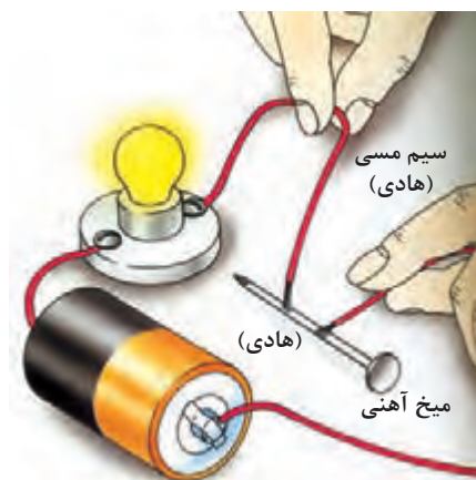
شکل ۲-۳- برقراری جریان الکتریکی در هادی‌ها
