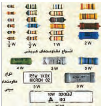
شکل ۶-۱۷- استانداردهای توان در مقاومت‌ها
